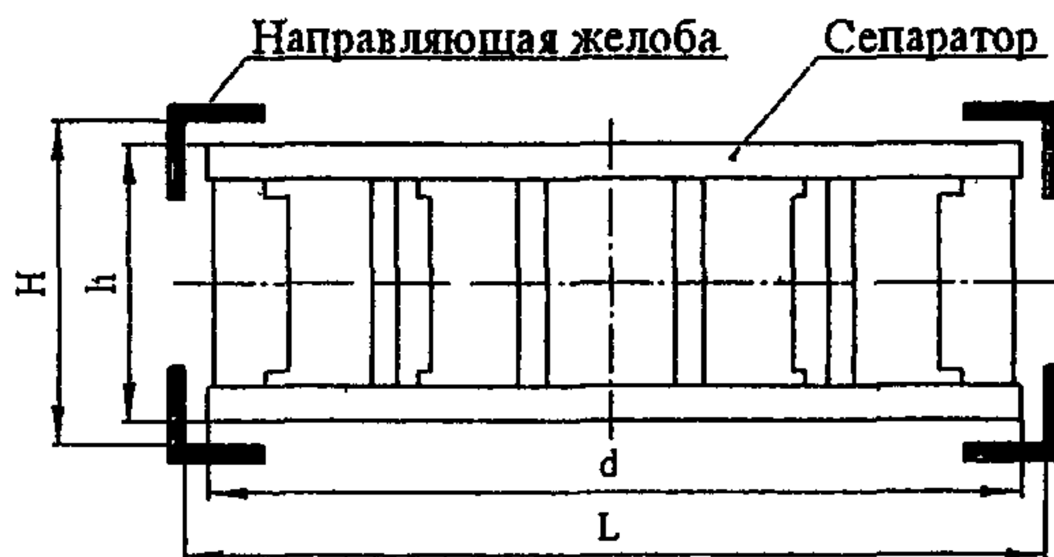
Рисунок Г.1 – Схема желоба для сбрасывания сепараторов L - d = H - h = 10^{+1} мм
