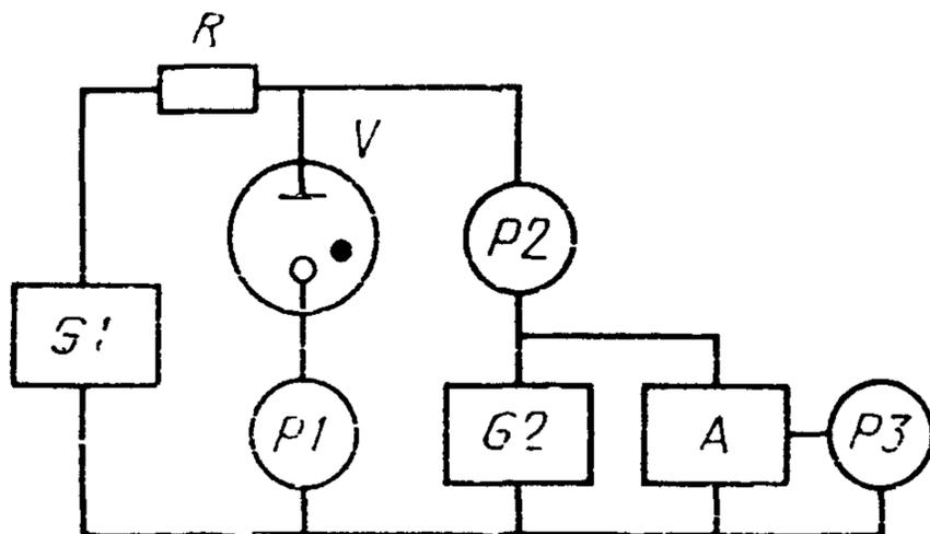
G1—регулируемый источник постоянного напряжения
