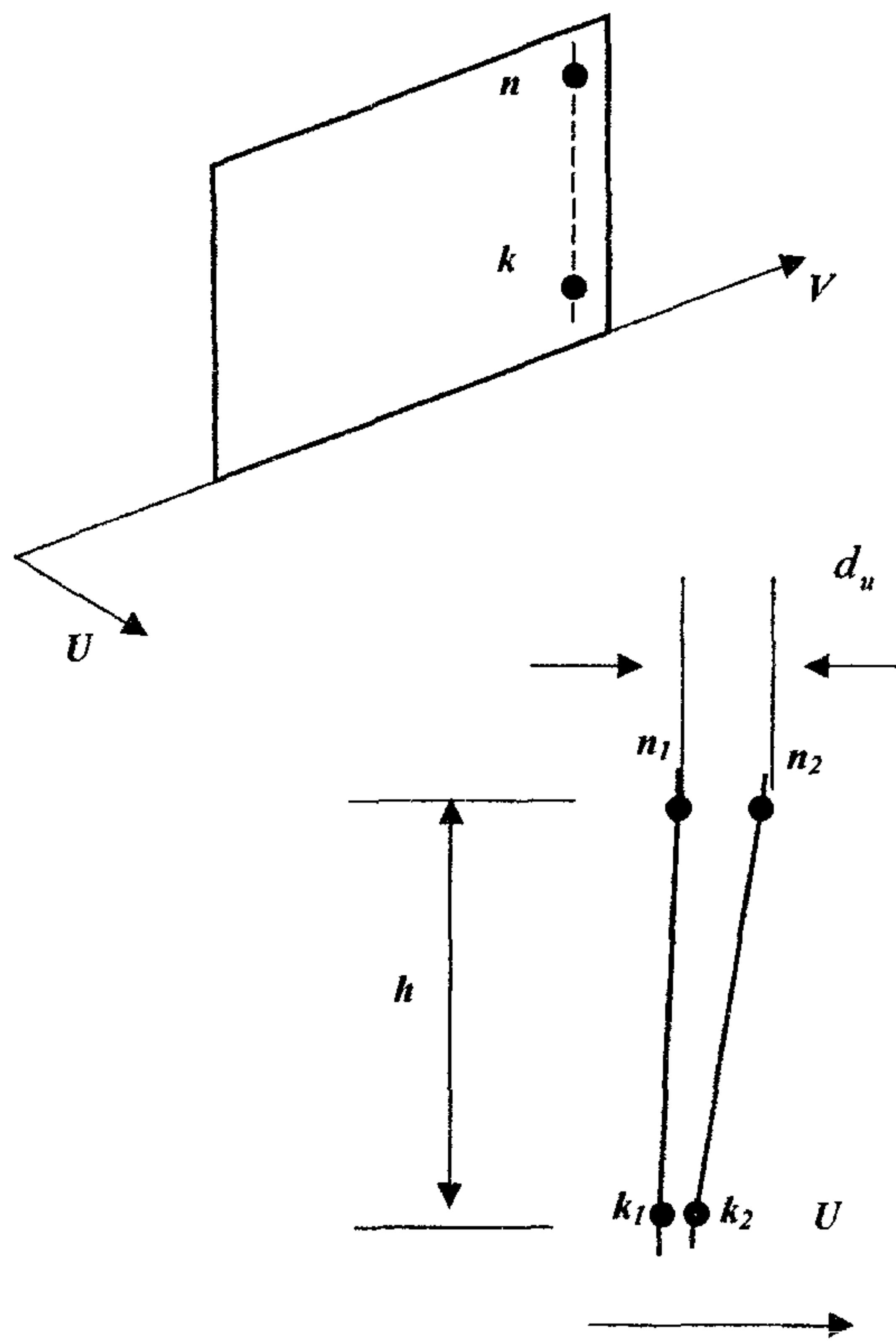
Рис. 1. Условные обозначения для определения невертикальности
