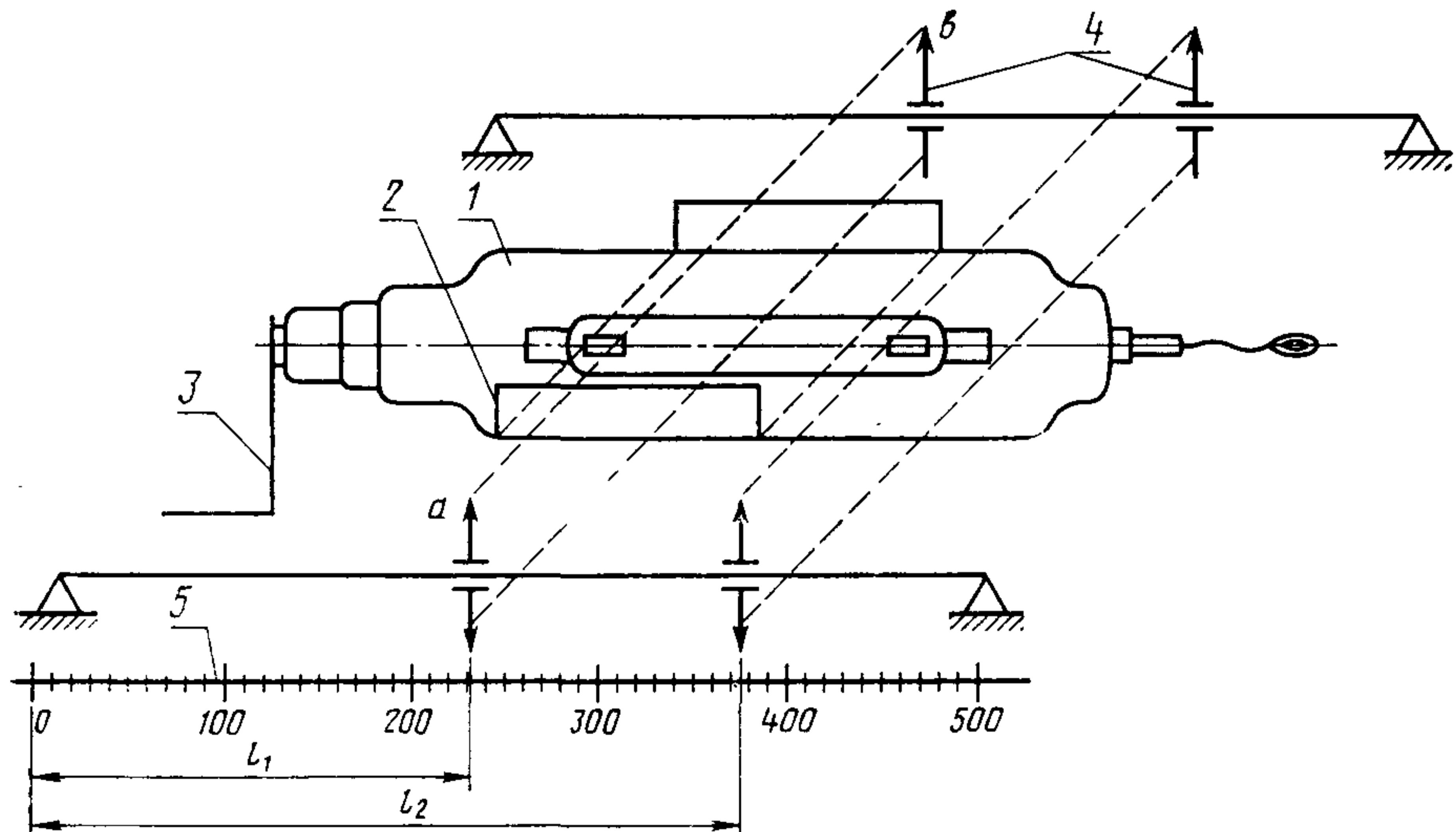
1—лампа; 2—основание; 3—упор; 4—визирное устройство; 5—шкала отсчета
