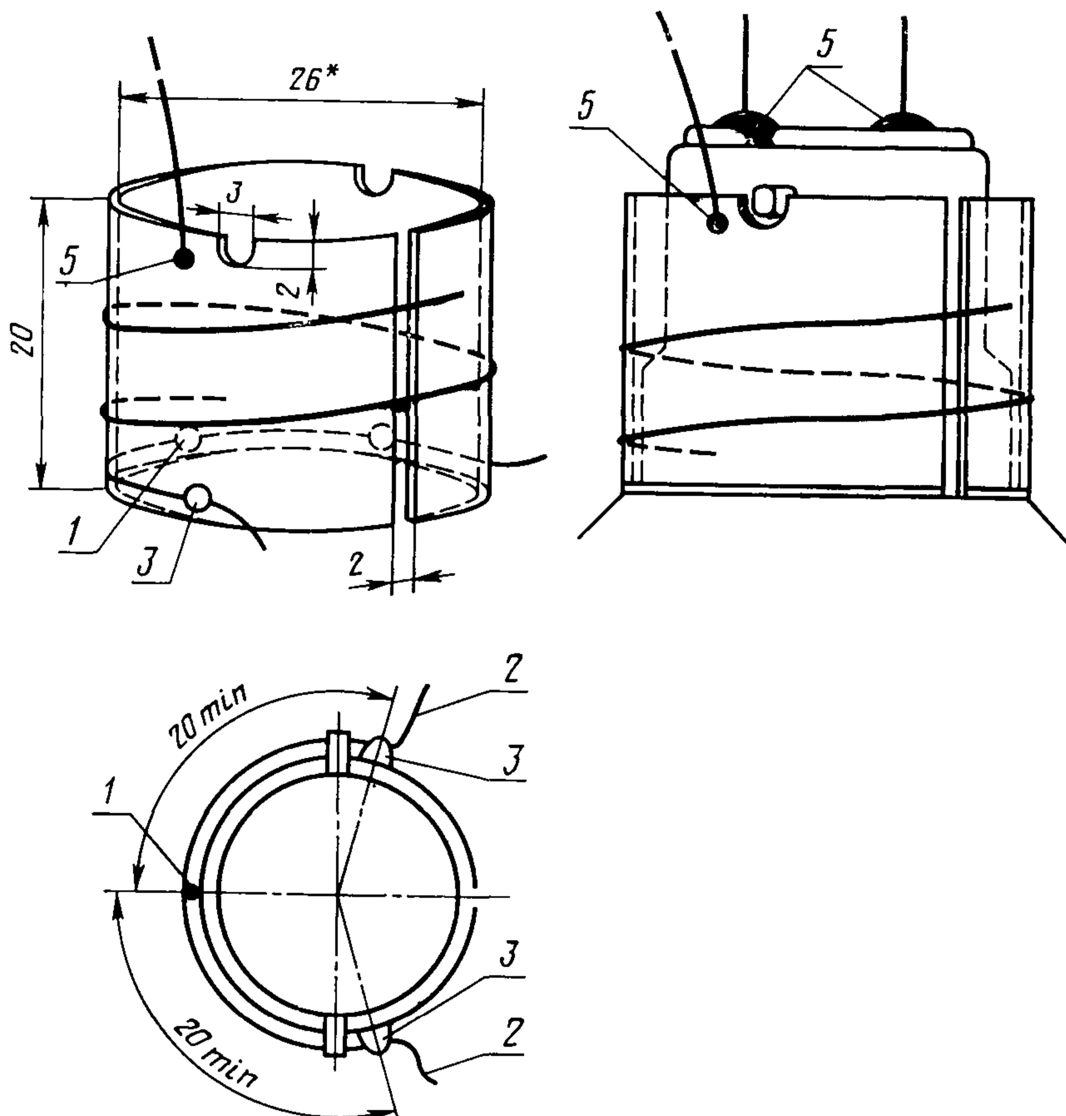
6.2.10. Прочность крепления цоколей к колбе ламп (п. 3.2.10) испытывают при помощи испытательной установки, обеспечивающей плавно нарастающий крутящий момент от нуля до значения, указанного в п. 3.2.10 для конкретного типа цоколя. Установка должна быть снабжена специальным патроном, обеспечивающим соосность цоколя лампы с поворотным устройством.
