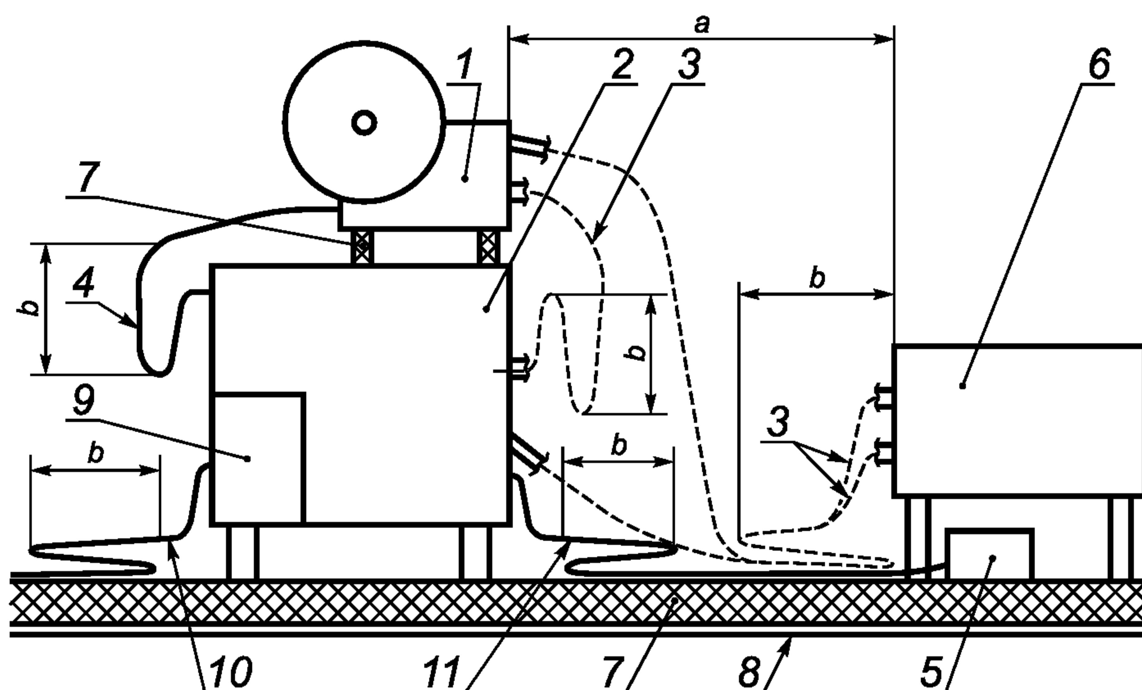
$a = 1 \text{ м}$ ;  $b \leq 0,4 \text{ м}$ ; 1 — устройство подачи сварочного прутка; 2 — источник питания оборудования для сварки; 3 — сварочный провод (уложенный в петли); 4 — соединительный кабель (уложенный в петли); 5 — устройство дистанционного управления; 6 — типовая нагрузка; 7 — изолирующее покрытие; 8 — пластина заземления; 9 — система жидкостного охлаждения; 10 — кабель электропитания; 11 — кабель устройства дистанционного управления (уложенный в петли)
