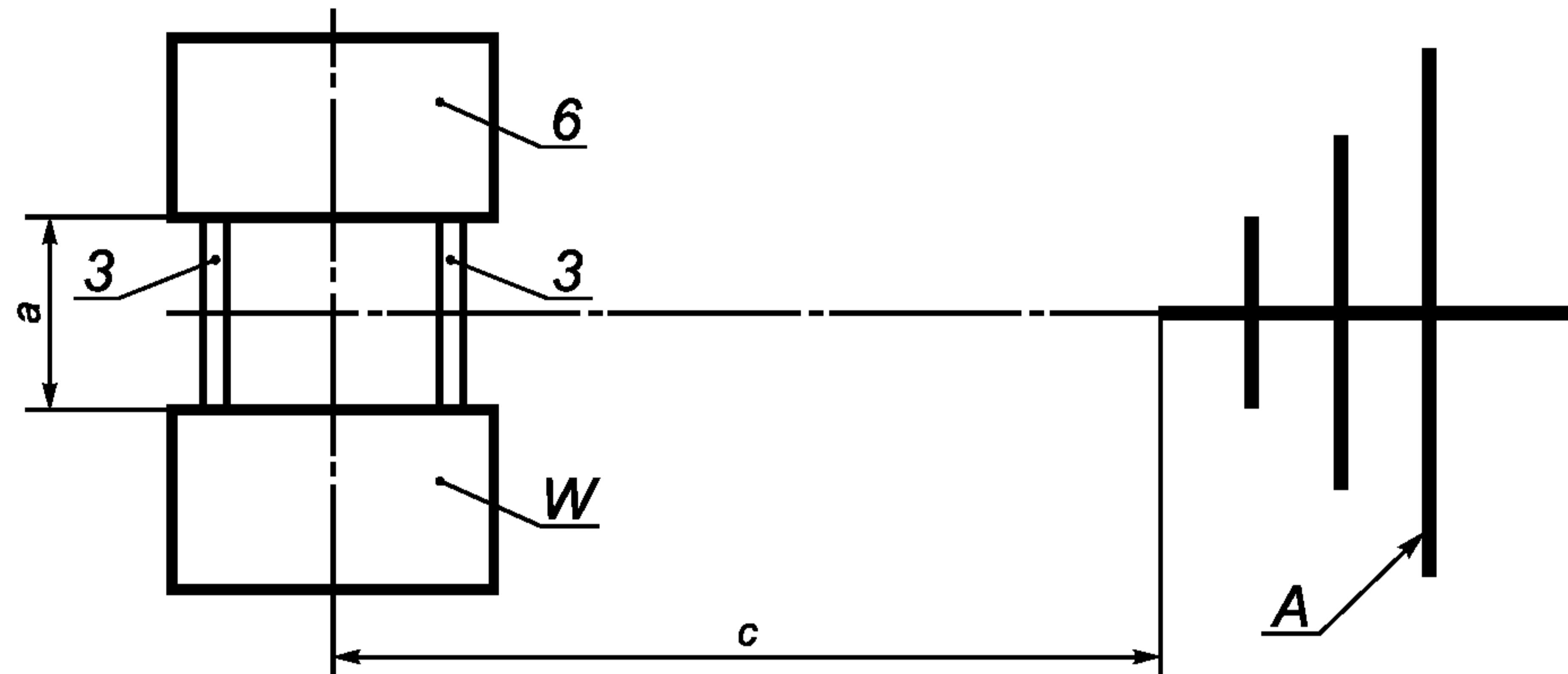
$a = 1 \text{ м}$ ;  $A$  — измерительная антenna;  $W$  — оборудование для дуговой сварки с источником питания; 3 — сварочный провод (уложенный в петли); 6 — типовая нагрузка;  $c$  — расстояние в соответствии с ГОСТ 51317.4.3 и 6.3.3
