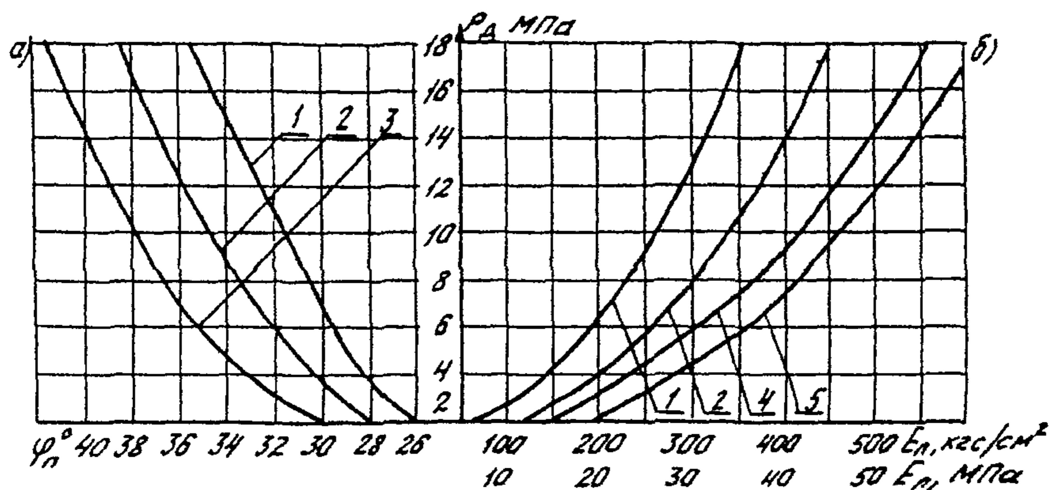
Рис. 2. Графики зависимости условного динамического сопротивления  $P_d$  от угла внутреннего трения  $\phi_n$  для любой глубины (а) и модуля деформации  $E_n$  до глубины 6 м (б) для песчаных грунтов: 1 – пылеватых; 2 – мелких; 3 – крупных и средней крупности; 4 – средней крупности; 5 – крупных
