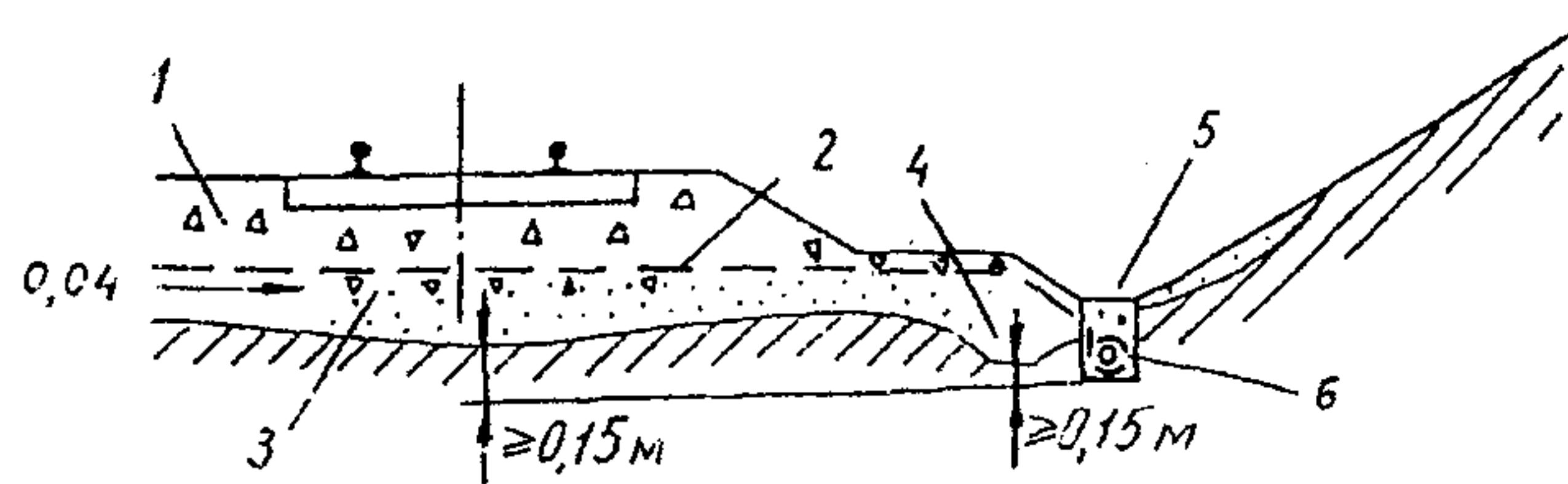
Рис. 7. Схема устройства конструкции покрытия из нетканого материала с подковетным дренажом в выемке: 1-балластный слой очищенный; 2-нетканый материал; 3-балластный слой загрязненный; 4-построочный кювет; 5-существующий кювет; 6-подковетный дренаж
