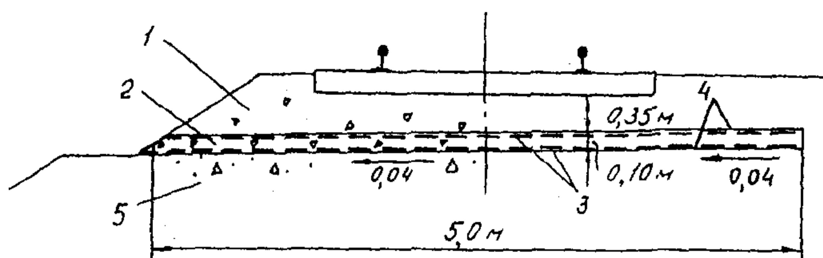
Рис. 4. Схема многослойного покрытия из георешетки (сварной сетки) и нетканого материала иглопробивного производства под балластным слоем:
