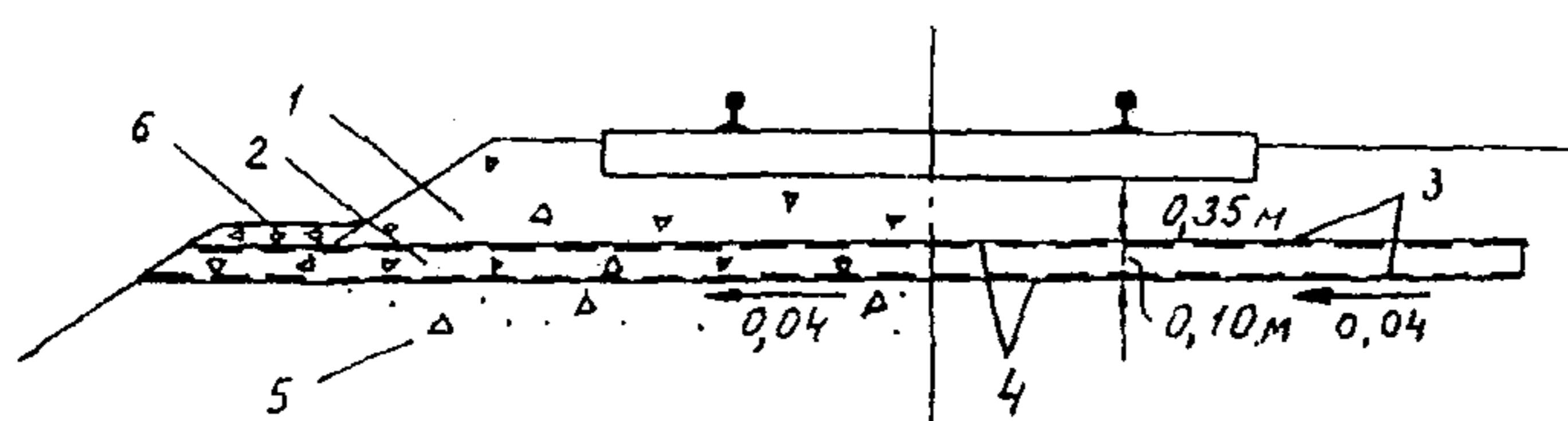
Рис. 5. Схема многослойного покрытия из георешетки (сварной сетки) и нетканого материала иглопробивного производства на всю ширину земляного полотна поверху: 1 - щебень в балластном слое; 2 - щебень между слоями георешетки и нетканого материала; 3 - георешетка; 4 - нетканый материал; 5 - загрязненный балласт; 6 - слой щебня на обочине
