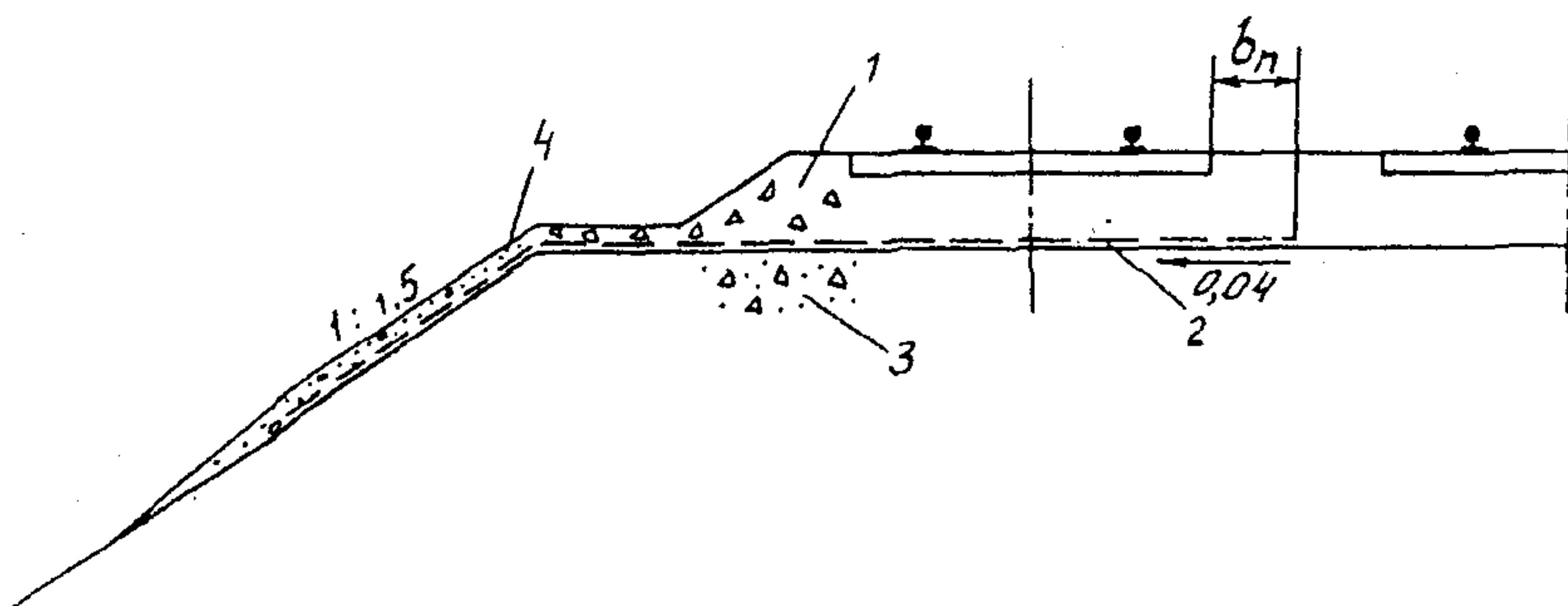
Рис. 8 . Схема устройства конструкции покрытия из нетканого материала на всю ширину земляного полотна поверху и в верхней части откоса:
