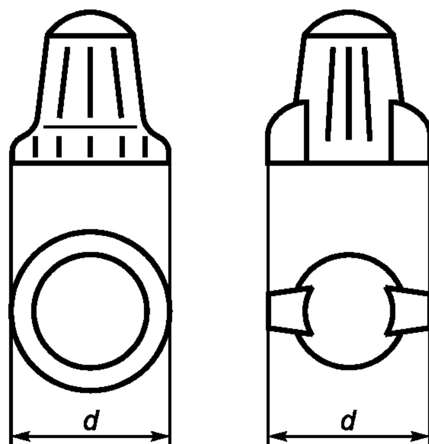
Рисунок 104 — Охватываемые размеры
