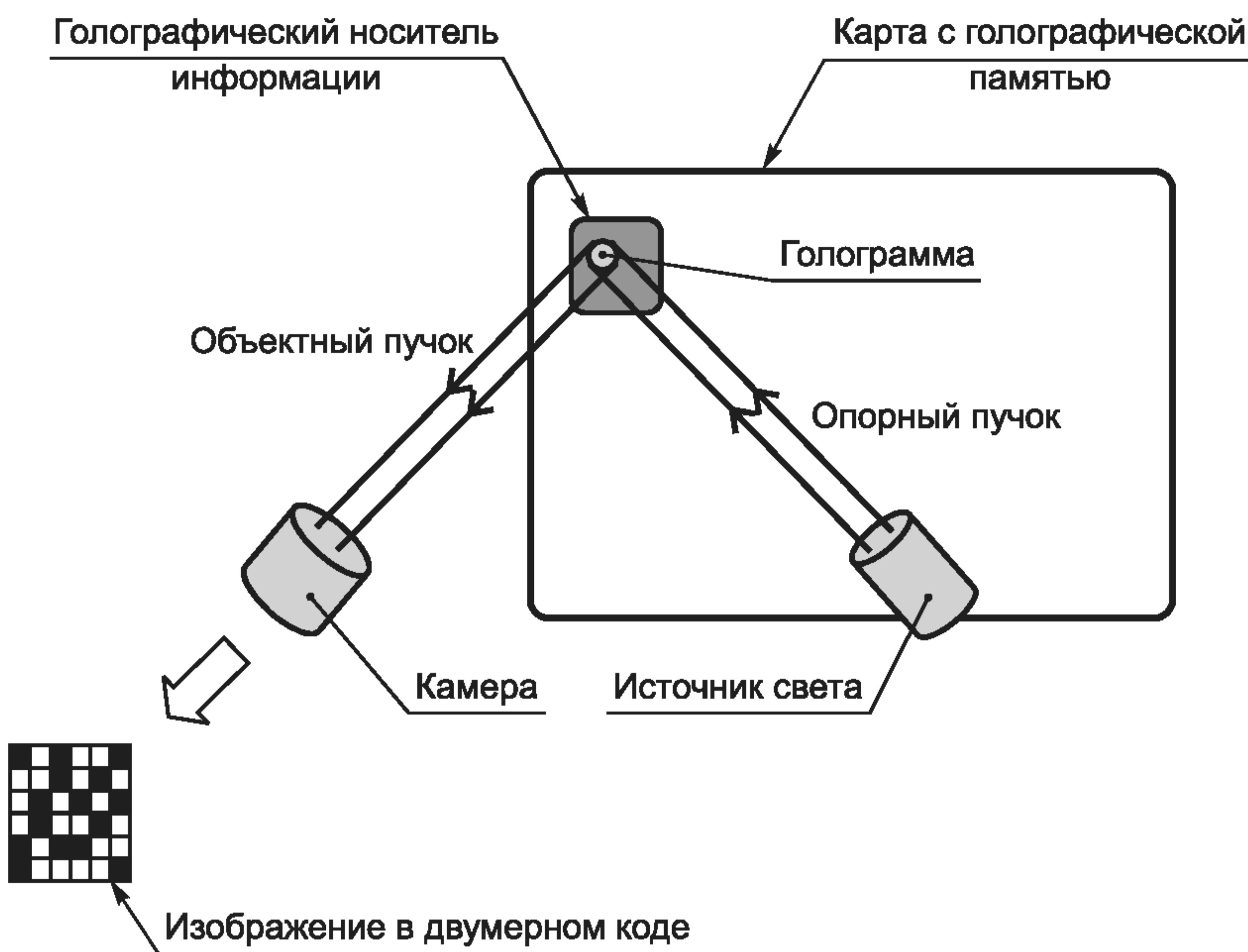
Рисунок А.2 — Схема считывания голограммы
