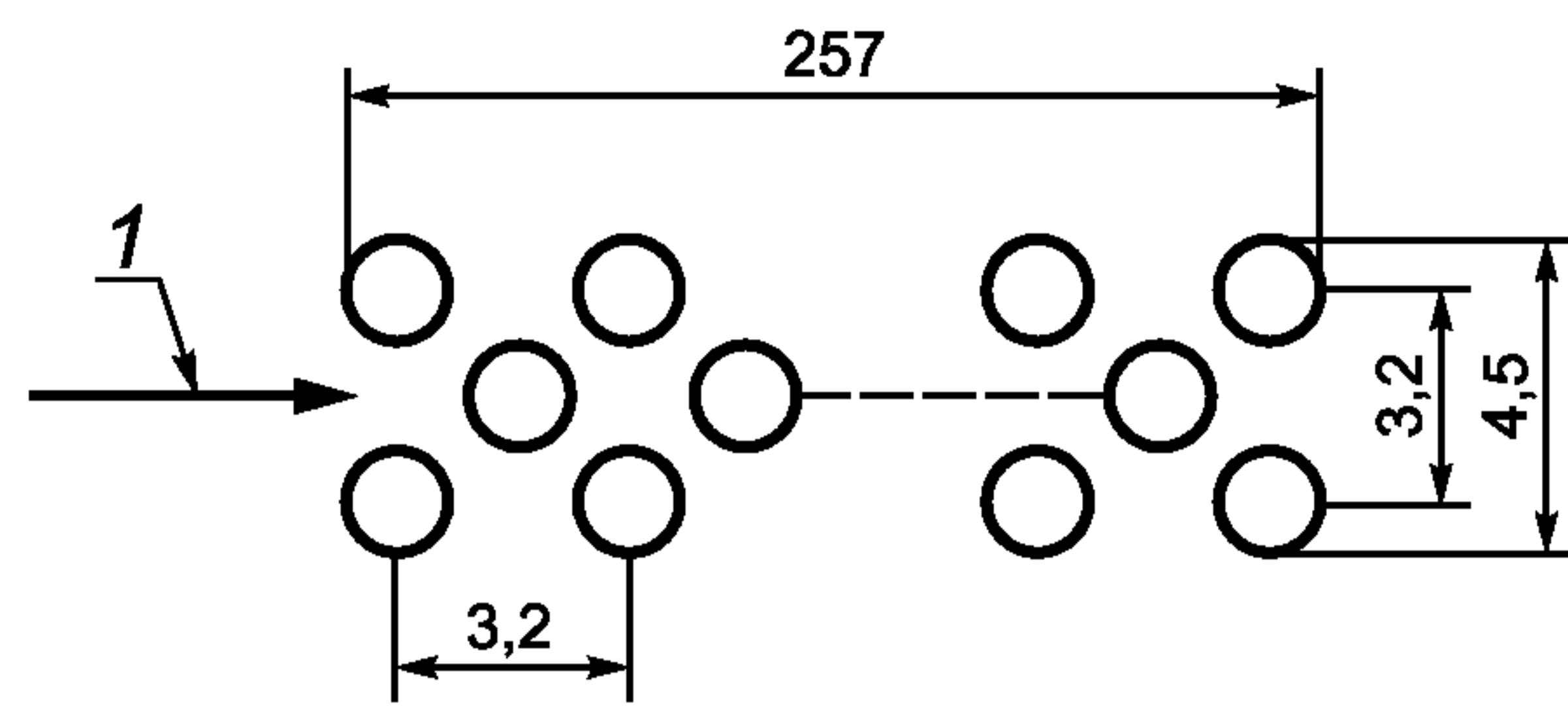
1 — рабочая часть горелки (имеет 242 отверстия диаметром 1,32 мм каждое на расстоянии 3,2 мм друг от друга, расположенные ступенчато в три ряда по 81, 80 и 81 в каждом. Размеры приблизительные)
