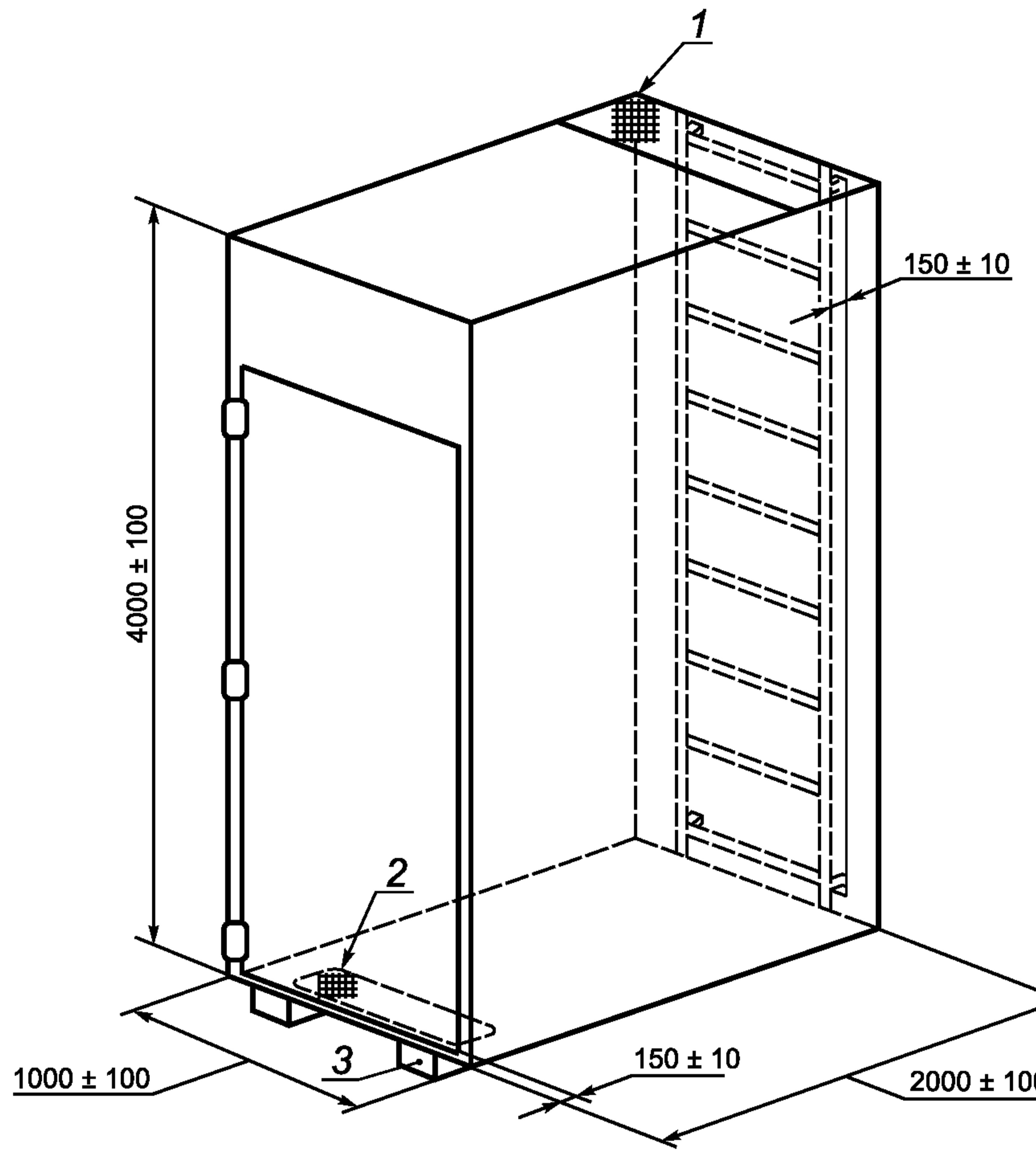
1 — выходное отверстие для дыма размером  $(300 \pm 30) \times (1000 \pm 100)$  мм; 2 — входное отверстие для воздуха размером  $(800 \pm 20) \times (400 \pm 10)$  мм; 3 — приспособление для обеспечения зазора между камерой и уровнем земли
