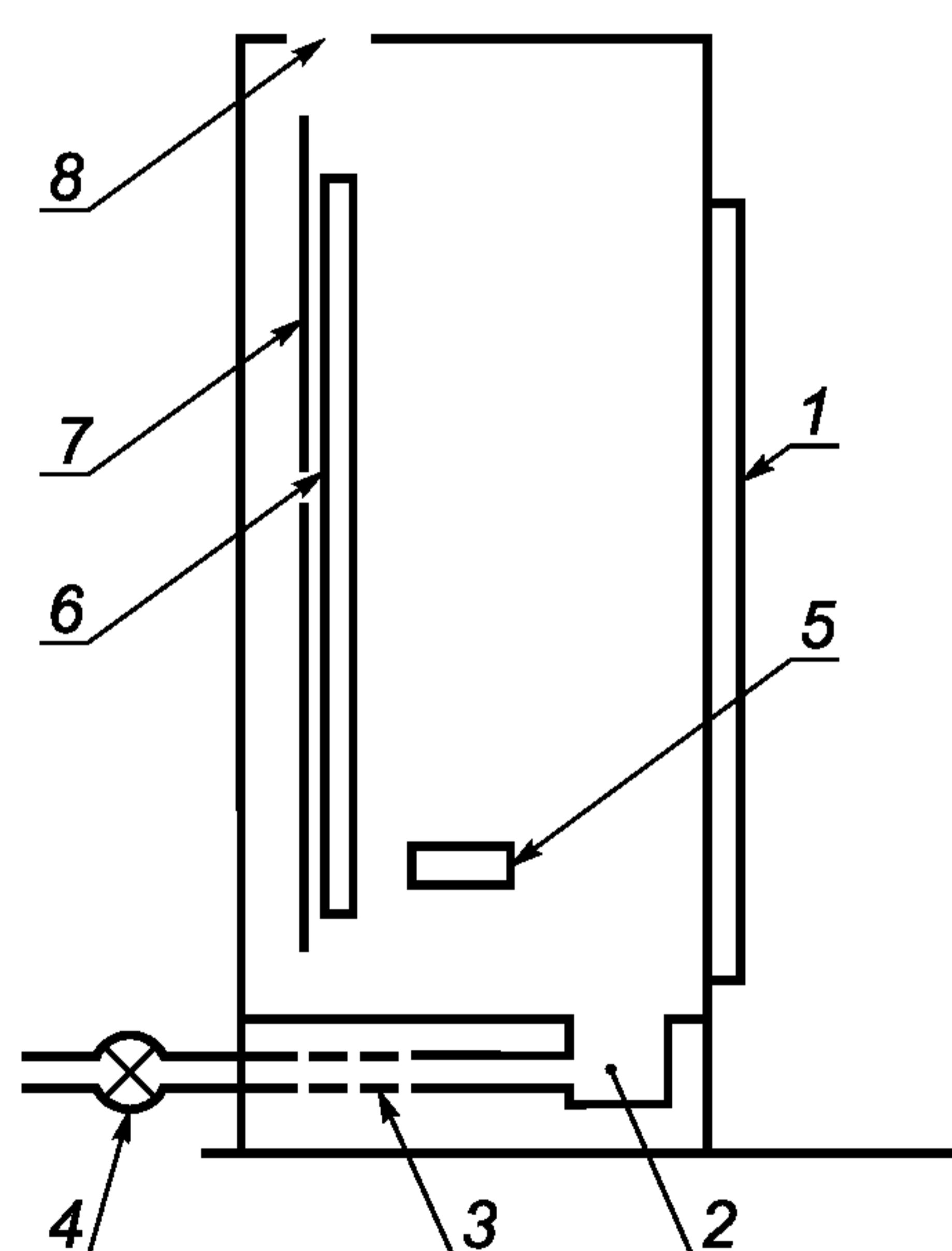
1 — дверь; 2 — приемная коробка воздуха; 3 — воздушный входной канал; 4 — вентилятор (примерное положение); 5 — горелка; 6 — испытуемые кабели; 7 — лестница; 8 — отверстие для выхода дыма
