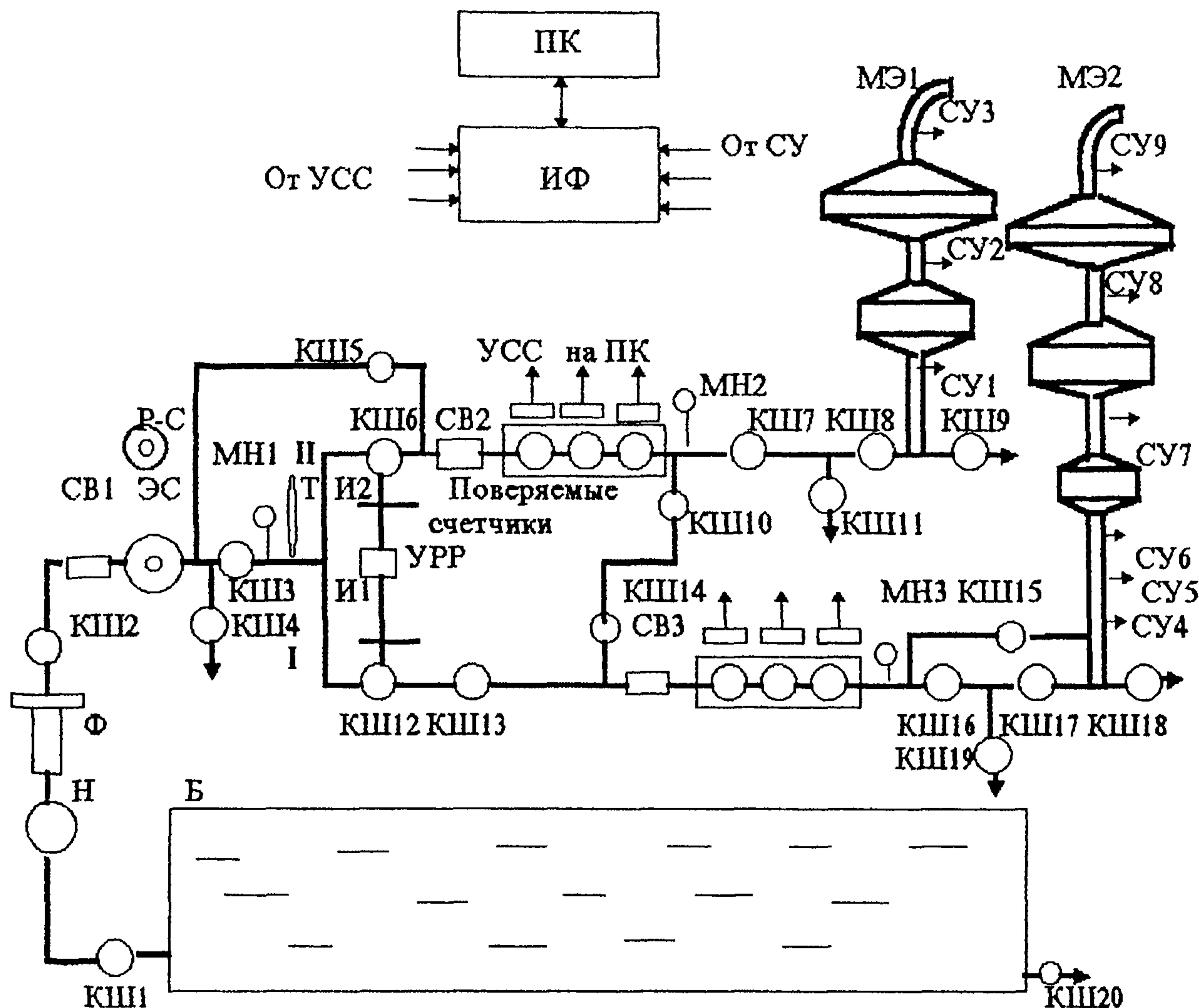
Б-бак; Н-насос; Ф-фильтр; СВ1...СВ3-струевые прямители; ЭС- эталонный расходо-мер - счетчик; Р-С - расходомер-счетчик; МН1...МН3 - манометры; Т-термометр; УРР-устройство регулирования расхода; И1,И2 -индикаторы положения шаровых кранов пульсатора расхода; УСС - узлы съема сигналов; МЭ1, МЭ2 - эталонные мерники; СУ1...СУ9 -сигнализаторы уровня; КШ1...КШ20 - шаровые краны;
