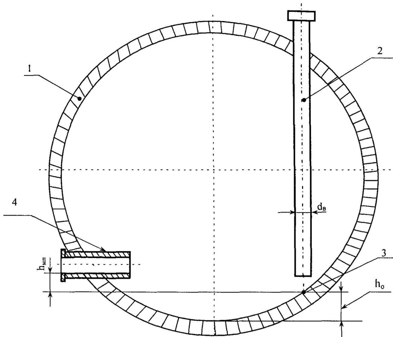
1 – цилиндрическая часть танка; 2 – втулка измерительная; 3 – точка касания образующей танка грузом рулетки (исходная точка); 4 – приемно-раздаточный патрубок;  $h_{мп}$  – высота «мертвой» полости;  $h_0$  – высота исходной точки.
