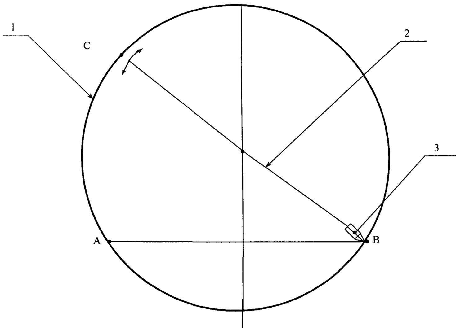
1 – стенка цилиндрической части резервуара; 2 – визирная линия электронной рулетки; 3 – светодальномер на отрезке  $BB'$  (точка  $B'$  на рисунке не показана);  $BC$  – предполагаемый диаметр пояса;
