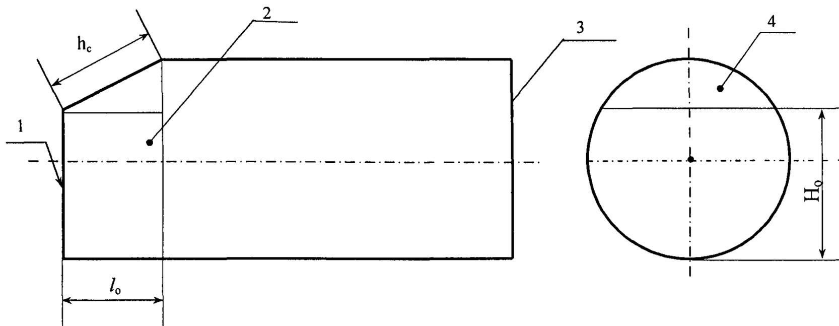
1 – переборка скошенной части танка; 2 – скошенная часть танка; 3 – переборка цилиндрической части танка; 4 – скос;  $h_c$  – высота скоса;  $H_0$  – уровень расположения скоса;  $l_0$  – длина скошенной части танка.
