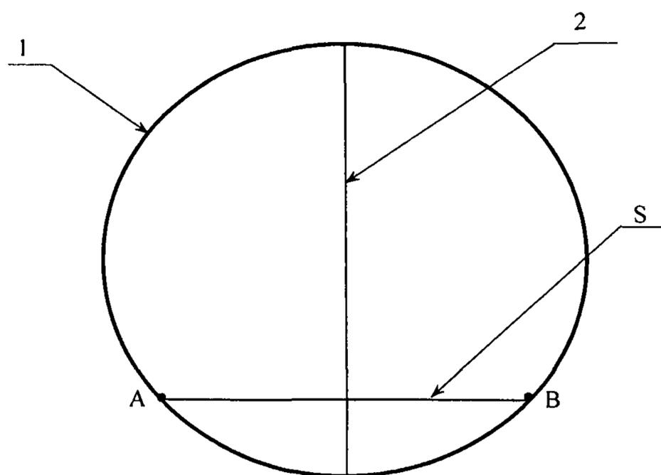
1 – цилиндрическая часть танка; 2 – плоскость симметрии танка;
