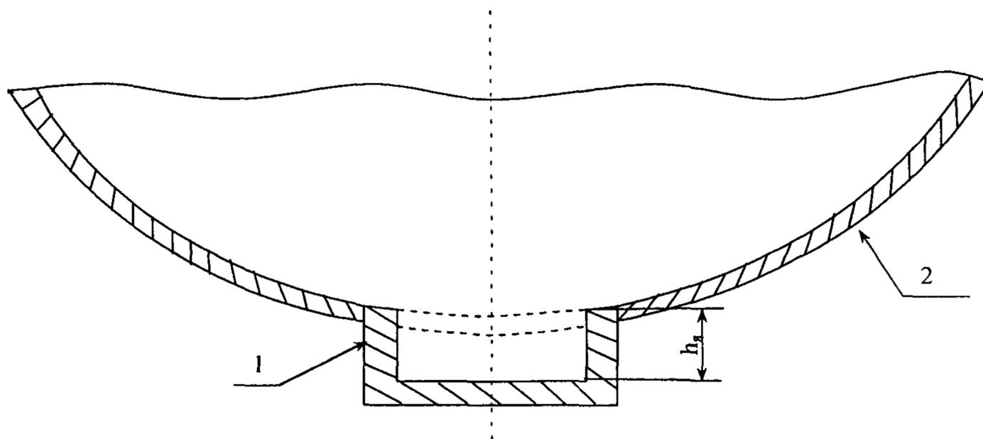
1 – прямок; 2 – цилиндрическая часть танка;  $h_y$  – высота прямка.
