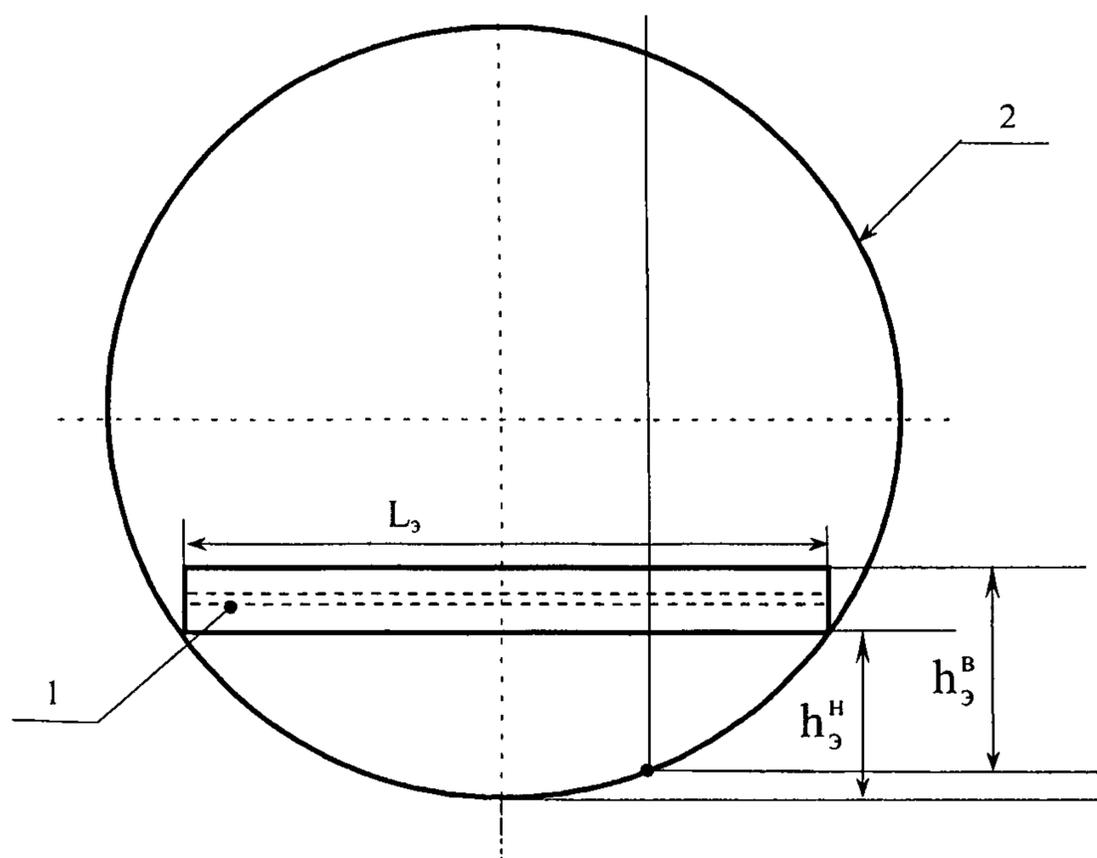
1 – тавровый профиль; 2 – переборка танка;  $h_3^H$  – нижнее положение профиля;  $h_3^B$  – верхнее положение профиля;  $L_3$  – длина профиля.
