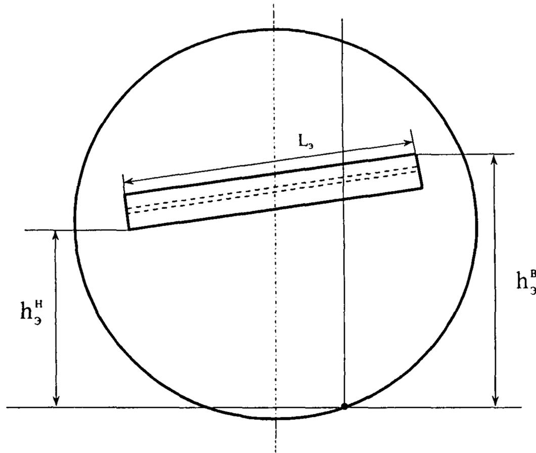
Рисунок А.12- Схема расположения наклонного таврового профиля.
