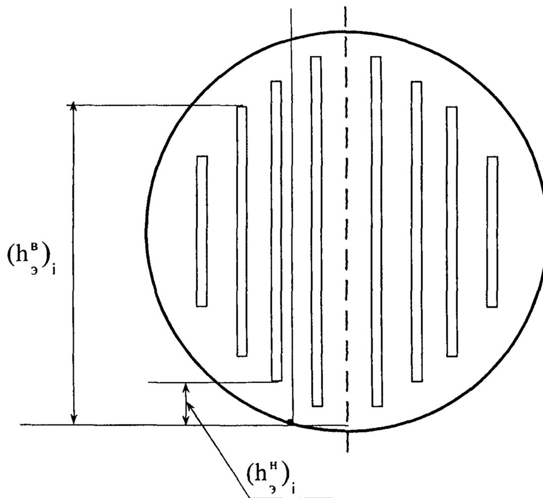
$(h_3^H)_i$  – нижнее положение  $i$ -го уголкового (полособульбового) профиля;
