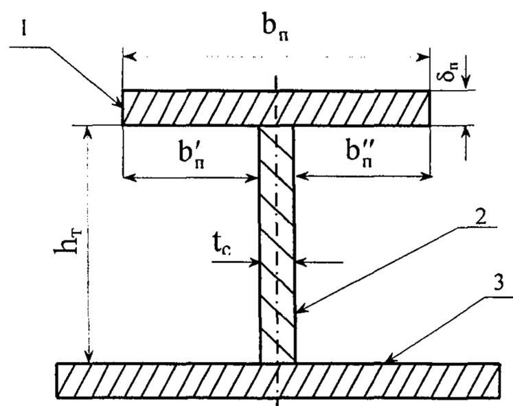
1- полка профиля; 2-стенка профиля; 3- присоединенный поясok обшивки;  $b_п, \delta_п$  – длина и толщина полки;  $h_т, t_с$  – высота и толщина стенки профиля;  $b'_п, b''_п$ , – расстояние от торцов полки до стенки профиля.
