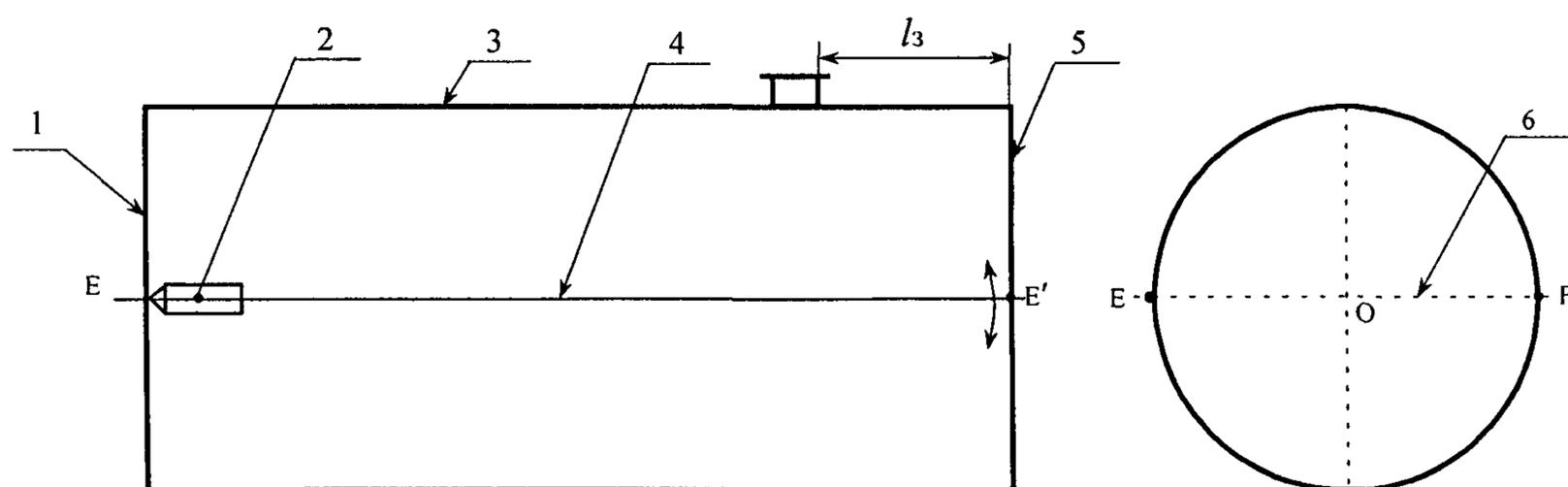
1,5 – переборки танка; 2 – светодальномер; 3 – цилиндрическая часть танка; 4 – длина танка  $L$ ; 6 – хорда (диаметр);  $O$  – центр переборки танка;  $E, F$  – образующие танка;  $l_3$  – координата точки измерений базовой высоты и уровня жидкости.
