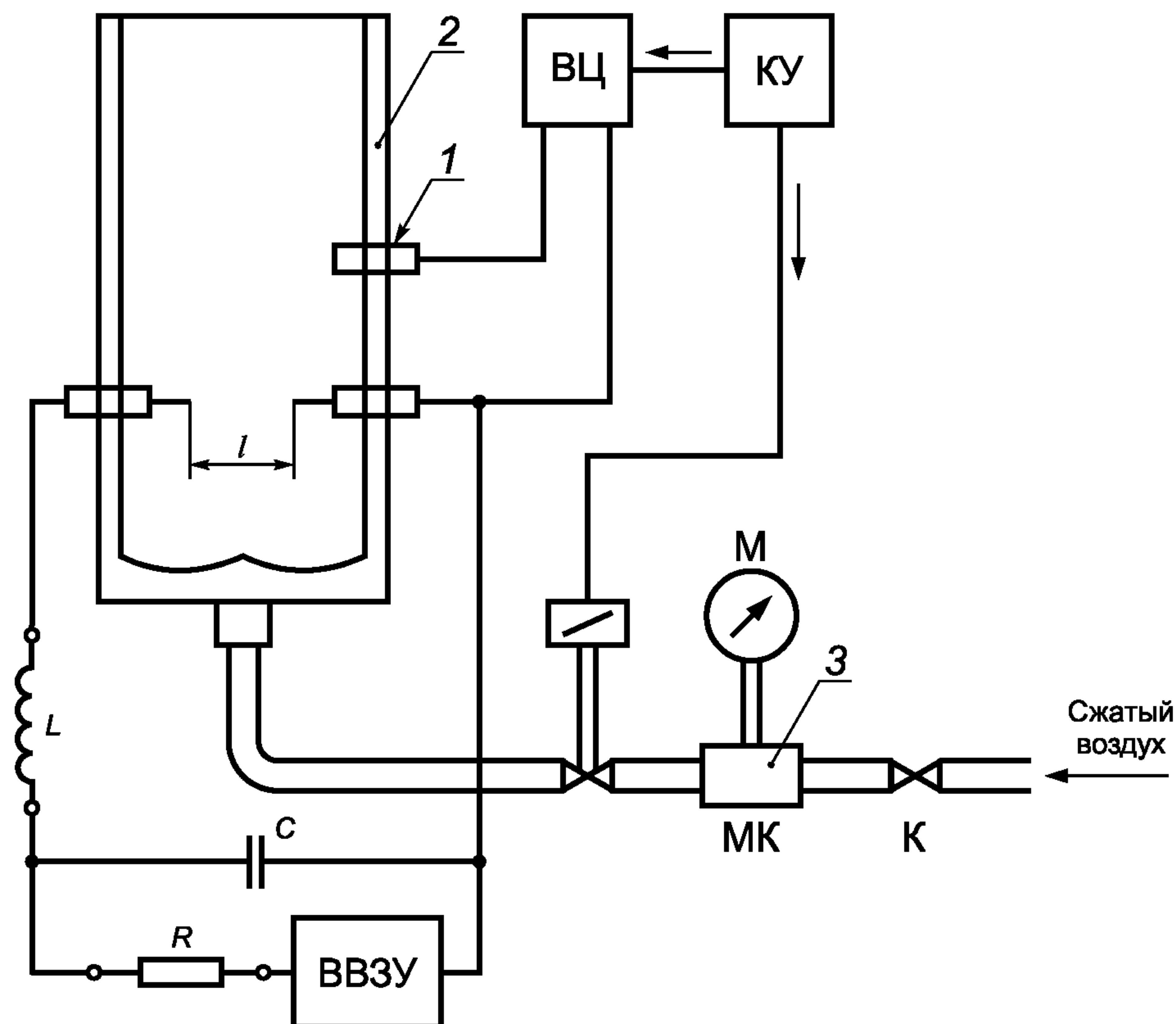
ВЦ — вспомогательная цепь; С — испытательный конденсатор; КУ — контрольное устройство; ВВЗУ — зарядное устройство; М — манометр; Л — индуктивность; МК — магнитный клапан; Р — зарядное сопротивление; К — запорный клапан;  $l$  — основной межэлектродный промежуток; 1 — вспомогательный электрод; 2 — трубка Хартмана; 3 — резервуар сжатого воздуха
