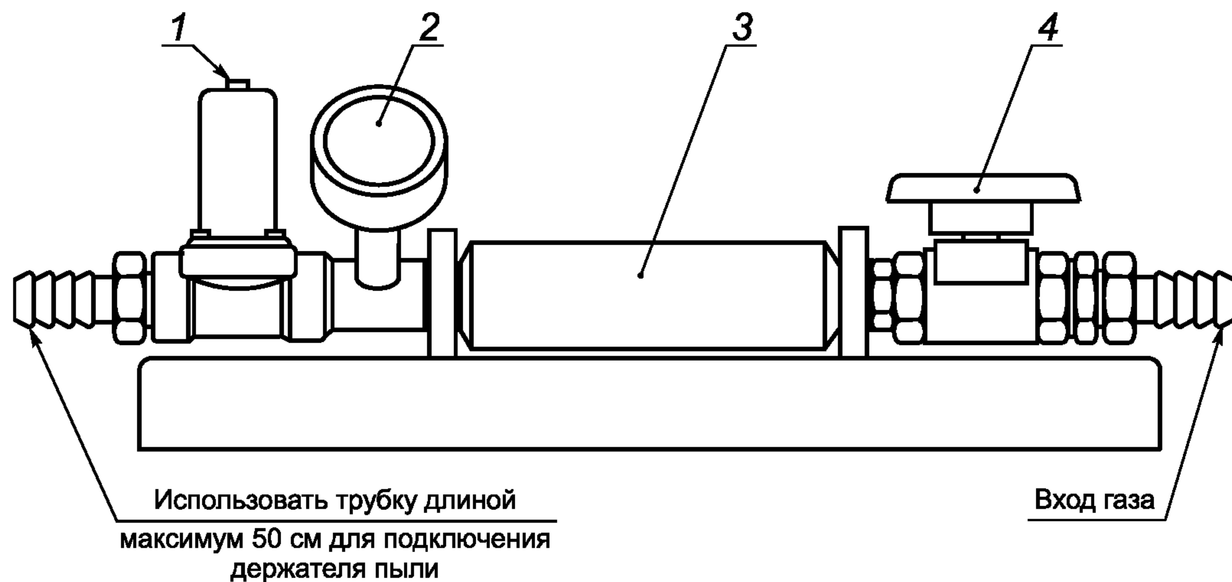
1 — электромагнитный клапан диаметром 10 мм; 2 — манометр ценой деления до 0,02 бар;
