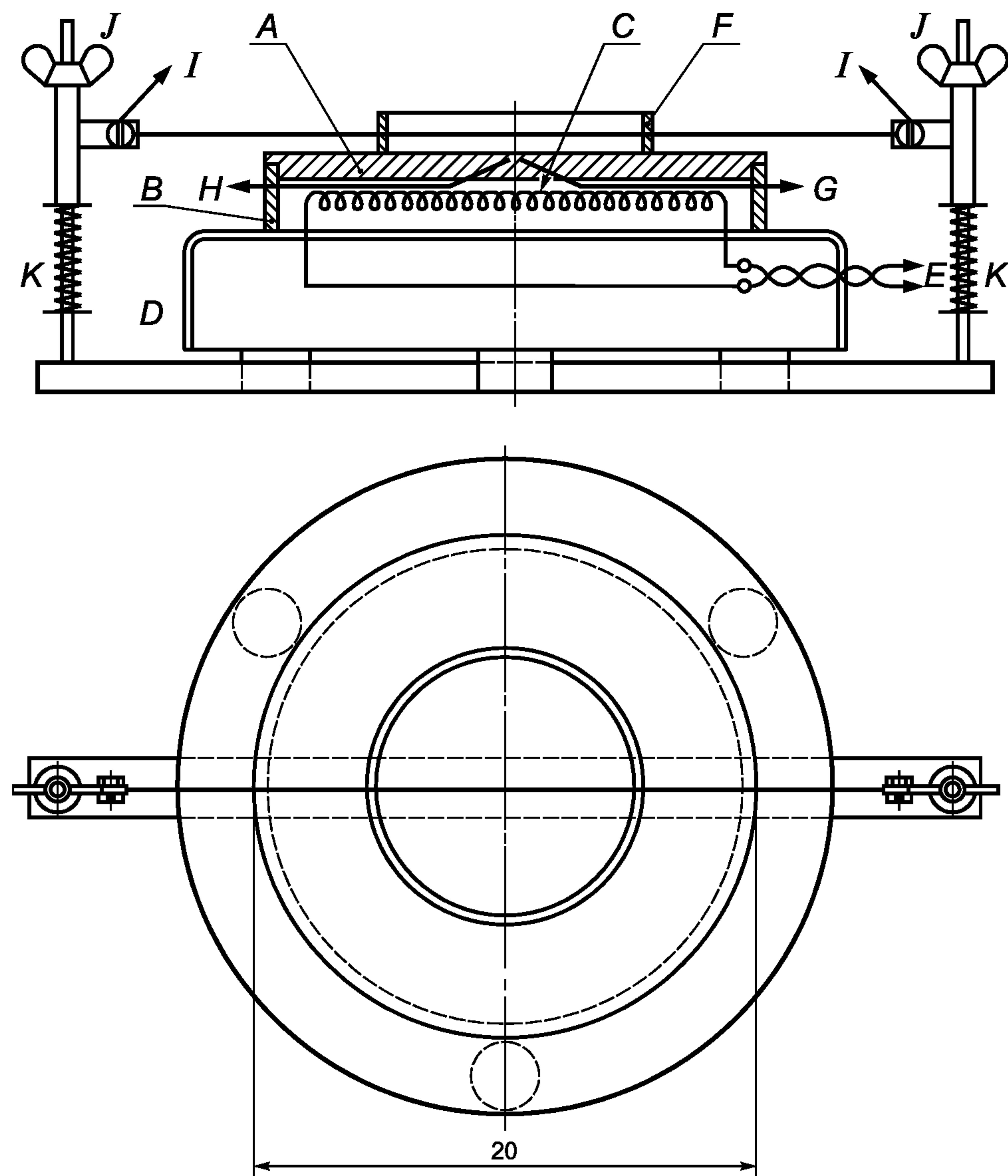
*A — нагреваемая пластина; B — «юбка»; C — нагреватель; D — основание нагревателя; E — соединение нагревателя с источником питания и контроллером; F — кольцо для слоя пыли; G — соединение контрольной термопары пластины с контроллером; H — соединение регистрирующей термопары пластины с прибором; I — соединение термопары, регистрирующей температуру в слое пыли, с прибором; J — винт регулировки высоты термопары; K — спиральная пружина*
