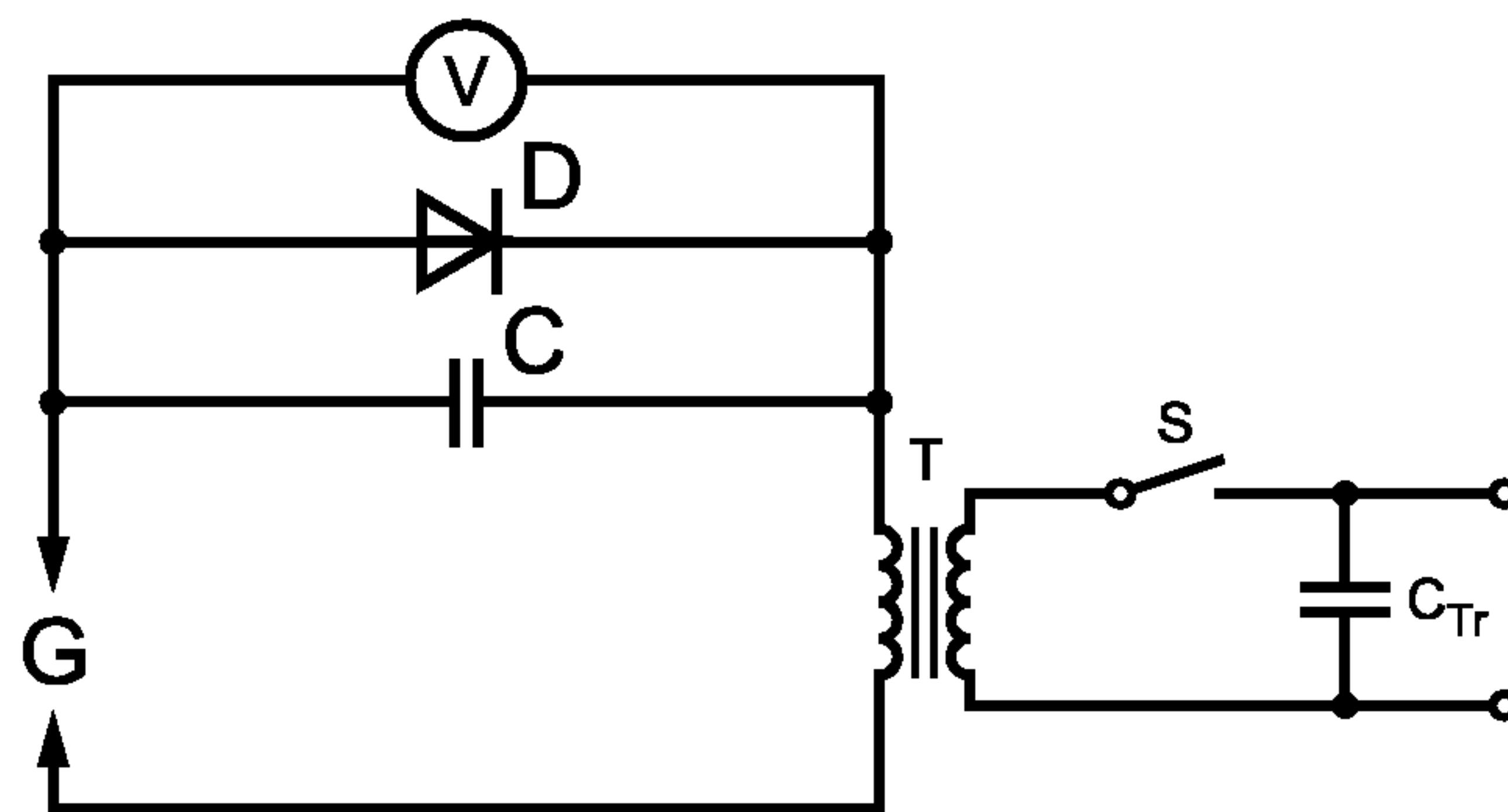
С — основной конденсатор; C<sub>Tr</sub> — конденсатор в цепи триггера; D — диод; S — выключатель; T — трансформатор;
