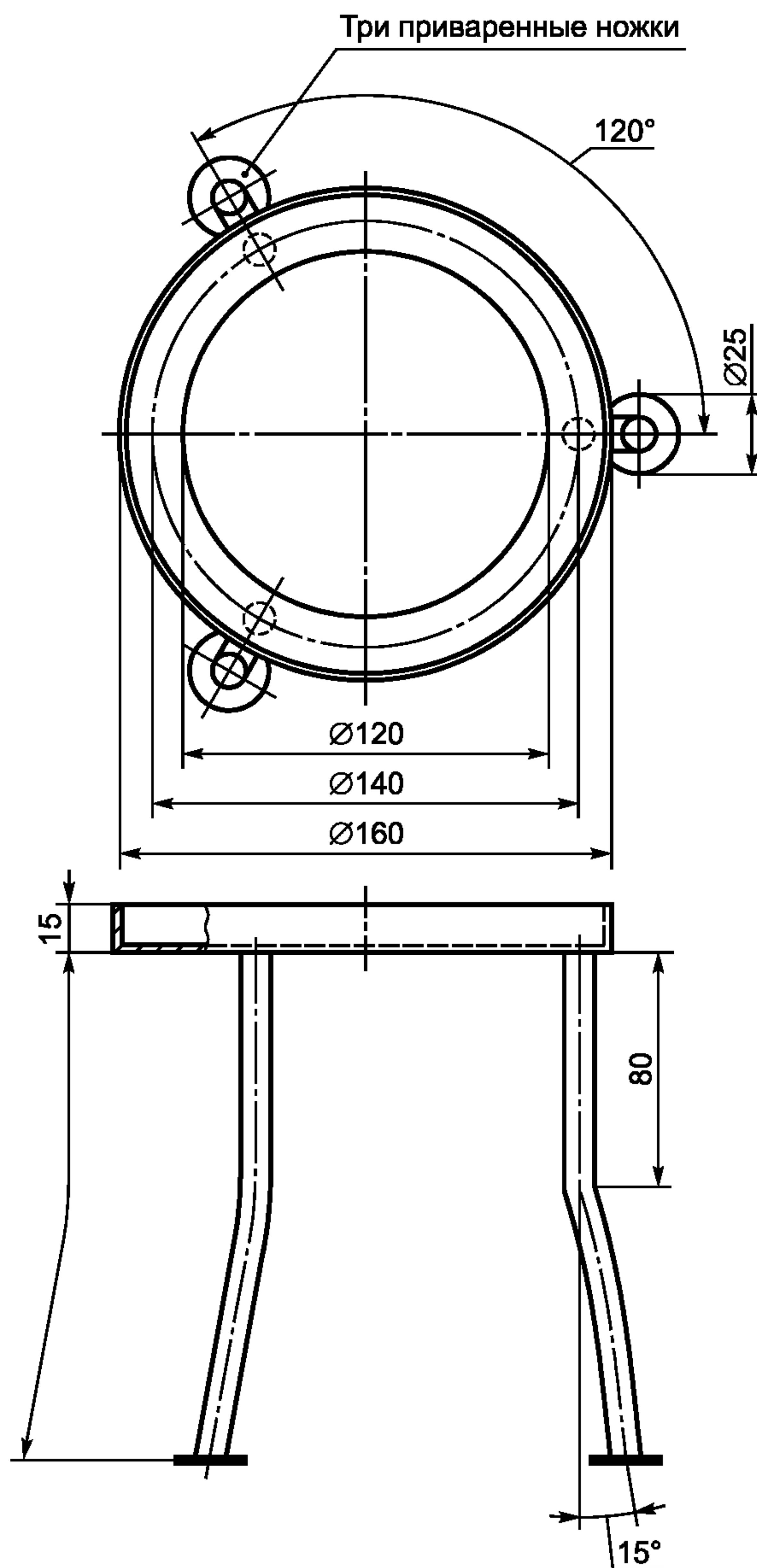
Деталь 28 — Верхняя круговая секция из нержавеющей стали, ножки из трубы из нержавеющей стали наружным диаметром 10 мм, приваренные наконечники ножек диаметром 25 мм из нержавеющей стали
