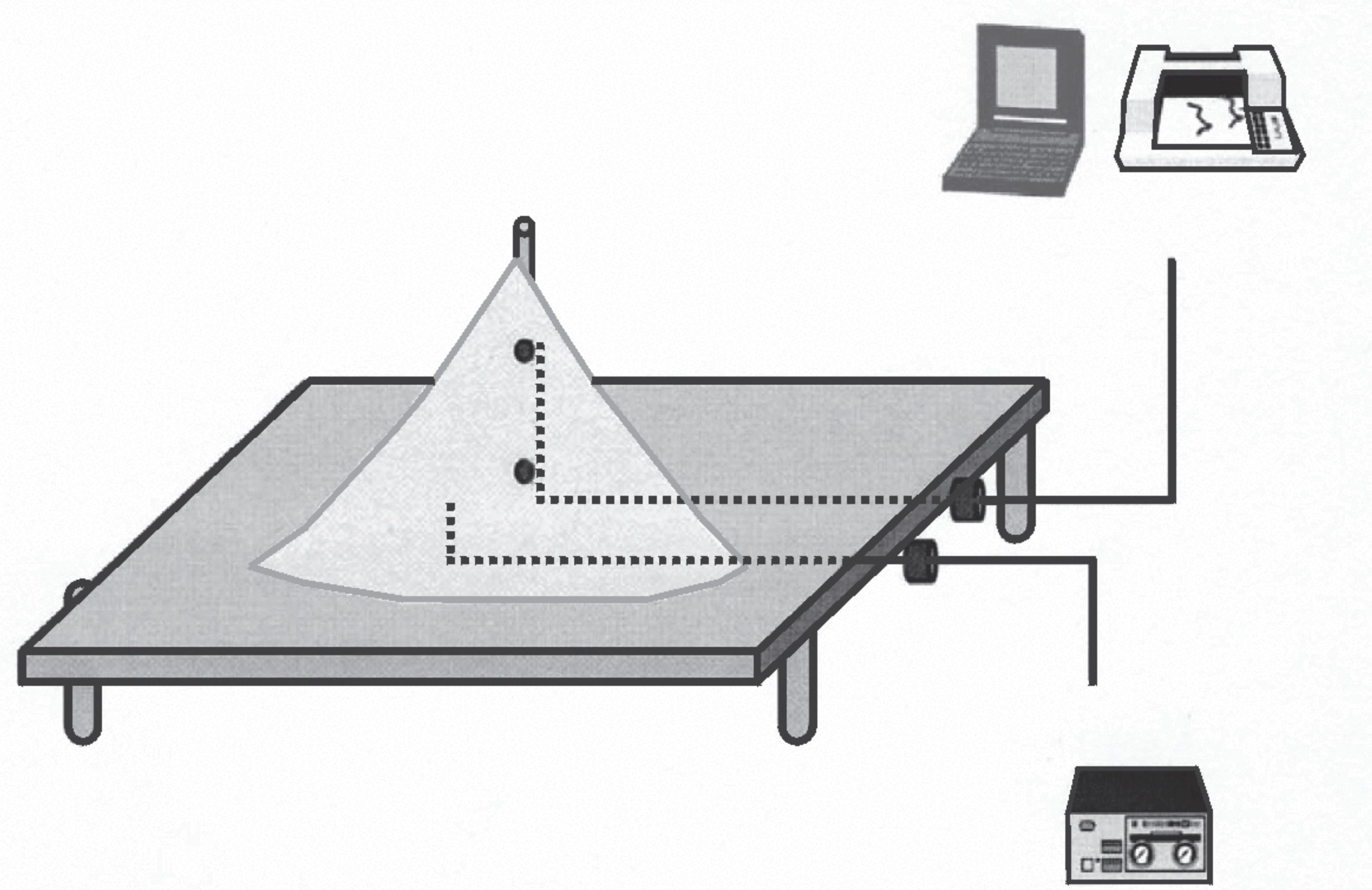
Рисунок С.1 — Схематичное изображение измерения температуры самовоспламенения слоев пыли
