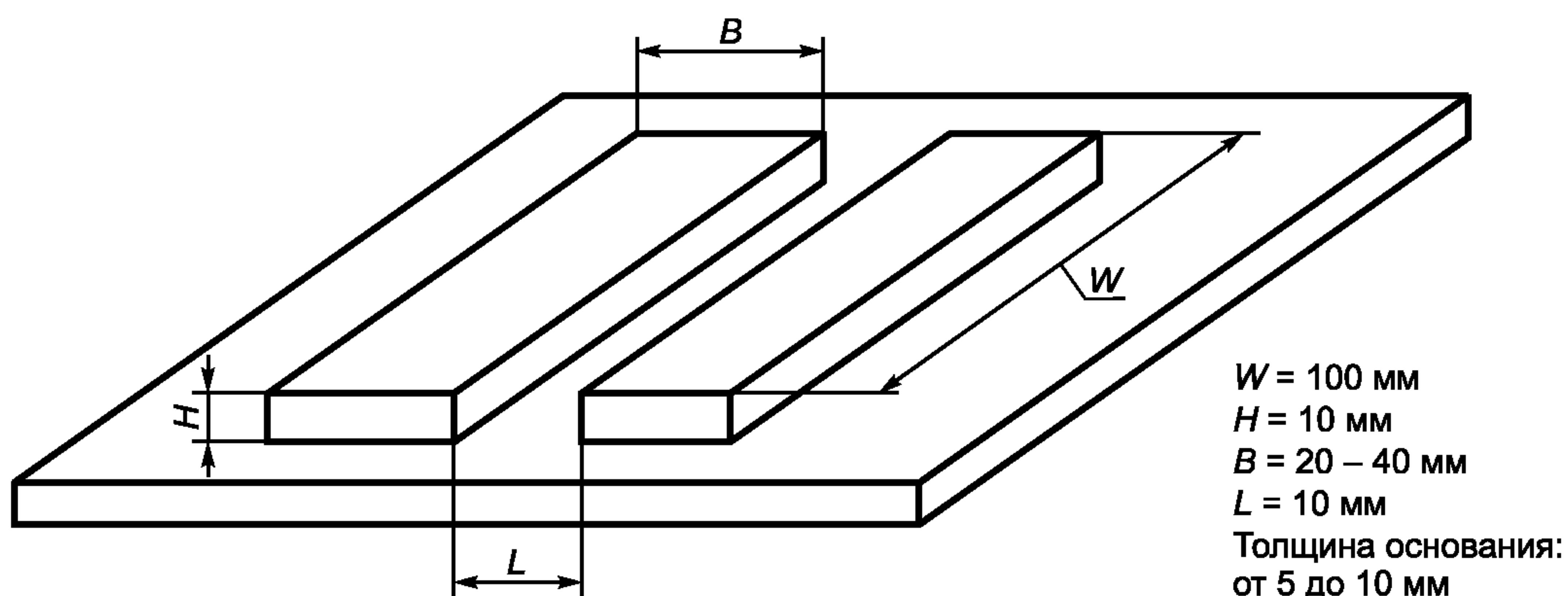
Рисунок 1 — Стенд для испытаний
