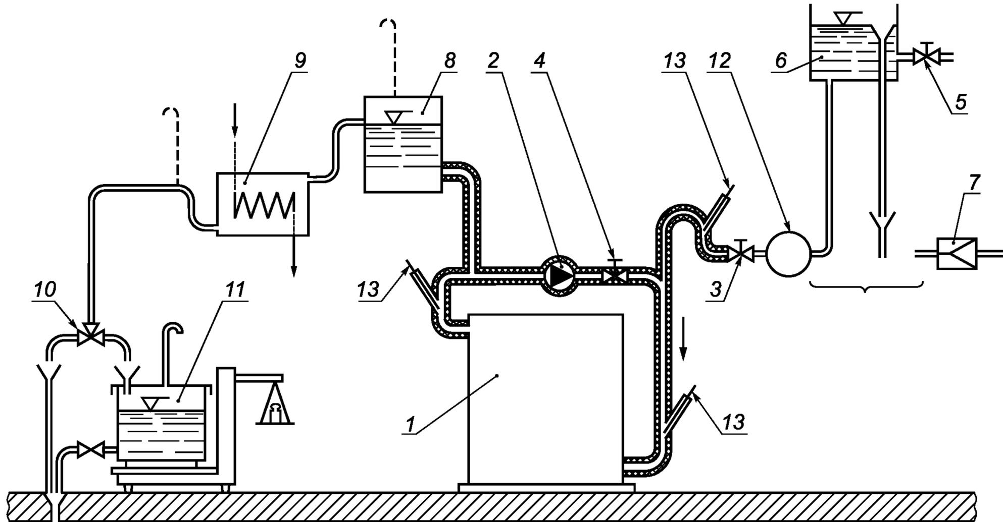
1 — испытуемый котел; 2 — циркуляционный насос; 3 — управляющий клапан I; 4 — управляющий клапан II; 5 — управляющий клапан III; 6 — бак постоянного напора; 7 — соединение с трубой, распределяющей постоянное давление; 8 — компенсационный бак; 9 — охладитель; 10 — трехходовой кран; 11 — сосуд для взвешивания; 12 — водяной расходомер; 13 — измерения температуры
