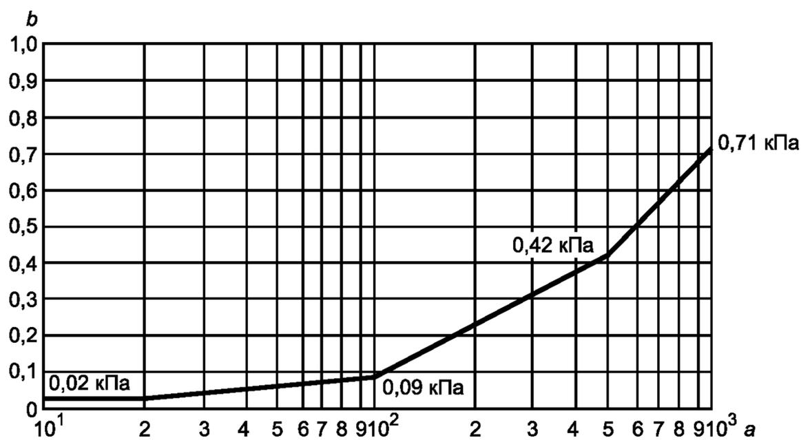
$a$  — номинальная полезная выходная мощность  $P_n$ , кВт;  $b$  — разница давления, кПа
