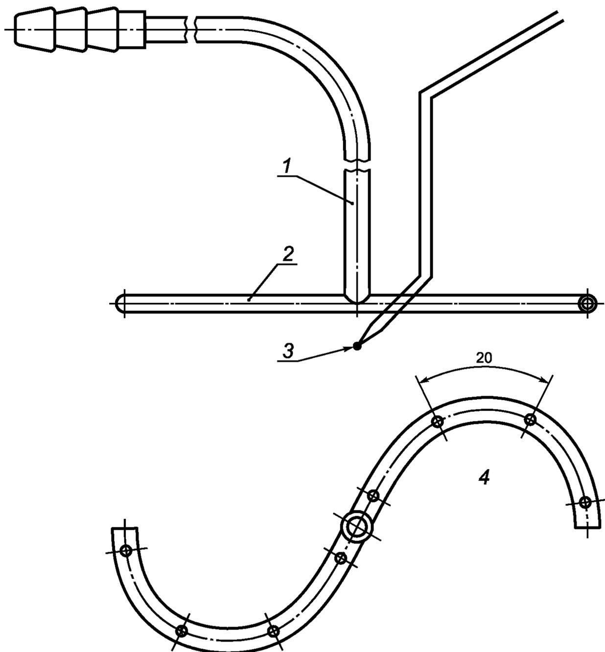
1 — трубка  $\varnothing$  6 мм; 2 — трубка  $\varnothing$  5 мм; 3 — термопара; 4 — отверстия:  $8 \times \varnothing$  1 мм
