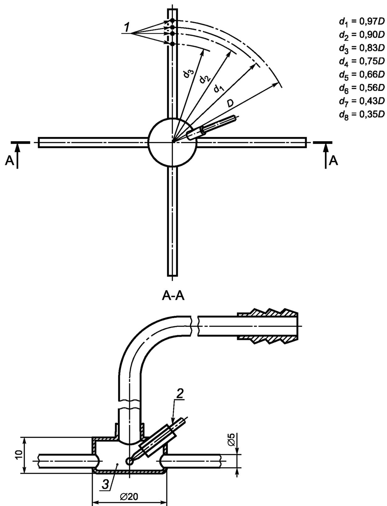
1 — отверстия в каждом ответвлении:  $8 \times \varnothing 1$  мм; 2 — термопара; 3 — пробоотборник
