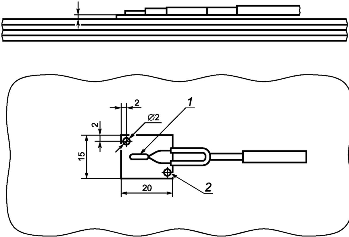
1 — термопара, припаянная к медной пластине; 2 — отверстие для присоединения медной пластины
