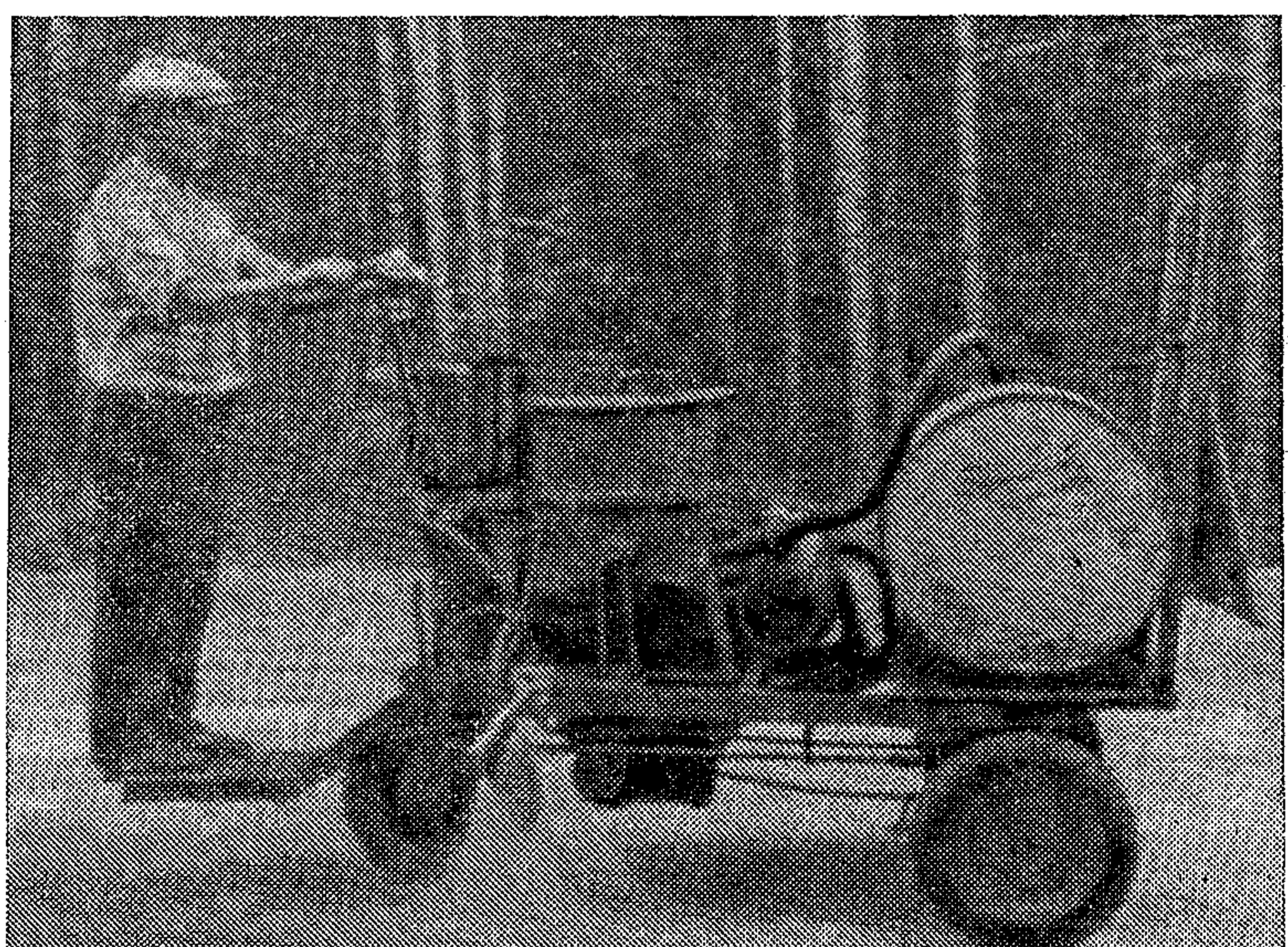
Рис. 11. Малогабаритный распределитель пленкообразующих материалов
