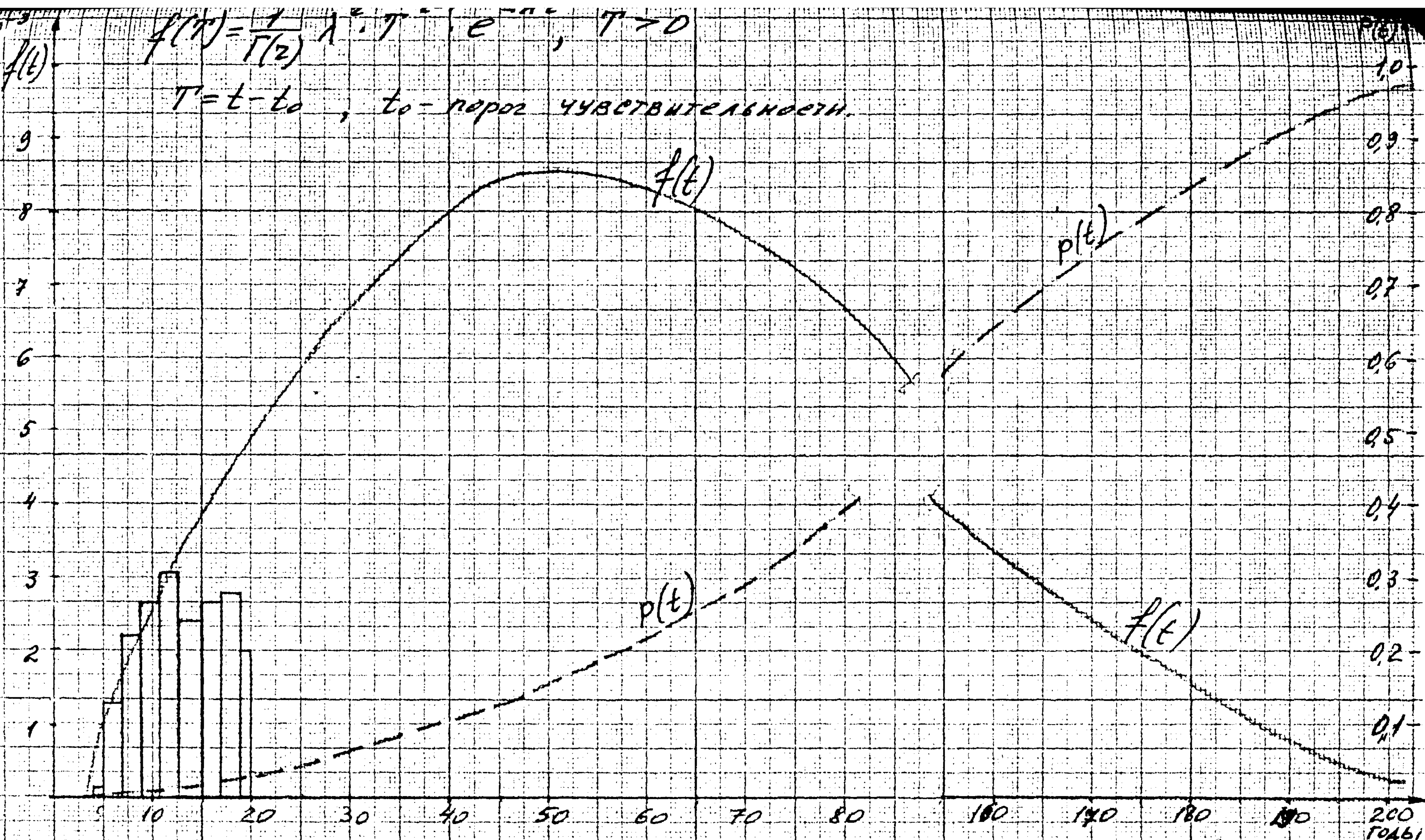
Рис. 3. Плотность вероятности времени до коррозионного отказа f(t) и вероятность безотказной работы p(t) , построенные с учетом замещения углубков
