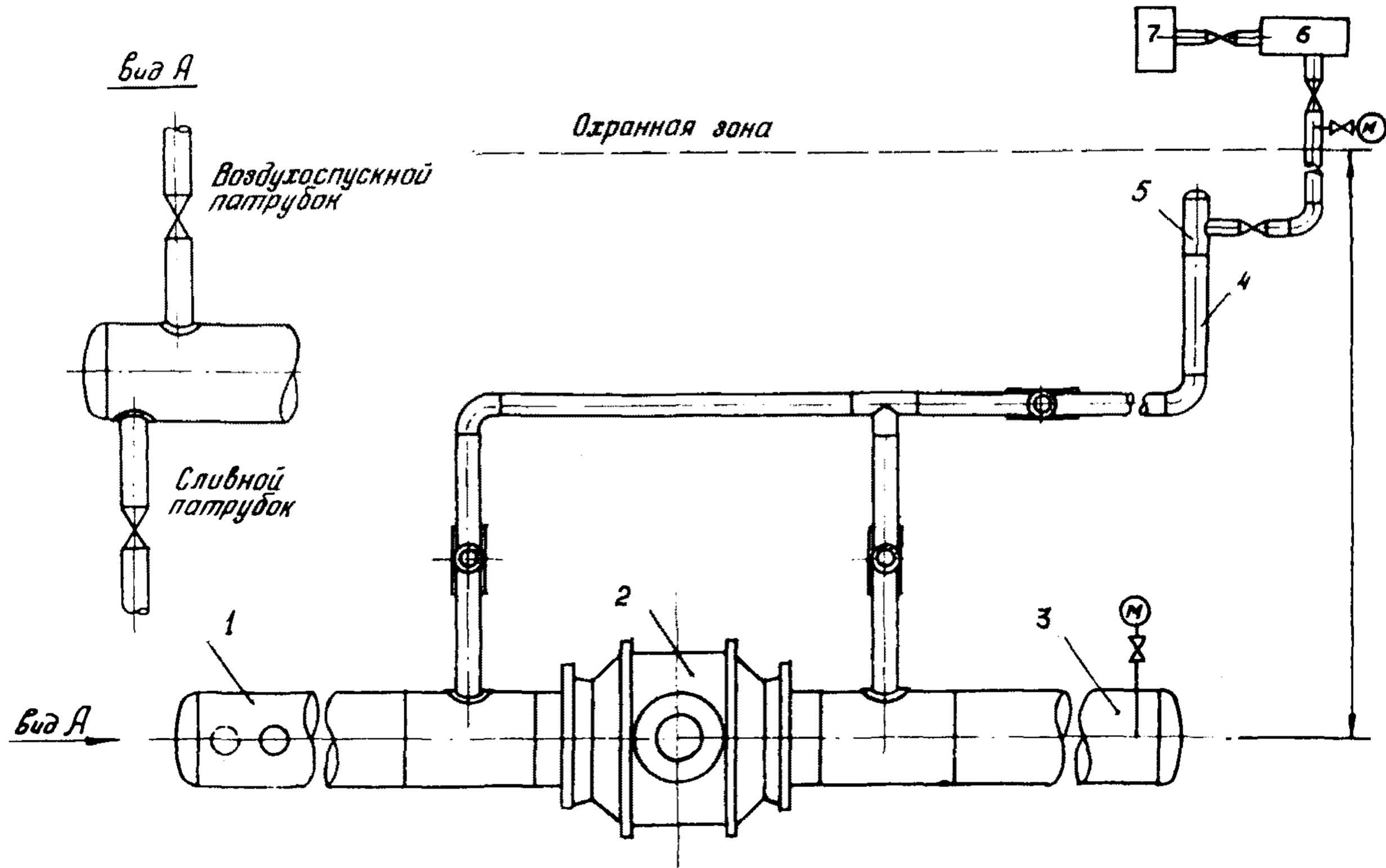
Принципиальная схема предварительного гидравлического испытания кранового узла:
