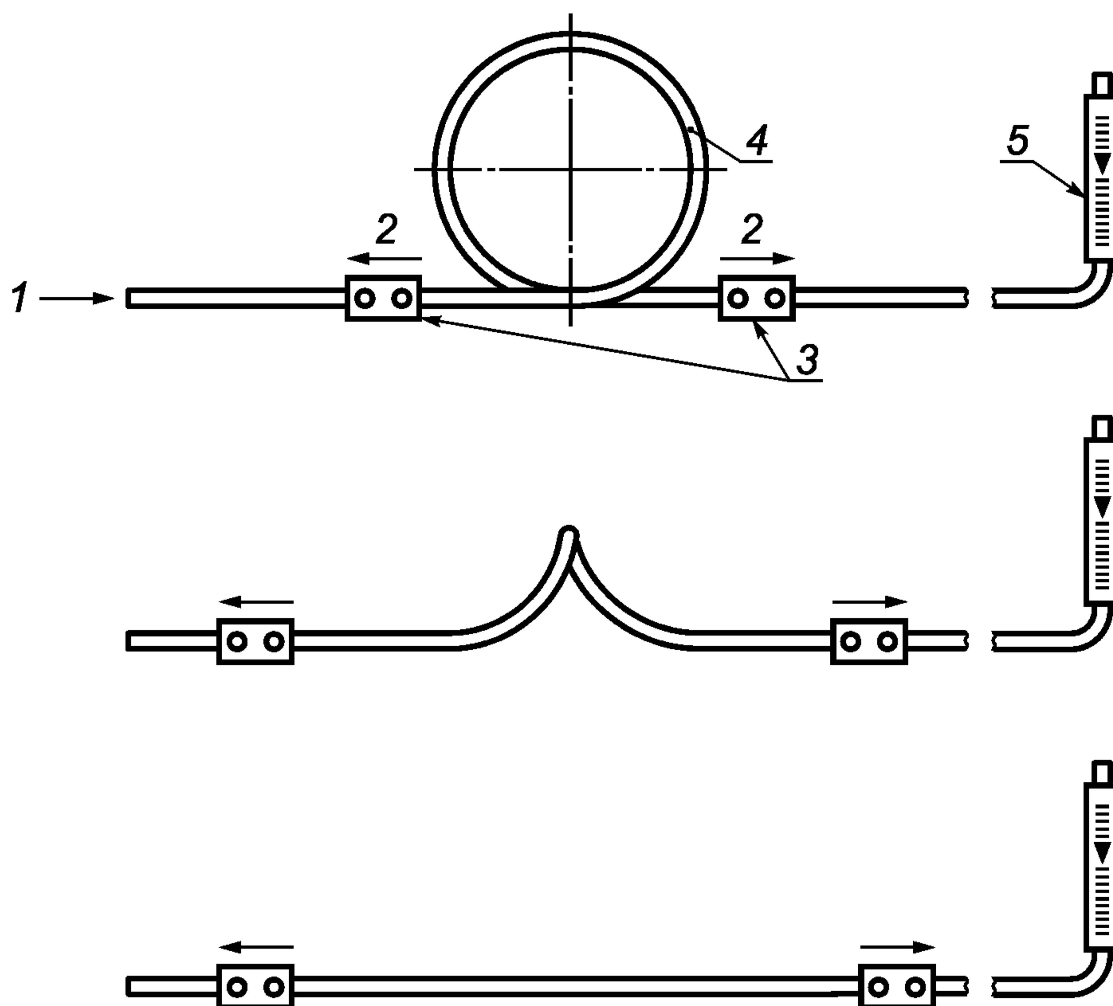
Рисунок 3 — Устройство для испытания сопротивления скручиванию шланга подачи сжатого воздуха (класс В)
