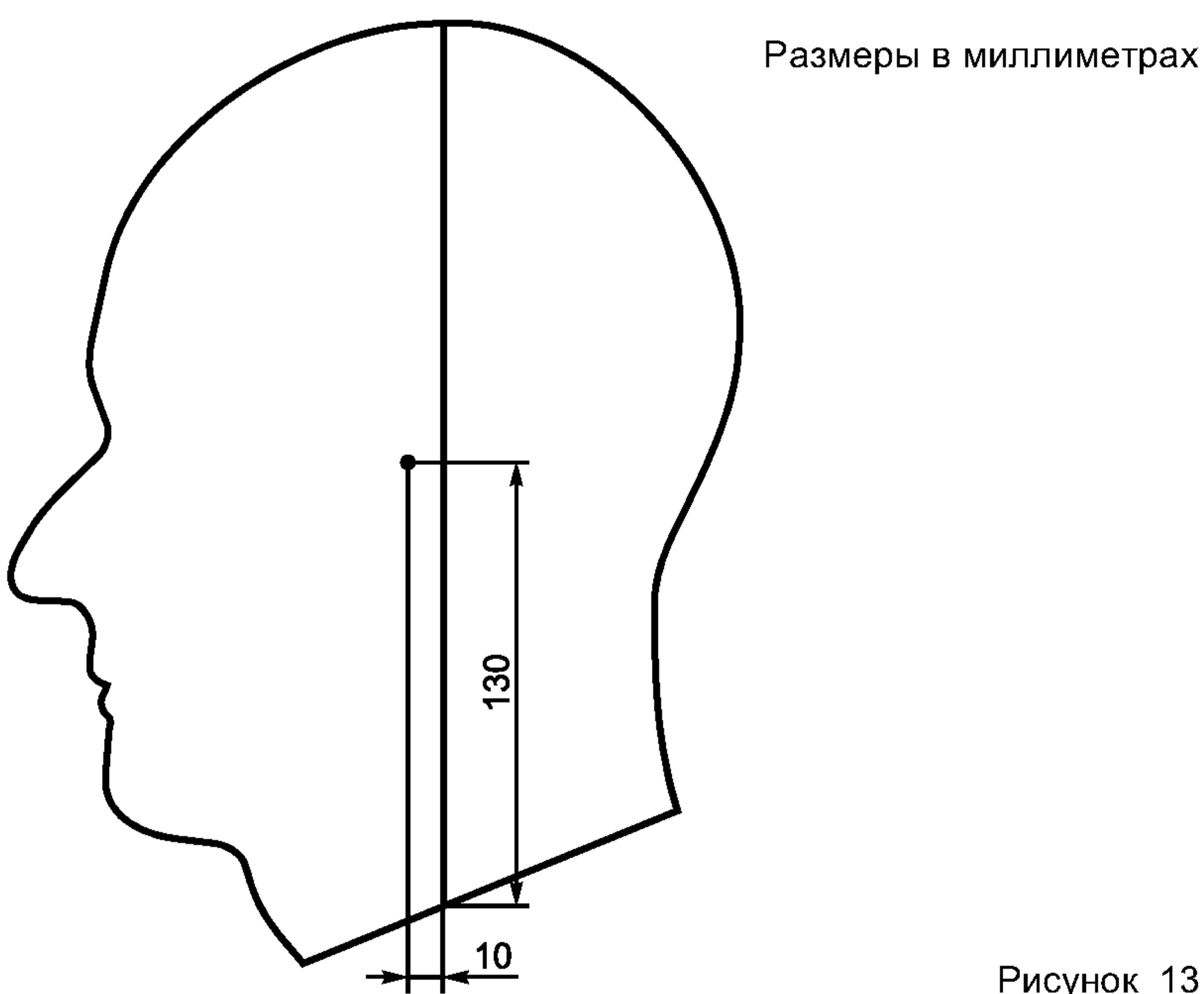
Рисунок 13 — Расположение микрофонов
