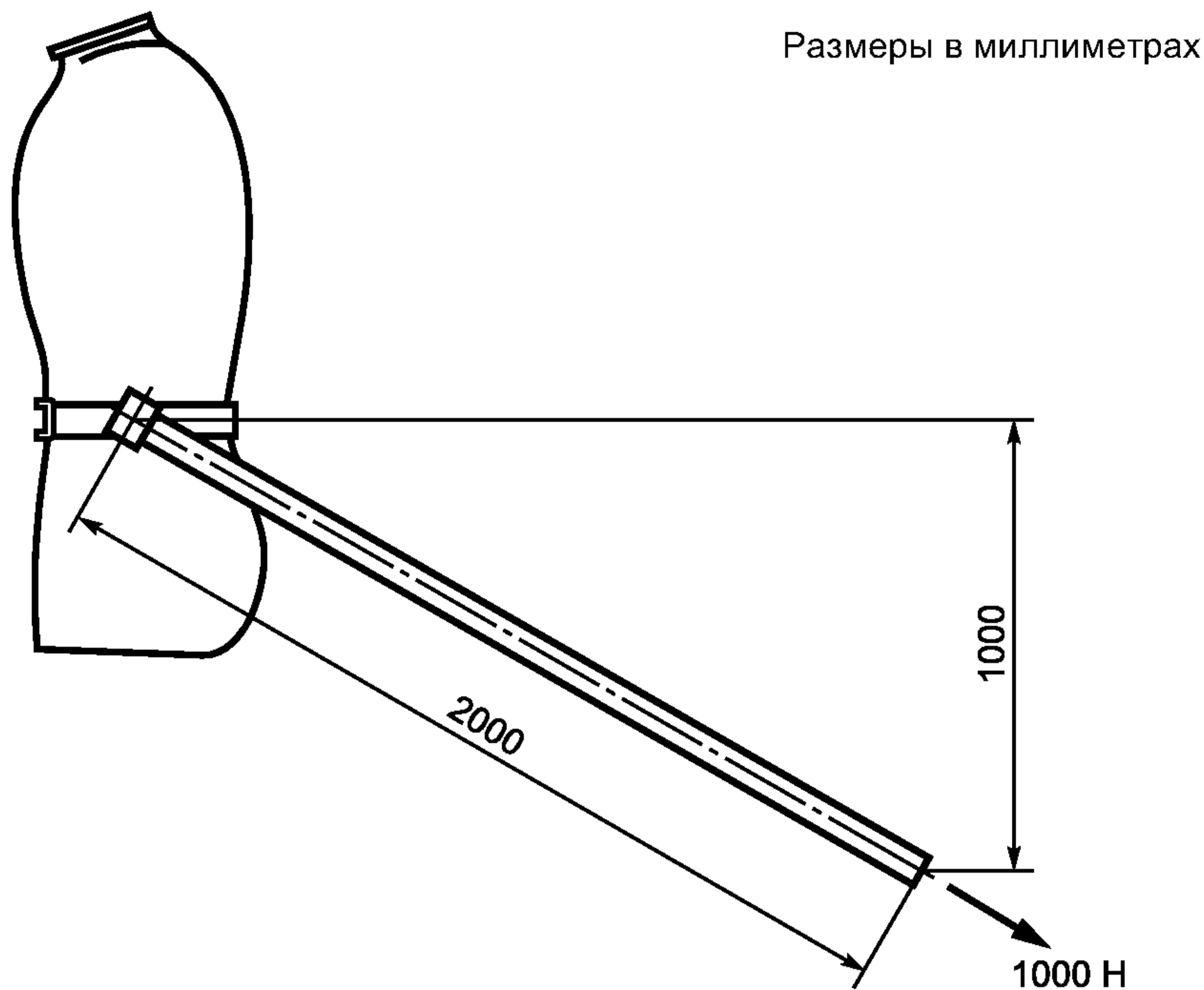
Рисунок 2 — Устройство для испытания прочности пояса или ремня шланга подачи сжатого воздуха и разъемов
