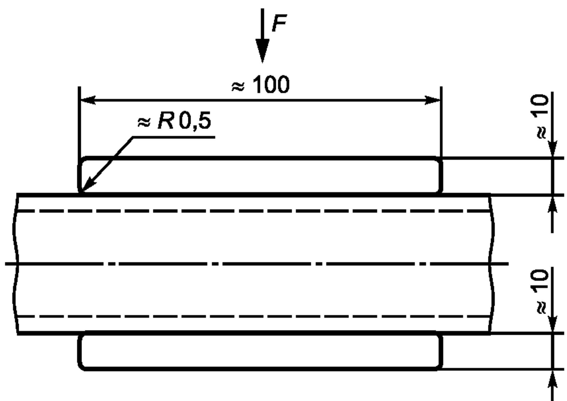
Рисунок 5 — Устройство для испытания сопротивления сжатия шланга подаче сжатого воздуха
