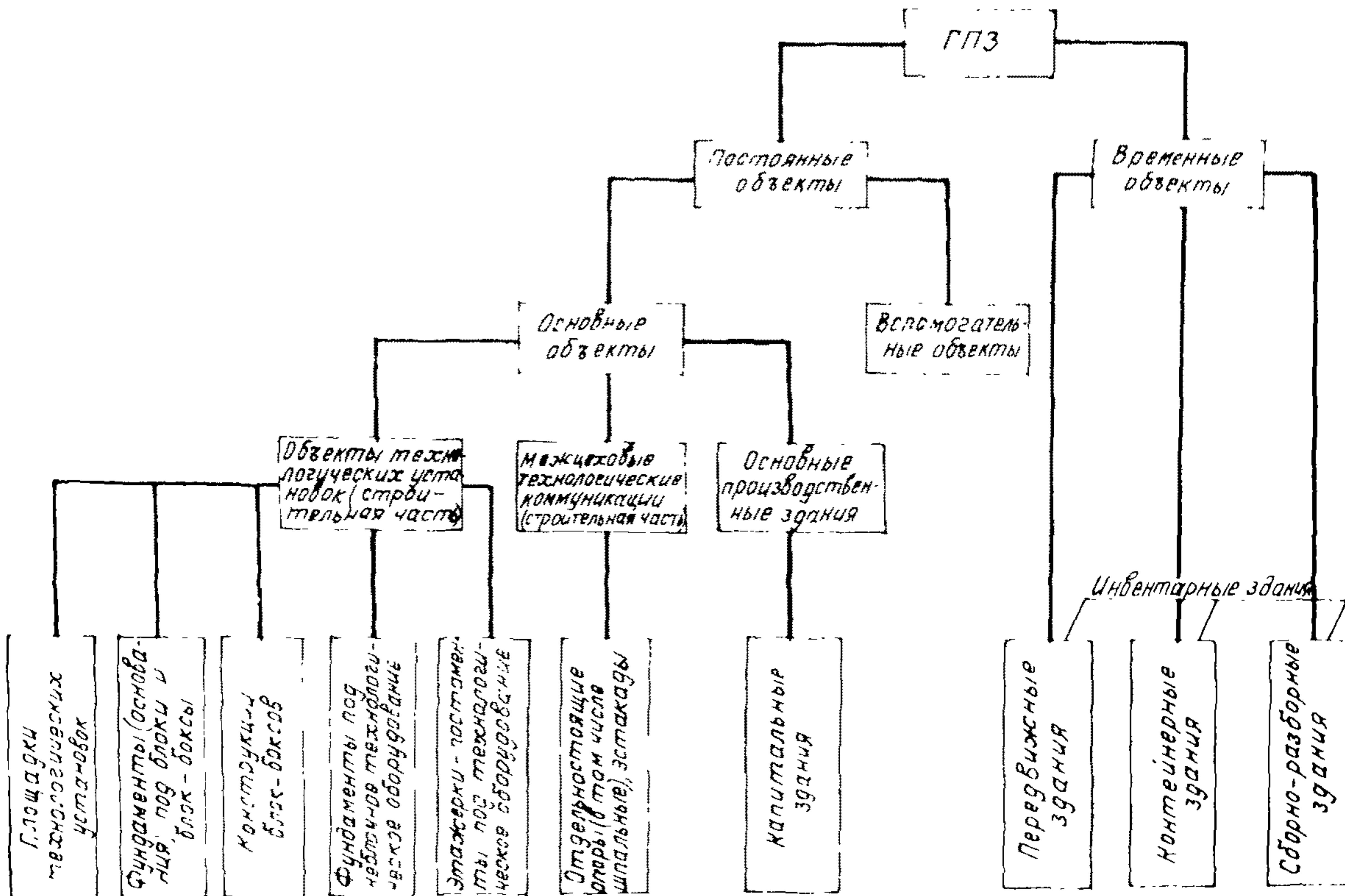
Рис. I. Классификация основных строительных объектов и конструкций ГПЗ
