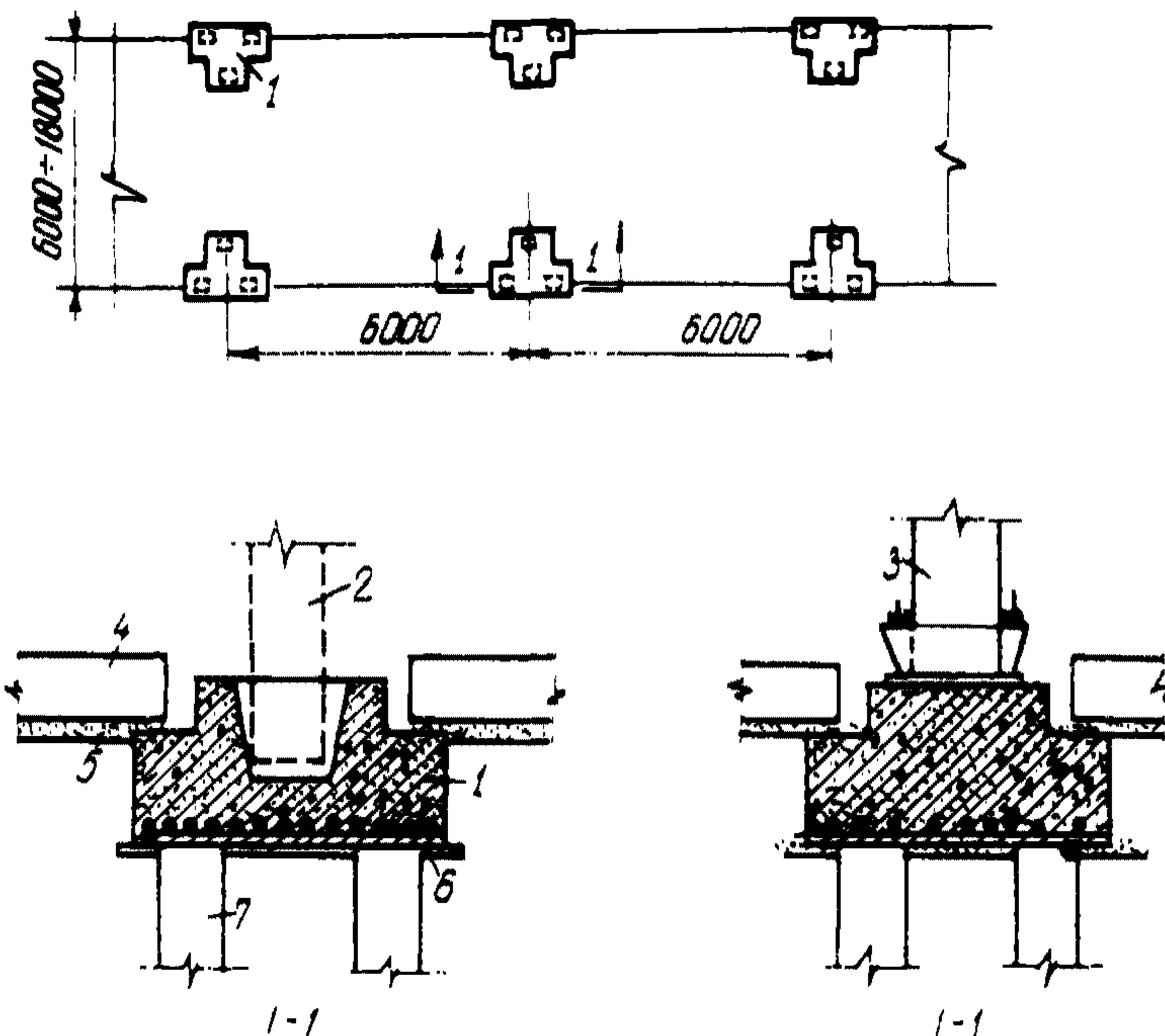
Рис.5. Свайные фундаменты с монолитными ростверками под железобетонный и стальной каркасы зданий:
