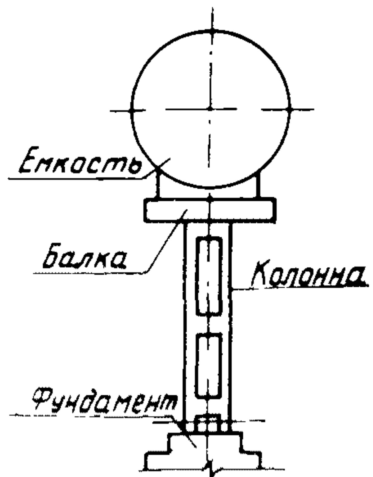
Рис.7. Решение унифицированных постаментов под оборудование по серии ИС-ОI-17
