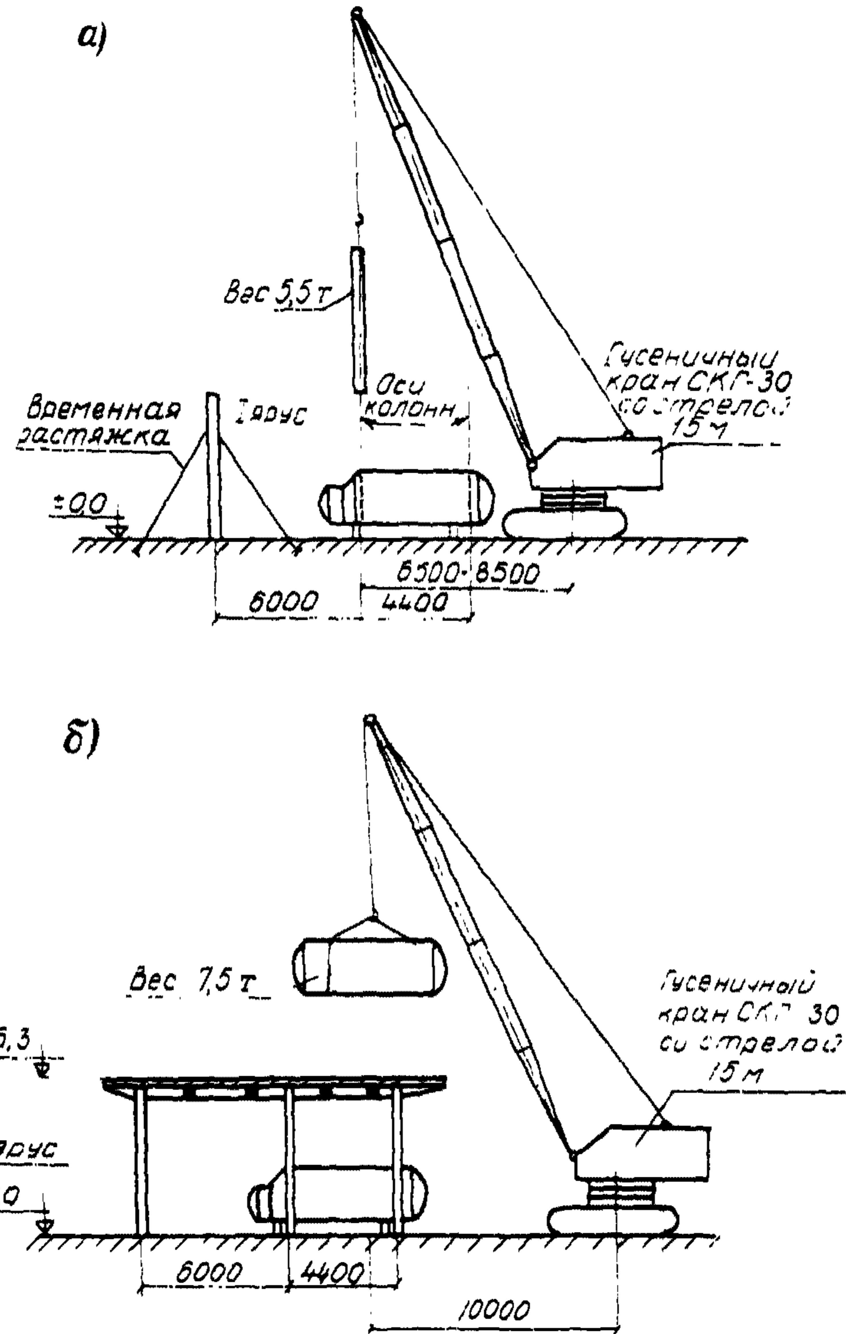
Рис.25. Технологическая схема монтажа этажерок-постаментов
