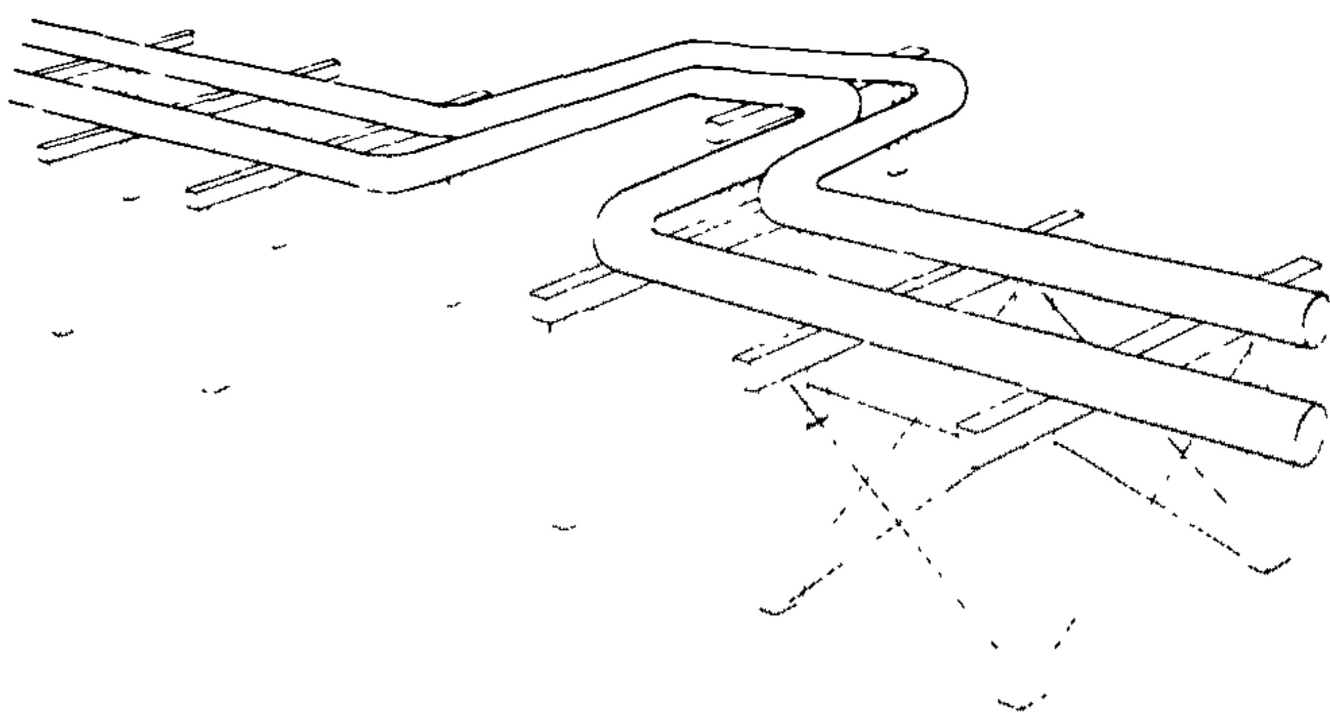
Рис. II. Опоры под технологические коммуникации на сваях-стойках
