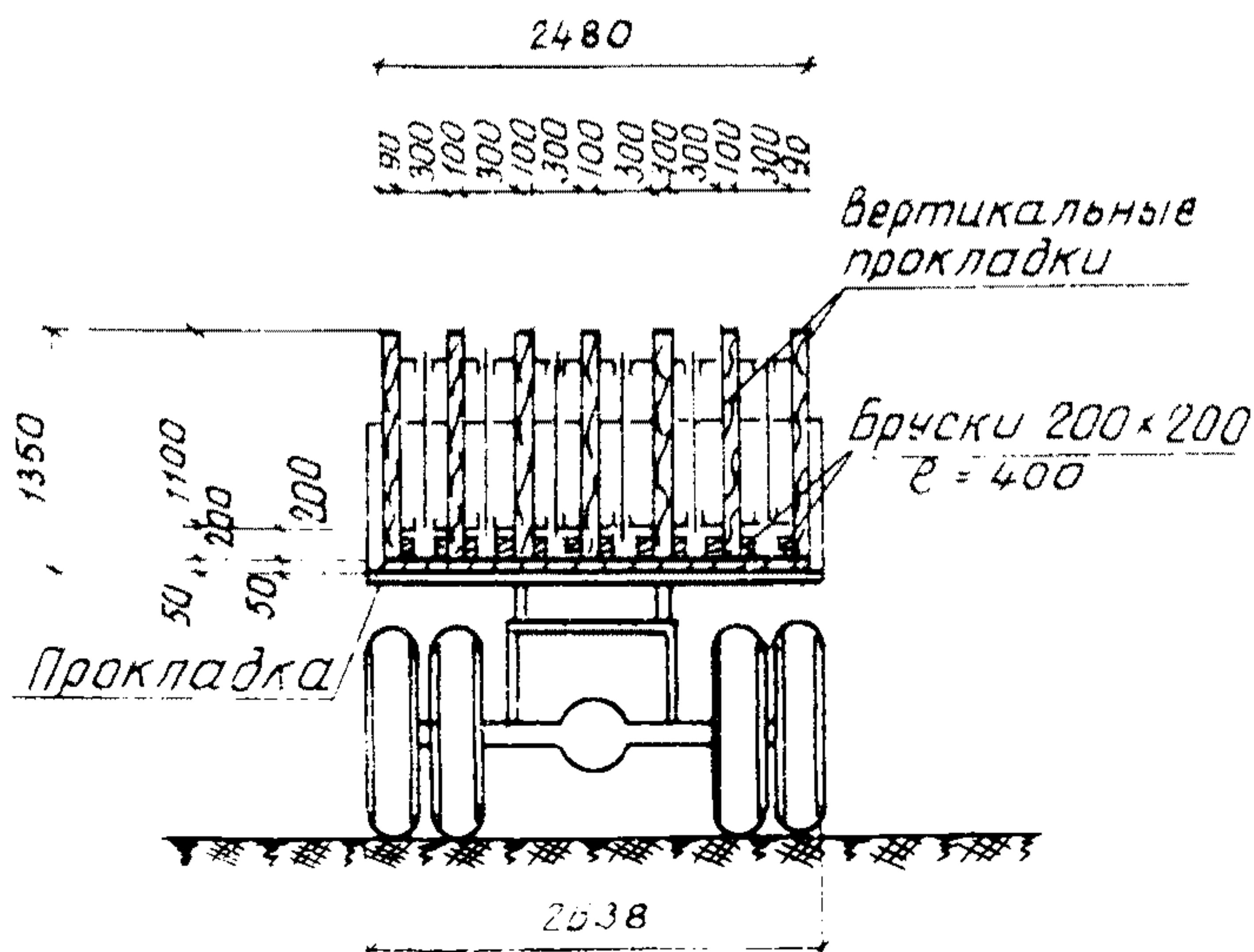
Рис. I6. Пример пакетной укладки стропильных ферм на транспортные средства
