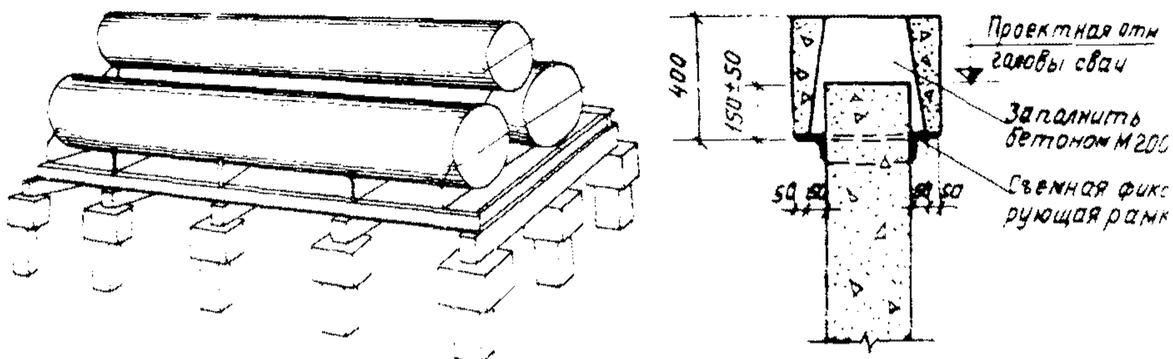
**Рис.3. Установка блок-бокса на свайный фундамент со сборным ростверком:**
