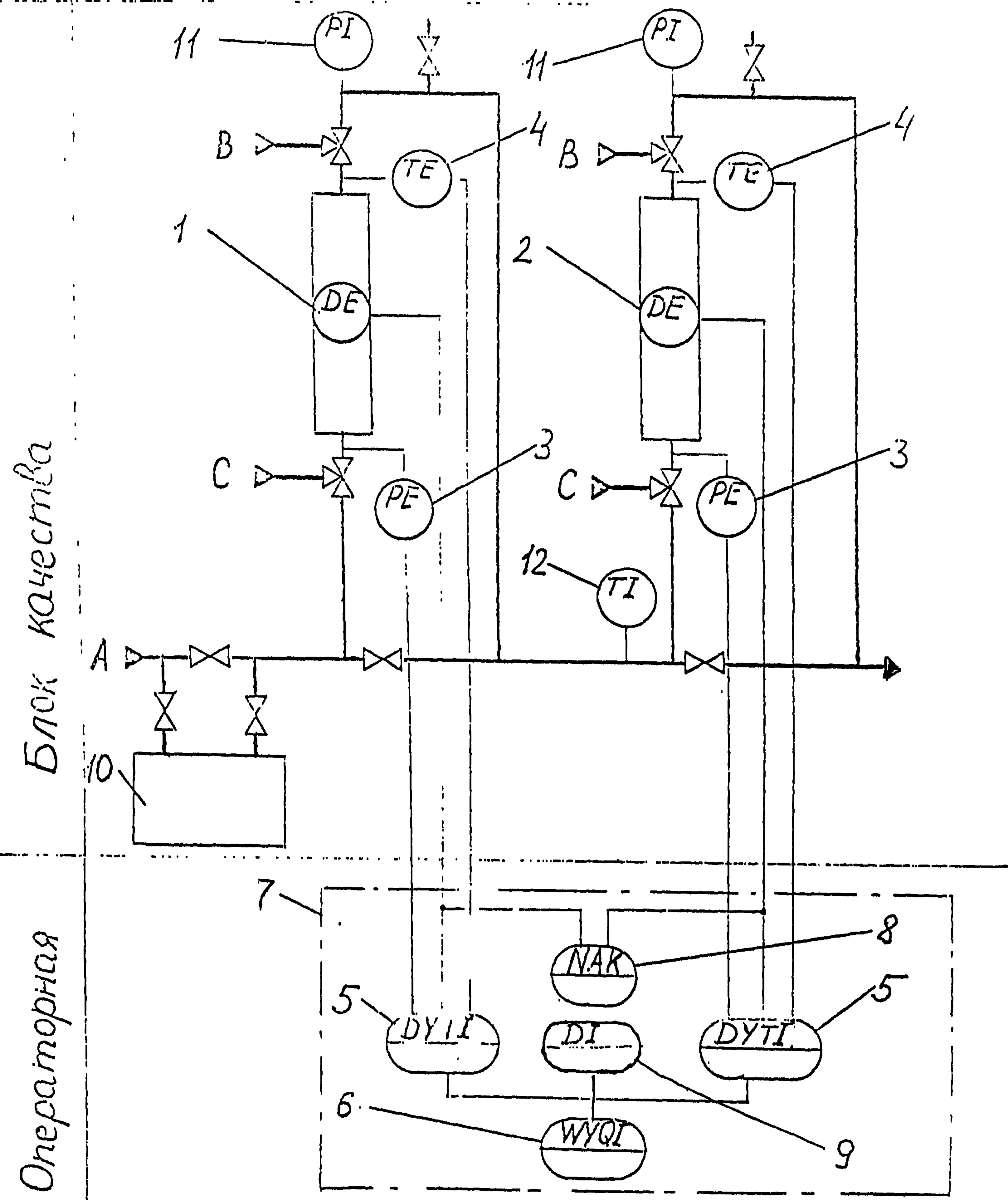
I,2. Датчики плотности.3. Датчики давления. 4.Датчики температуры. 5,6. Вычислительные устройства.плотности и массы продукта. 7. Вычислительная система УУЛ. 8.Устройство контроля.9.Дисплей. 10.Пикнометрическая установка.11.Манометр.12.Термометр. А.Отбор проб продукта из трубопровода.В,С.Подвод и отвод промежуточной жидкости.
