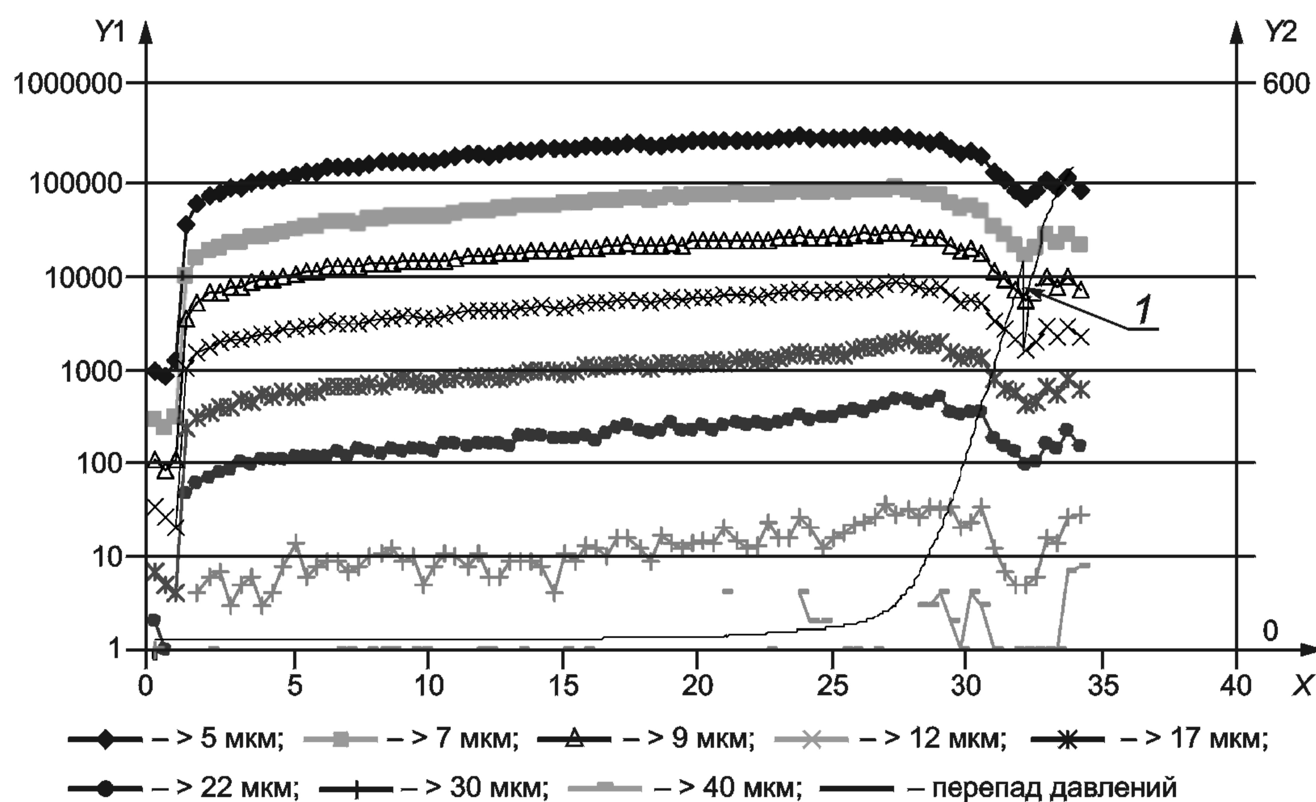
X — масса введенной среднедисперсной тестовой пыли ИСО, г; Y1 — число частиц в 10 мл; Y2 — перепад давлений на фильтроэлементе, кПа; 1 — перепад давлений, при котором происходит разрушение фильтроэлемента
