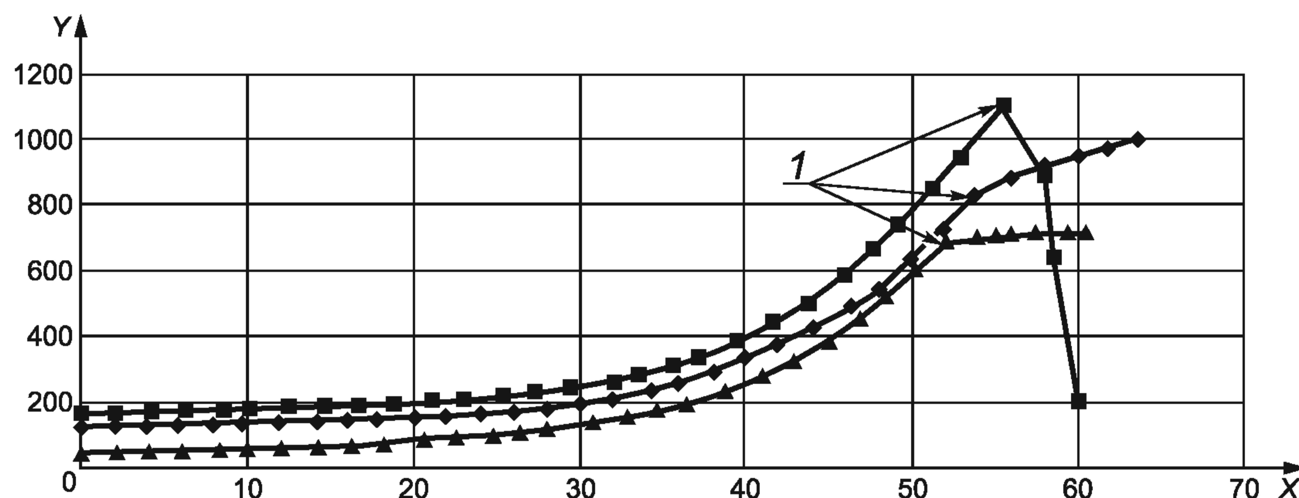
X — масса добавленной среднедисперсной тестовой пыли ИСО, г; Y — перепад давлений, кПа; 1 — точки, соответствующие разрушению фильтроэлемента, в которых происходит резкое уменьшение угла наклона графика
