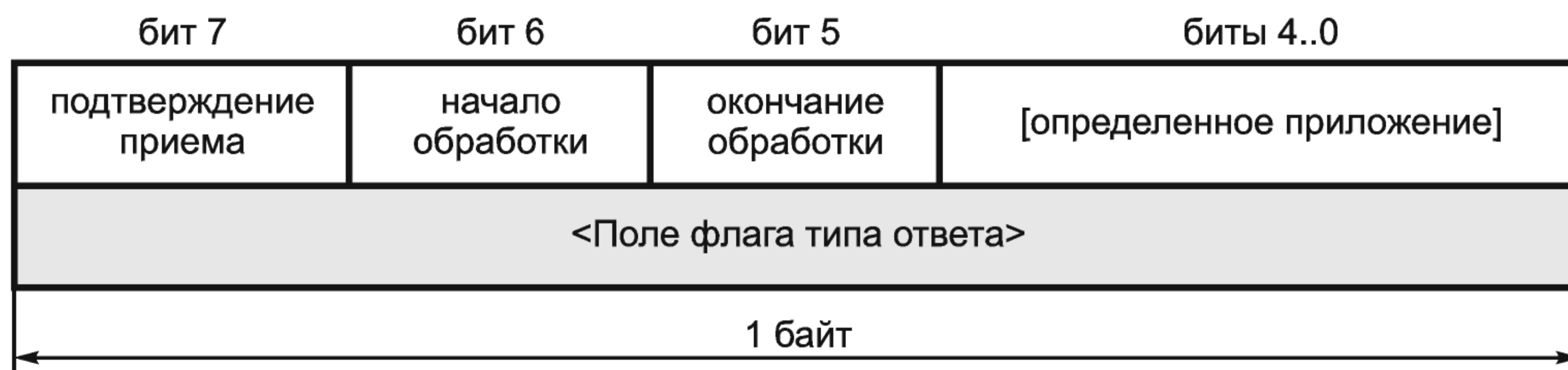
Рисунок Е.5 — Структура поля флага типа ответа
