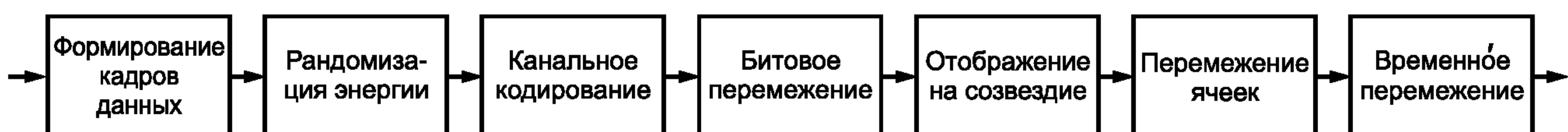
Рисунок 2 — Составные части блока обработки, канального кодирования и перемежения входных данных
