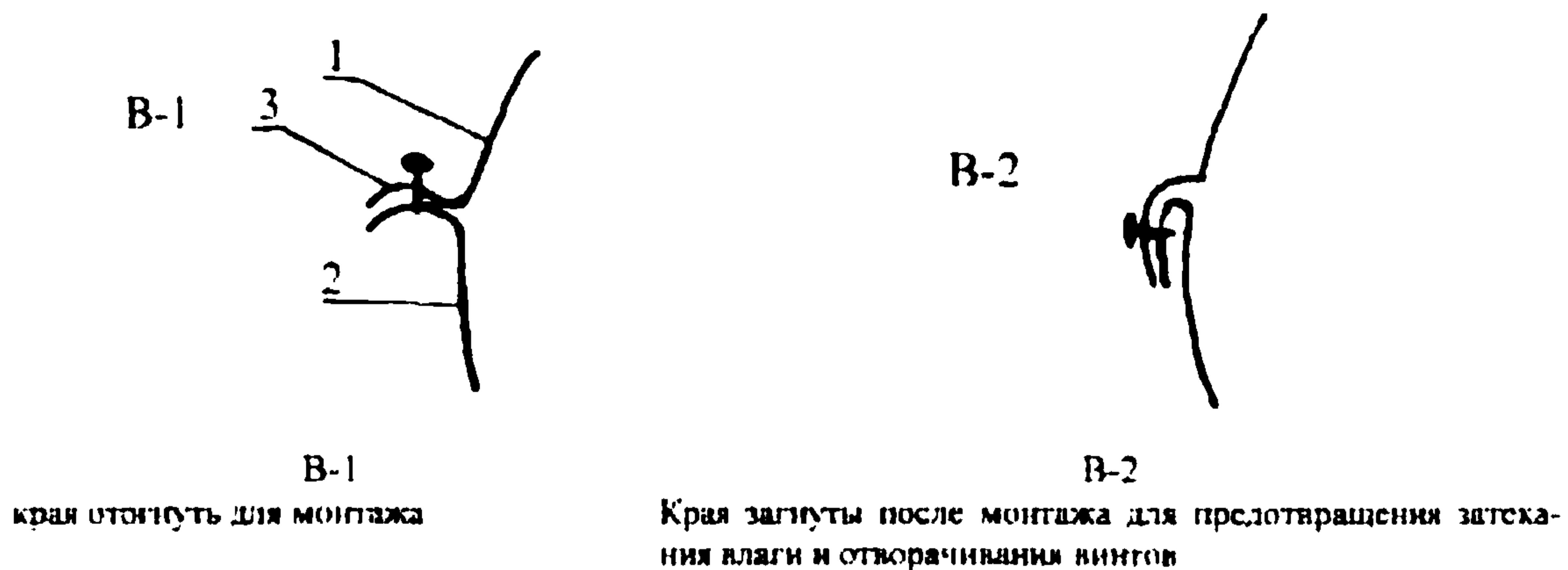
Рисунок 7 - Узел закрепления стяжек при установке скорлуп
