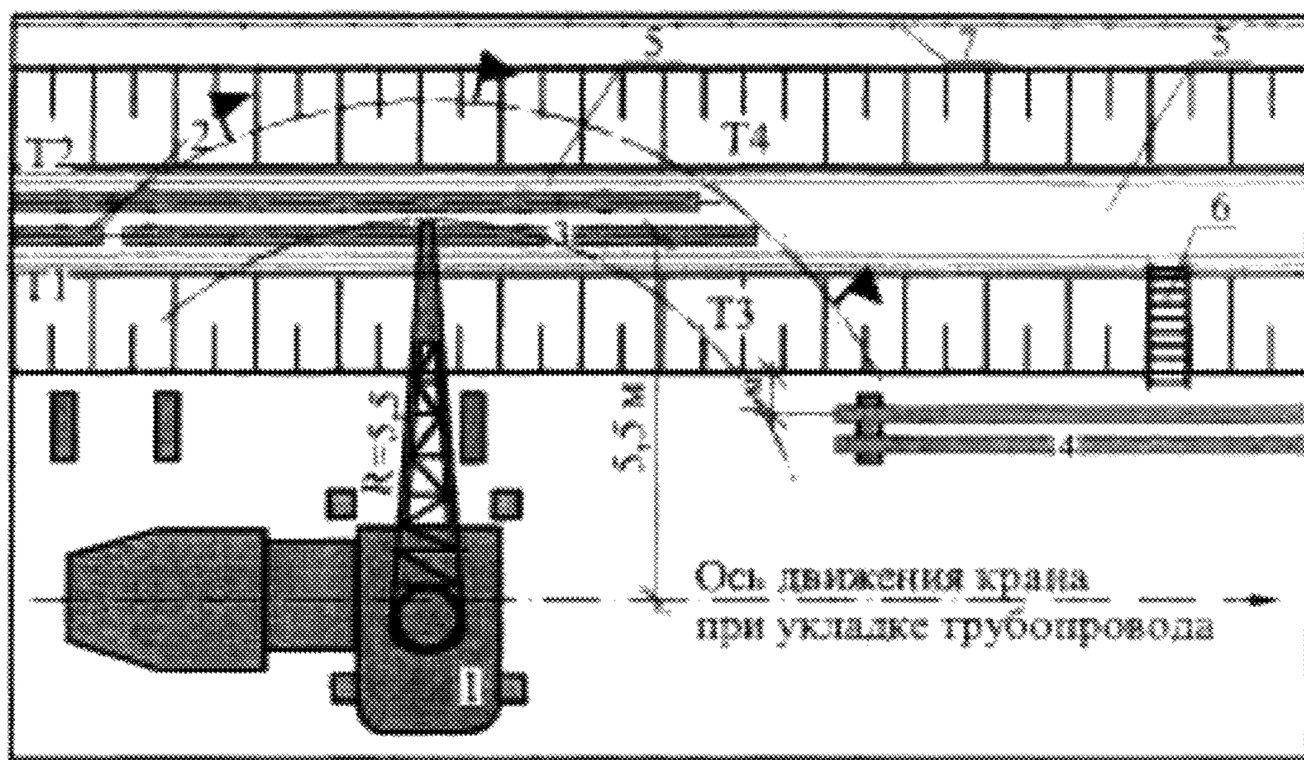
1 - кран; 2 - центратор; 3 - траверса; 4 - звено труб; 5 - непроходной канал; 6 - лестница для спуска в траншею; 7 - временное ограждение; Т1 и Т2, Т3 и Т4 рабочие места исполнителей
