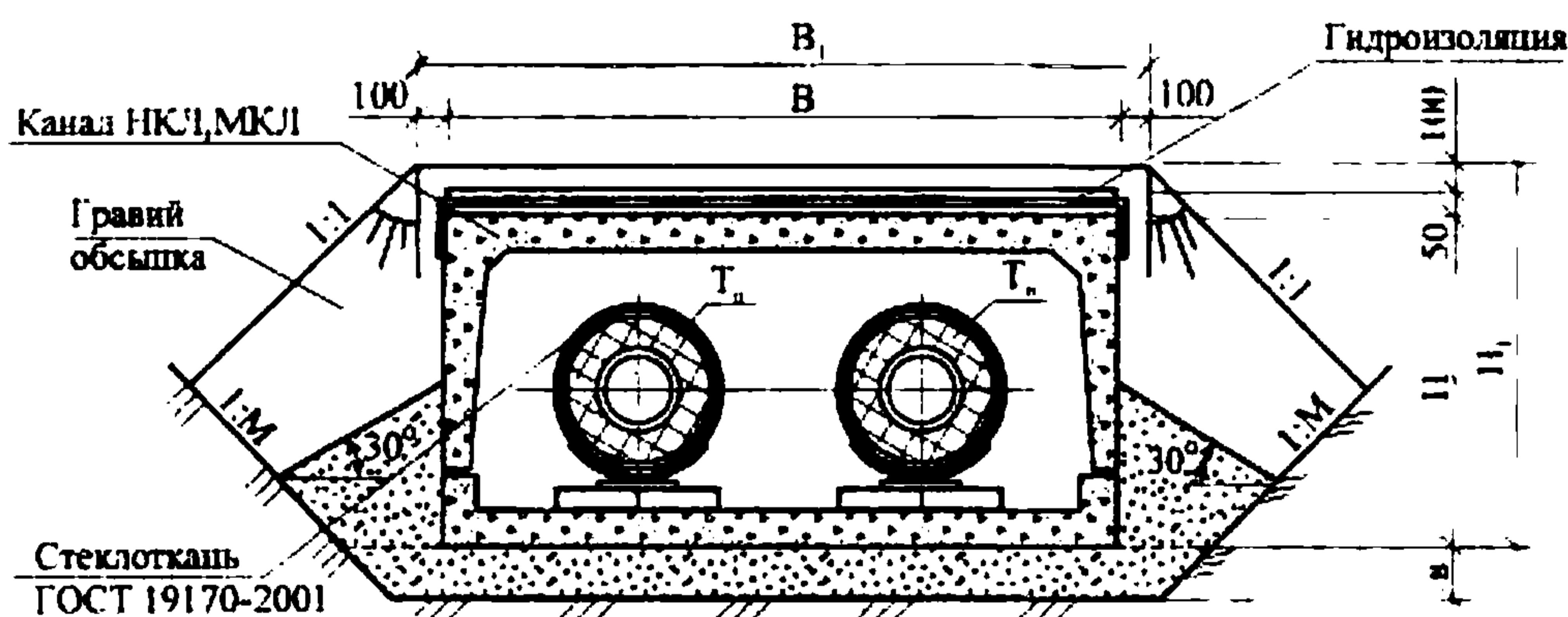
Тп - подающий трубопровод отопления;
