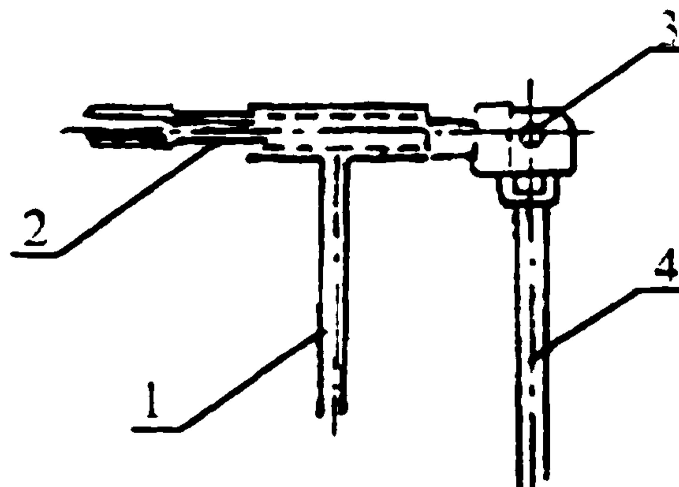
Рисунок 8 - Ключ для затяжки бандажа
