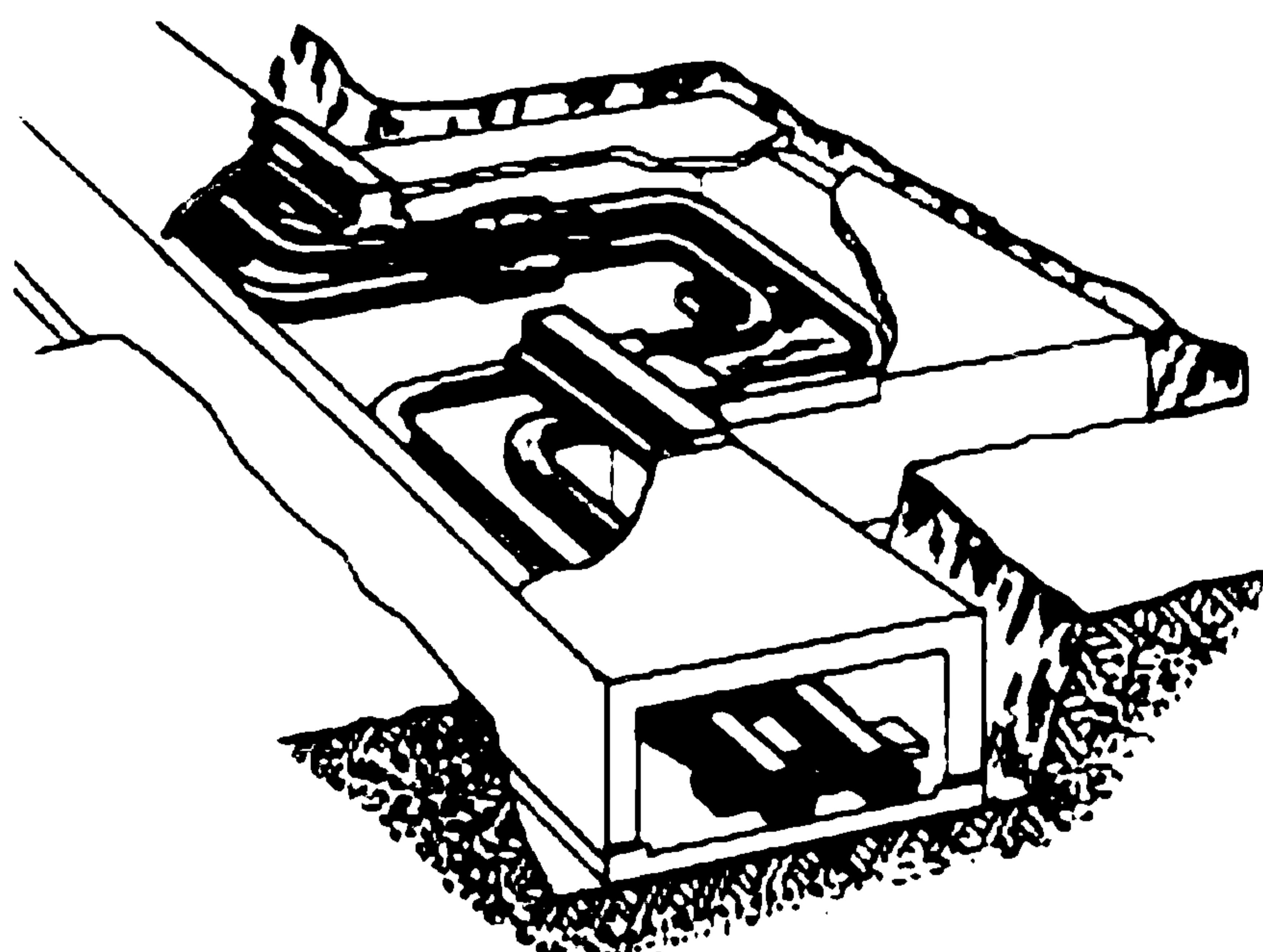
Рисунок 5 - Гнуемые компенсаторы
