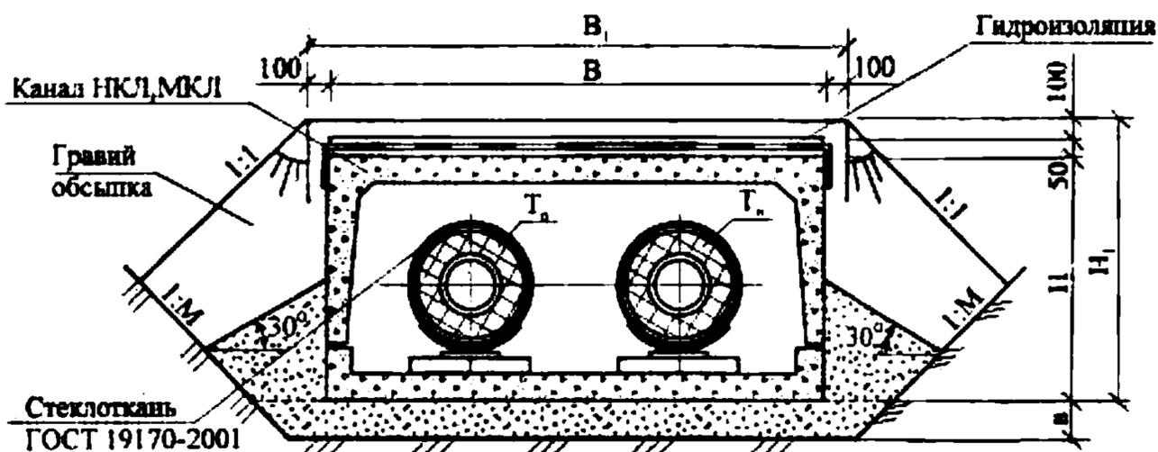
Тп - подающий трубопровод отопления;
