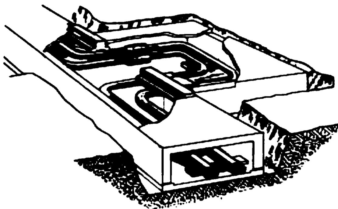
Рисунок 5 - Гнутые компенсаторы
