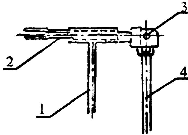
1 - вспомогательный рычаг; 2 - рабочий вал; 3 - ось; 4 - основной рычаг
