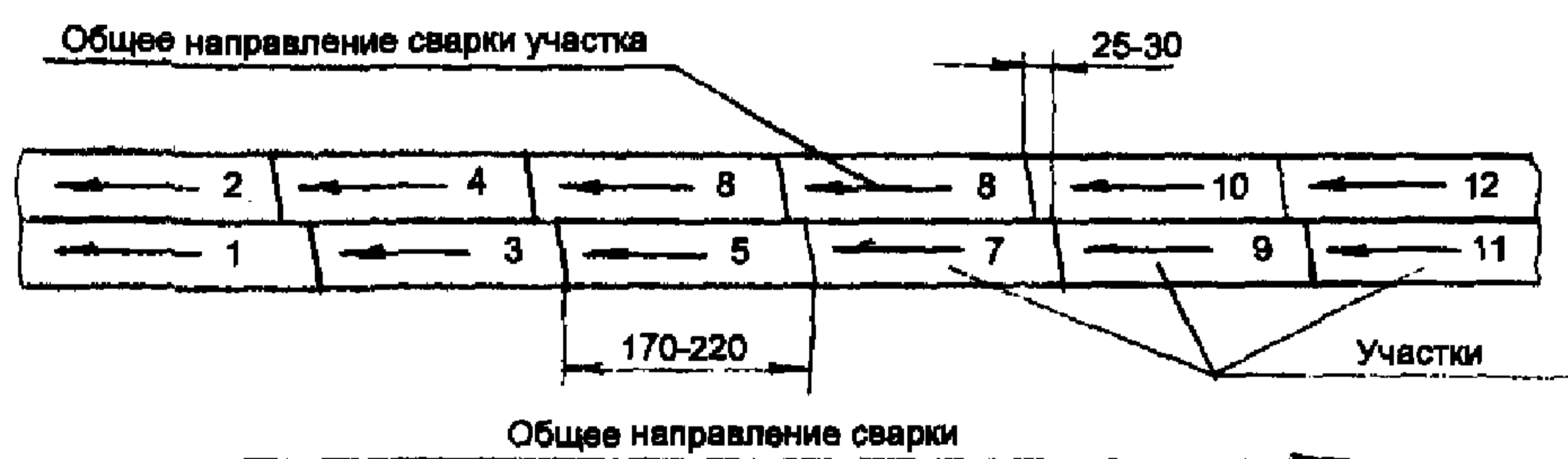
Рисунок 4.2 – Сварка швов способом двойного слоя
