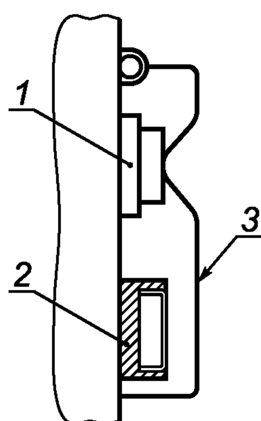
1 — выключено; 2 — включено; 3 — защитный кожух («ВЫКЛ.»)
