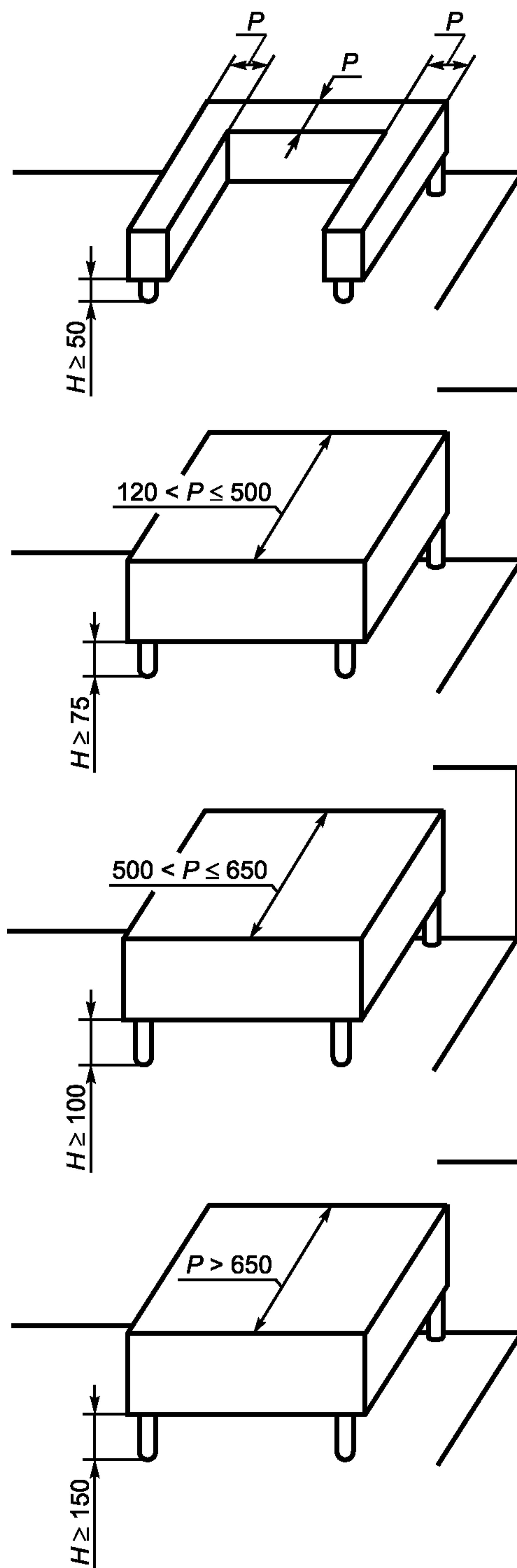
Рисунок А.12 — Подставки для машин
