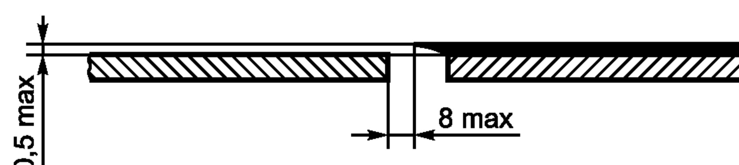
Рисунок 5 — Максимально допустимый размер под ножами
