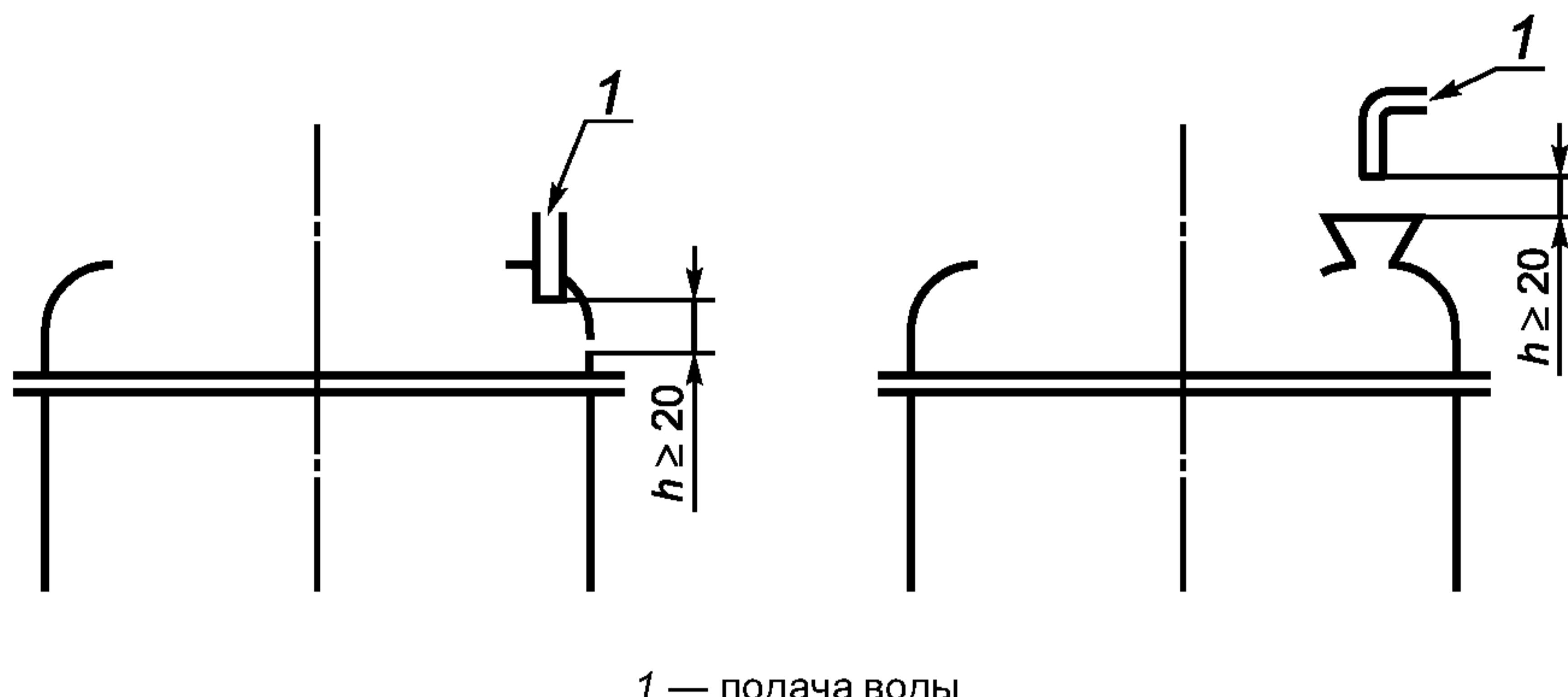
Рисунок 9 — Примеры создания «воздушного зазора»
