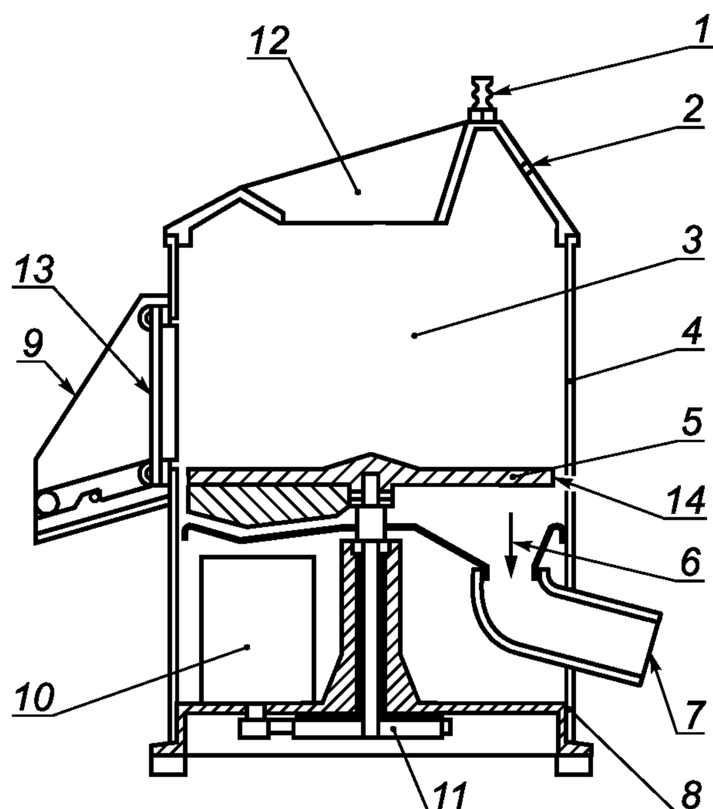
1 — впускной патрубок для воды; 2 — впускное отверстие для воздуха; 3 — камера чистки; 4 — стенки; 5 — рабочий орган; 6 — выпускной патрубок для воды; 7 — отверстие для выгрузки отходов; 8 — корпус; 9 — проем для выгрузки с желобом для очищенных клубней; 10 — электродвигатель; 11 — приводной механизм; 12 — загрузочный люк; 13 — шибер выгрузочного проема; 14 — шкив
