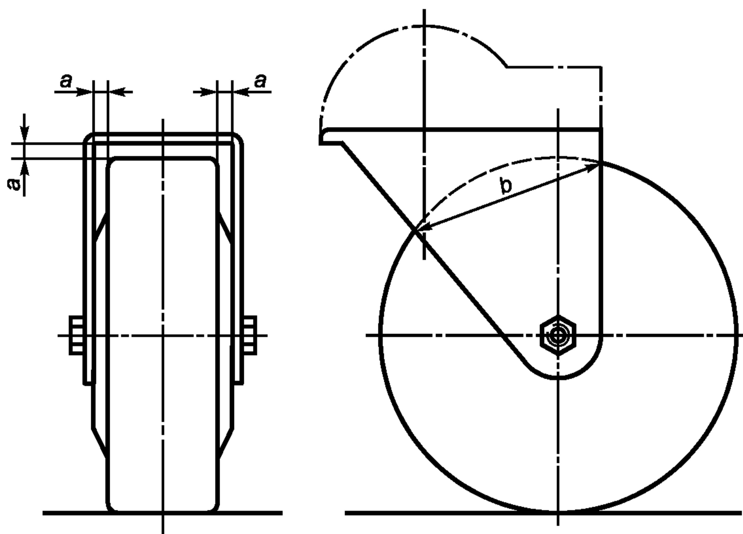
Рисунок А.15 — Пример колеса, доступного для очистки
