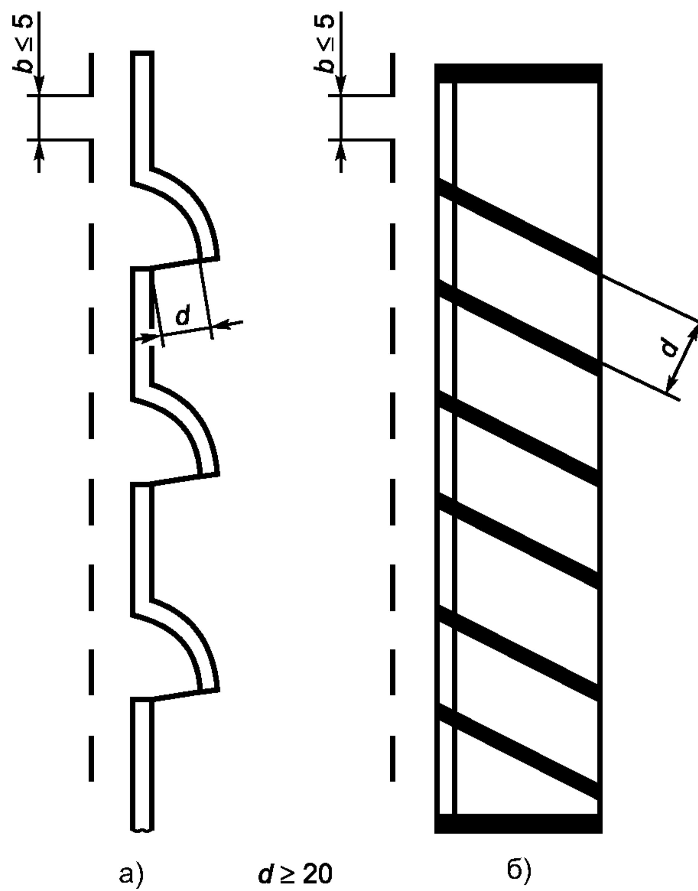
Рисунок А.16 — Вентиляционные отверстия для непищевой зоны
