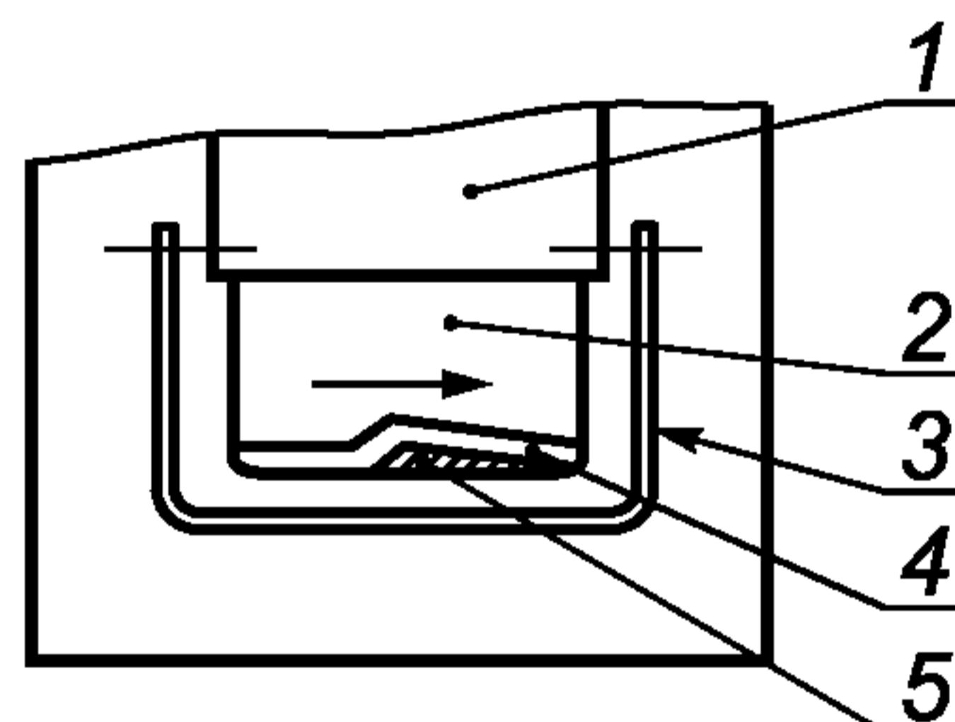
1 — открытый шибер; 2 — проем для выгрузки; 3 — направляющий желоб; 4 — вращающаяся дисковая насадка;
