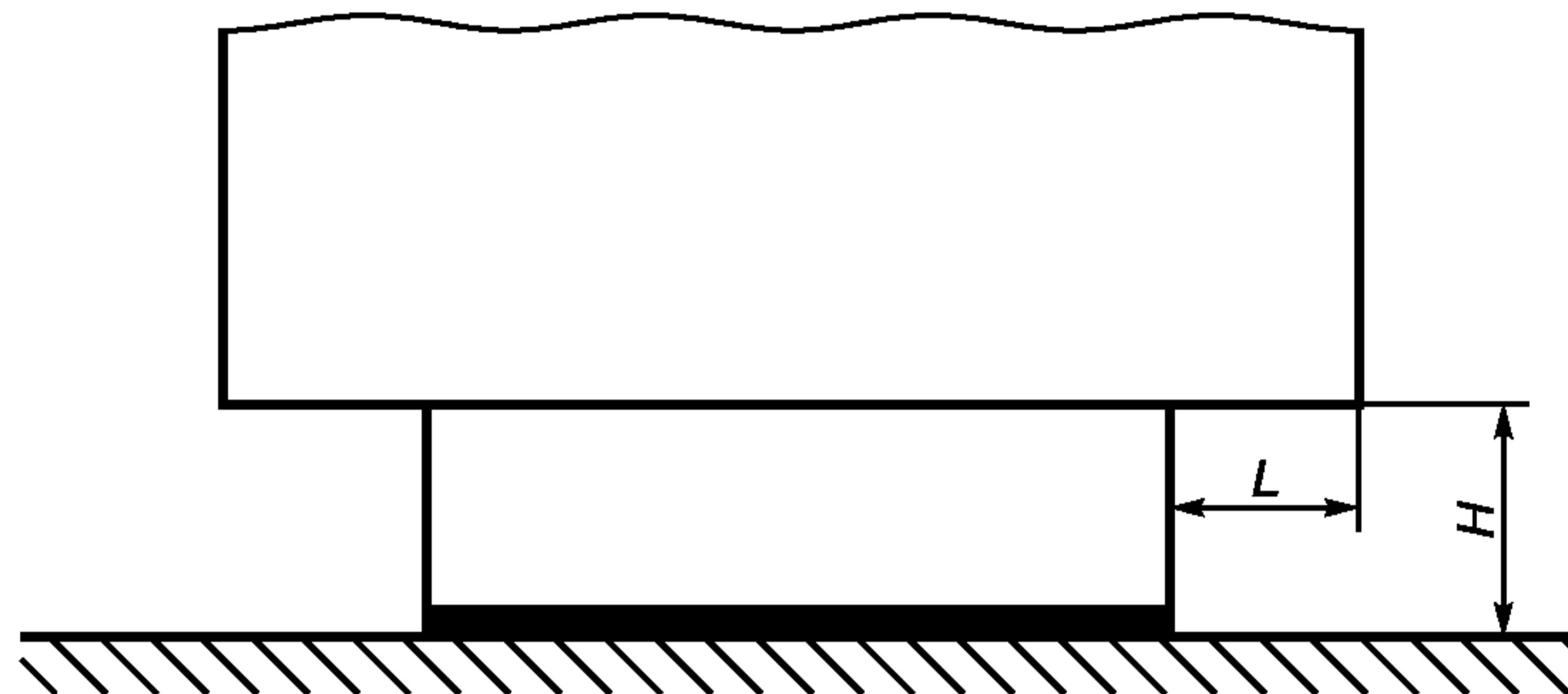
Рисунок А.14 — Размещение машины на полу с возможностью доступа в пространство  $L$
