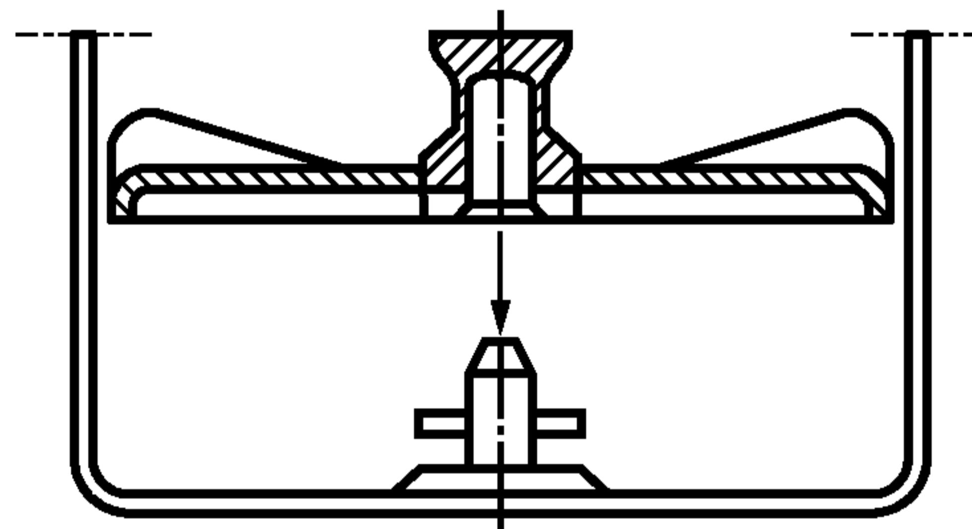
Рисунок 6 — Пример конструкции вращающейся дисковой насадки
