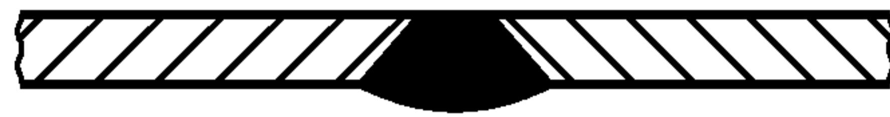
Рисунок А.5 — Пищевая зона. Сварка с формированием непрерывного шва
