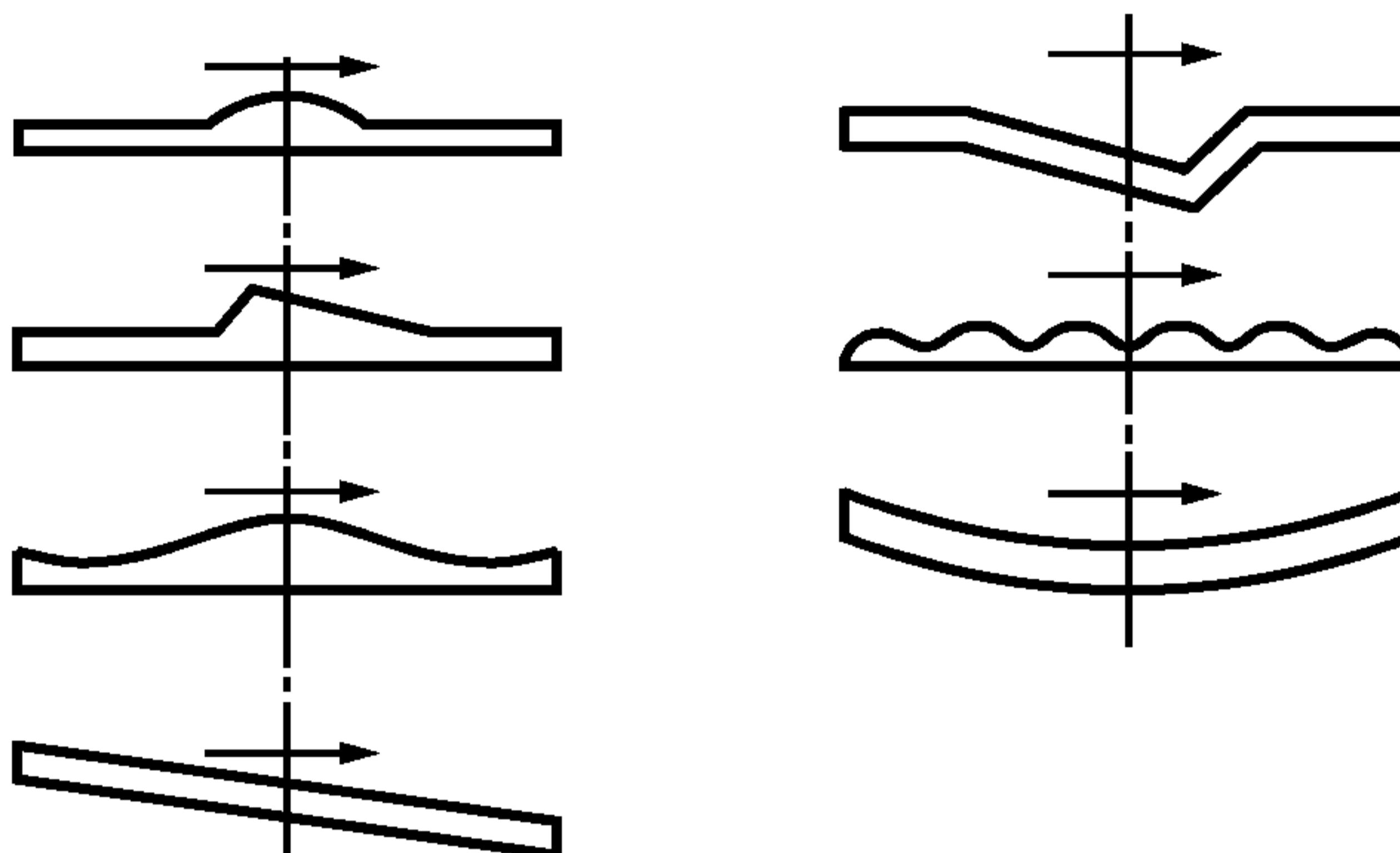
Рисунок 2 — Примеры съемных вращающихся дисковых насадок различной конфигурации
