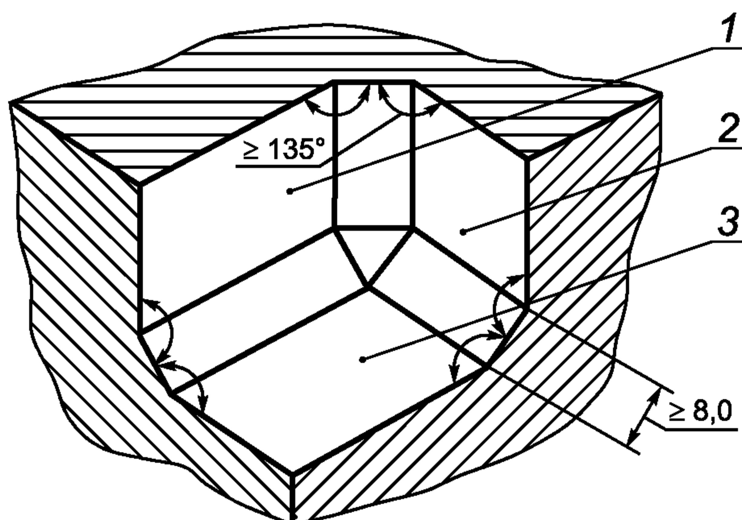
1 — поверхность 1; 2 — поверхность 2; 3 — поверхность 3
