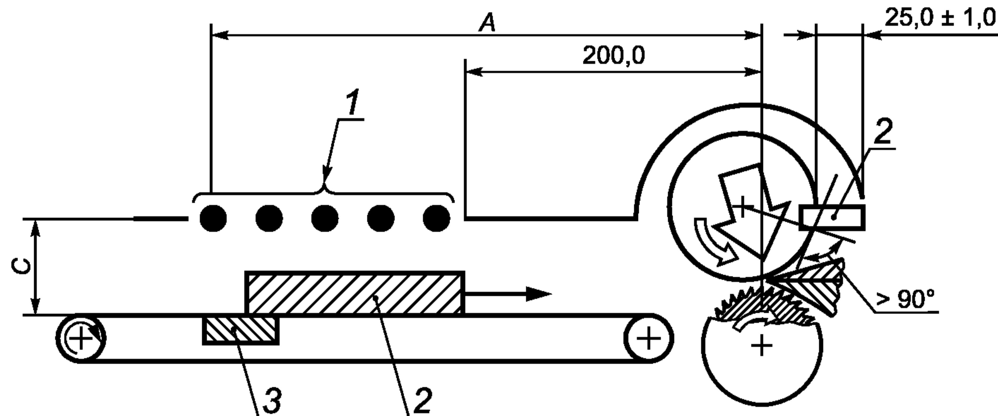
*А — свободное от защиты пространство; С — зазор между продуктом и световыми датчиками (каскад световых или предохранительных экранов); 1 — световые датчики (каскад световых или предохранительных экранов); 2 — продукт; 3 — защитная предохранительная планка*
