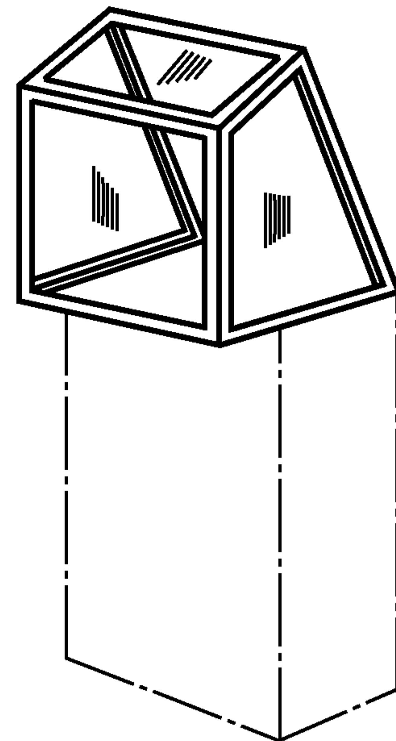
Рисунок 12 — Пример защитного ограждения, предотвращающего доступ персонала к зубчатому барабану с трех сторон
