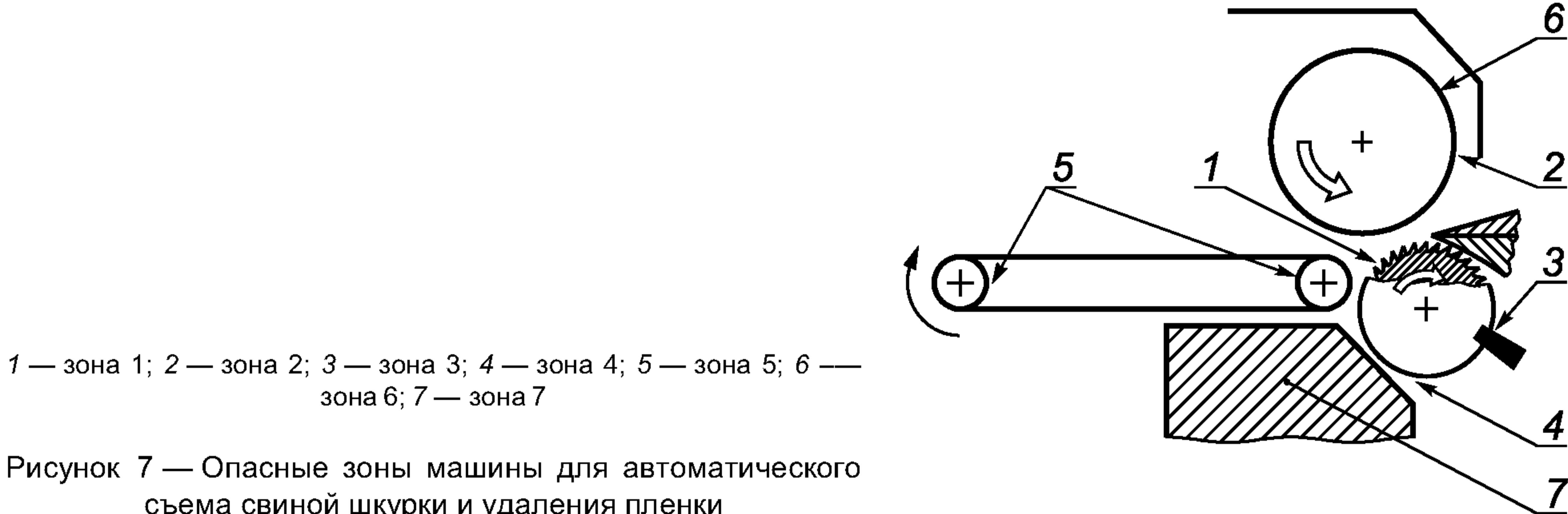
Рисунок 7 — Опасные зоны машины для автоматического съема свиной шкурки и удаления пленки
