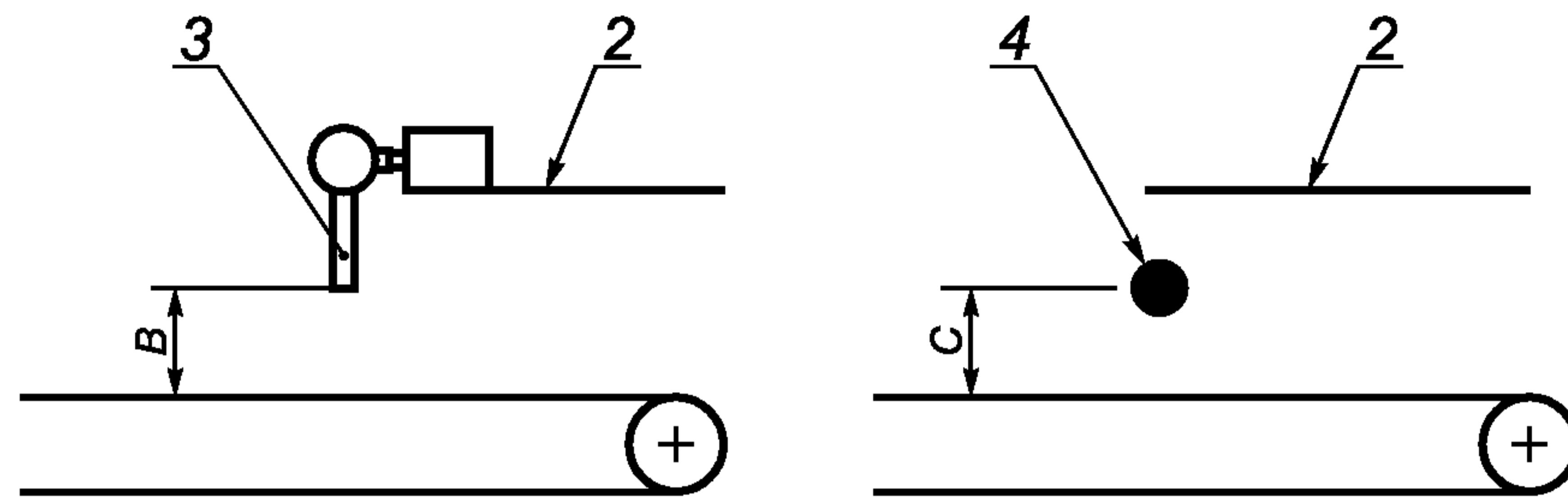
*B — зазор между продуктом и защитной планкой, включая контрольное расстояние до передней кромки защиты или защитной планки; С — зазор между продуктом и одним или более световыми датчиками; 2 — стационарное защитное ограждение; 3 — защитная планка; 4 — световой датчик*
