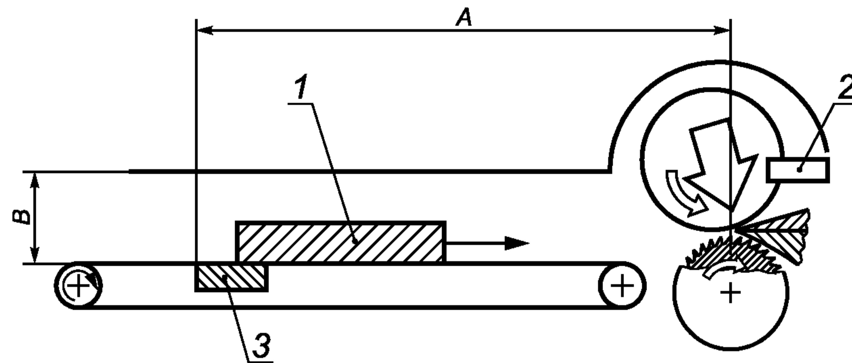
*A — свободное от защиты пространство; В — зазор между продуктом и защитной планкой, включая контрольное расстояние до передней кромки защиты или защитной планки; 1 — продукт; 2 — очищающая гребенка; 3 — защитная планка*
