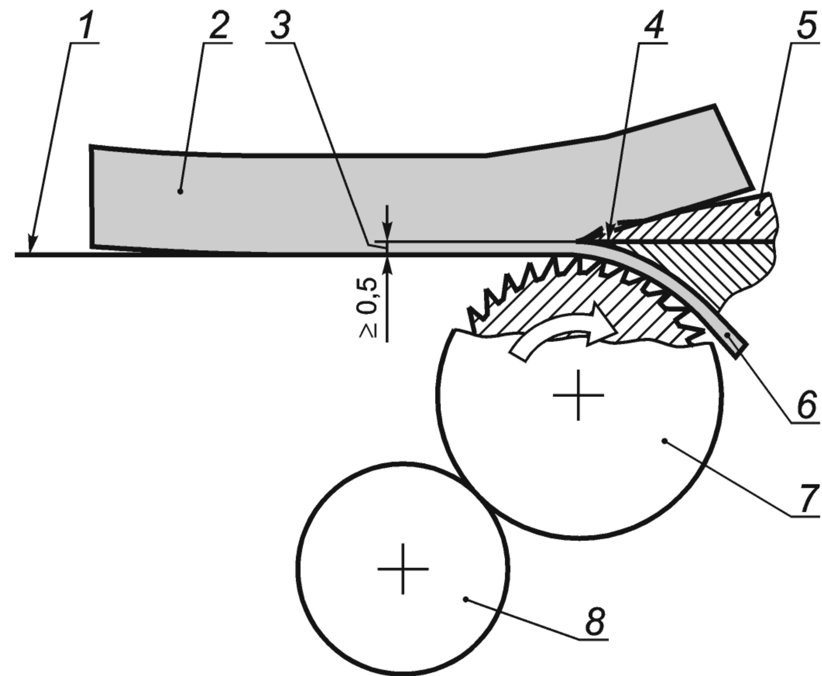
1 — стол подачи; 2 — продукт; 3 — толщина среза не более 0,5 мм; 4 — нож; 5 — держатель ножа; 6 — пленка; 7 — транспортирующий вал; 8 — очищающий вал
