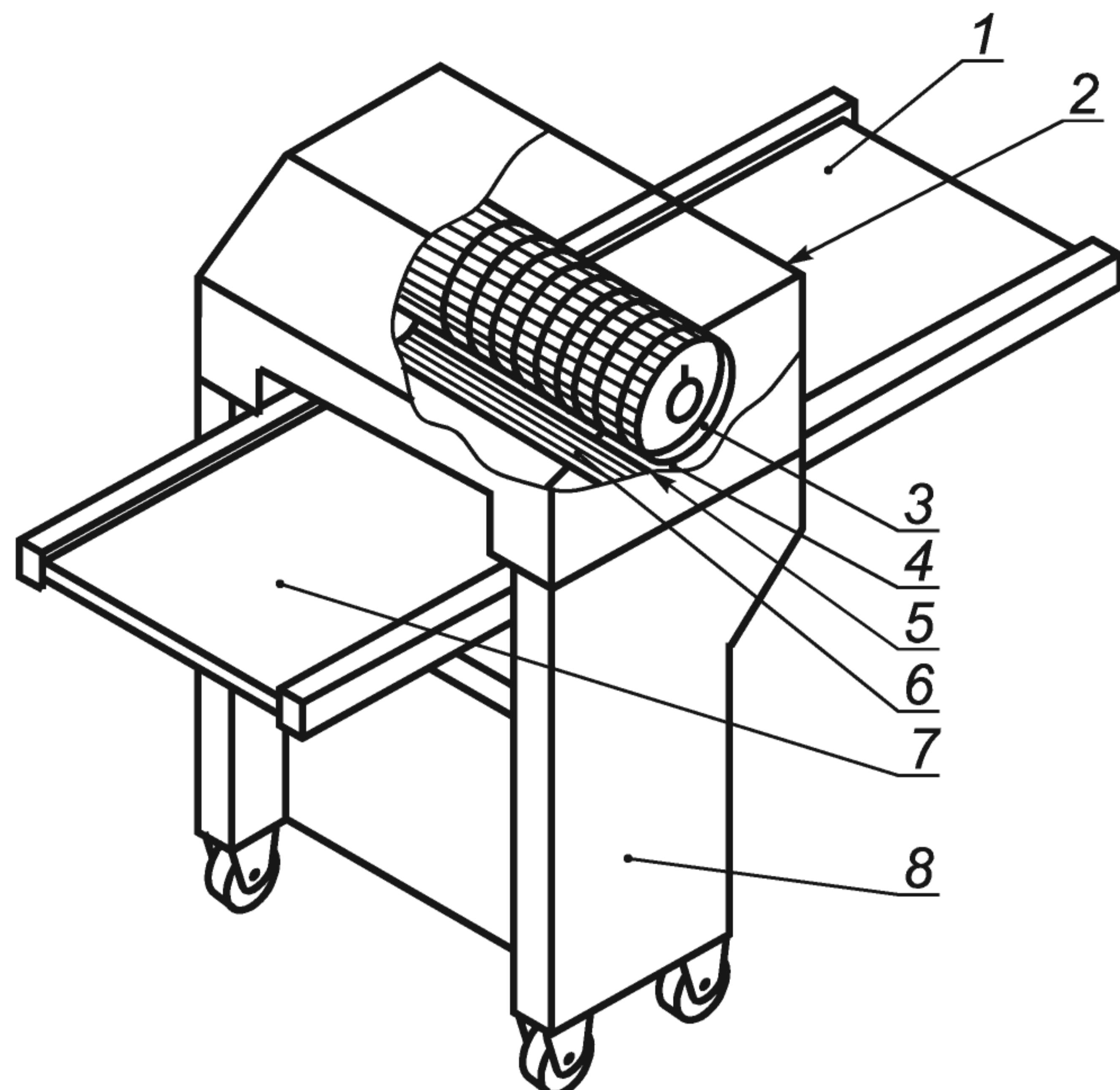
1 — разгрузочный транспортер; 2 — съемное защитное ограждение; 3 — прижимные валы; 4 — держатель ножа; 5 — нож; 6 — зубчатый или транспортирующий барабан; 7 — питающий транспортер; 8 — двигатель
