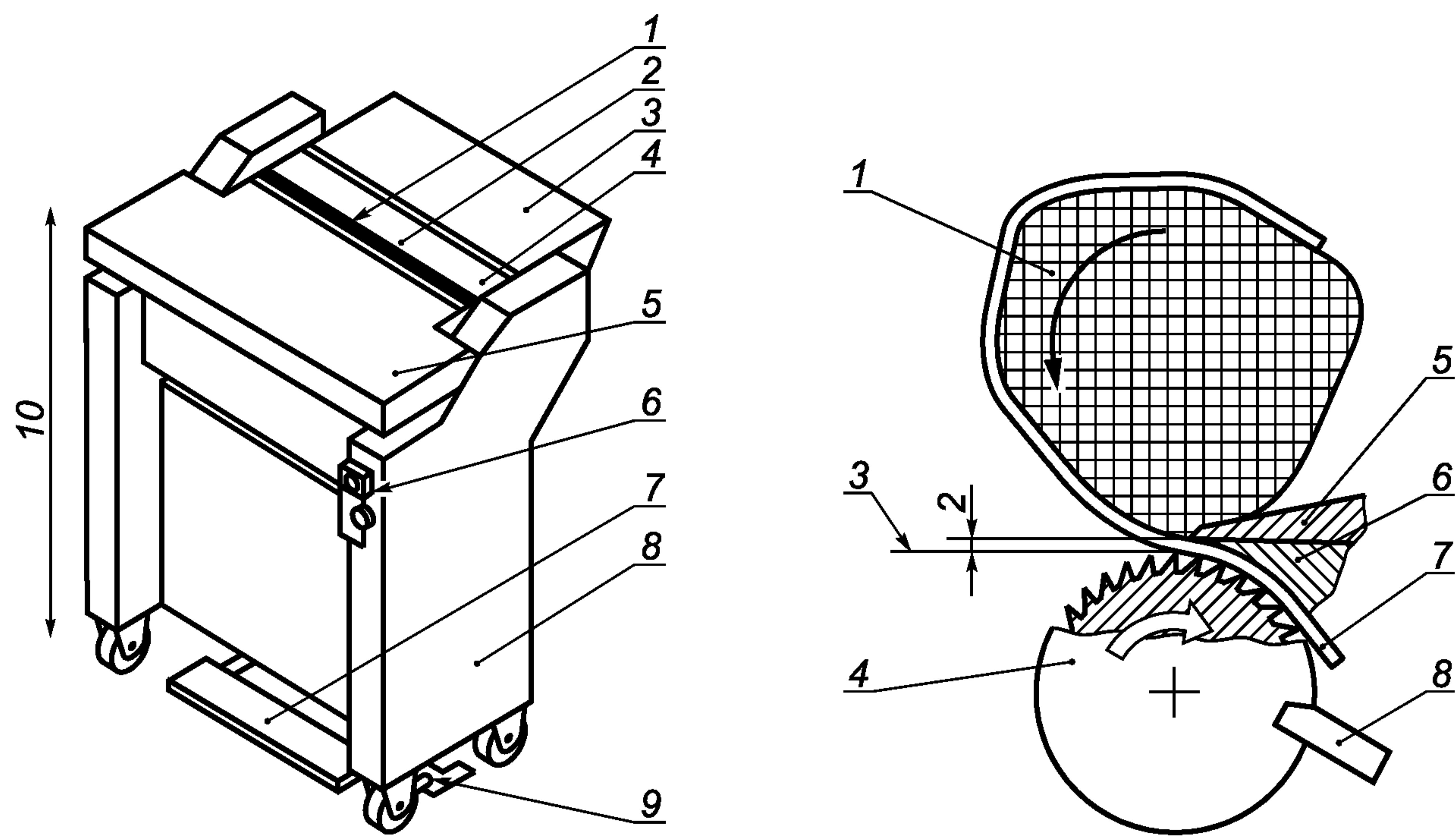
1 — зубчатый барабан; 2 — нож; 3 — стол разгрузки; 4 — держатель ножа; 5 — стол подачи; 6 — выключатель ON/OFF; 7 — ножной выключатель; 8 — двигатель; 9 — блокировочное устройство; 10 — высота стола
