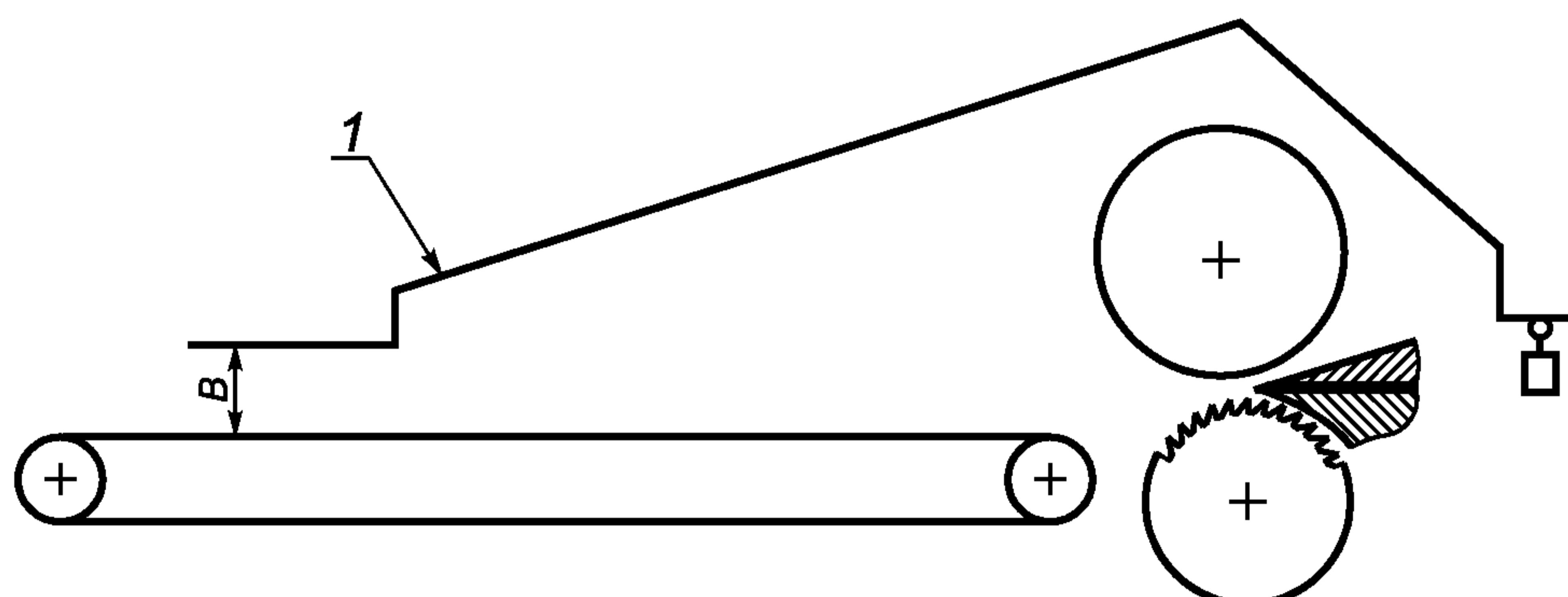
$B$  — зазор между продуктом и защитной планкой, включая контрольное расстояние до передней кромки защиты или защитной планки; 1 — съемное защитное ограждение
