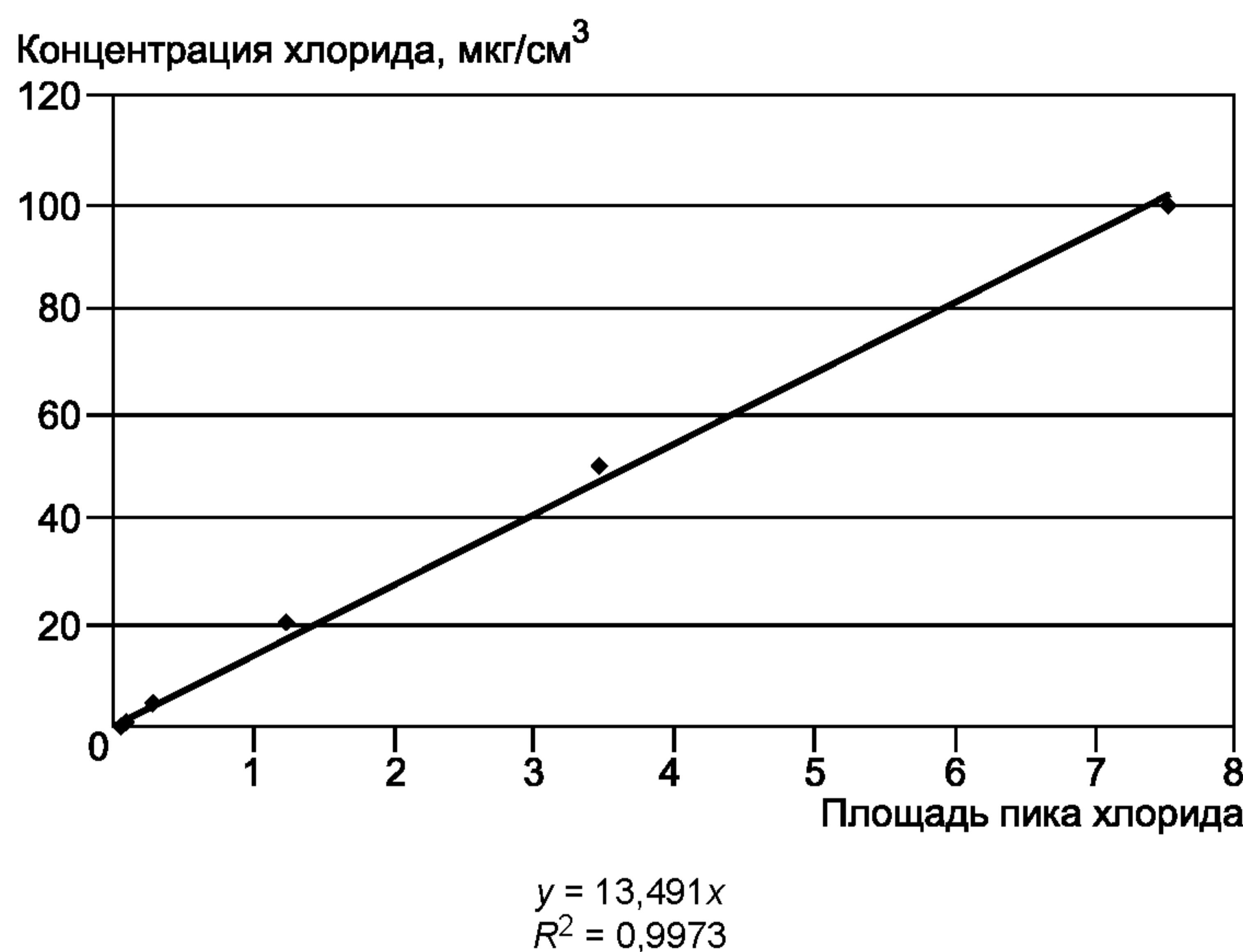
Рисунок 3 — Типичный калибровочный график хлорида
