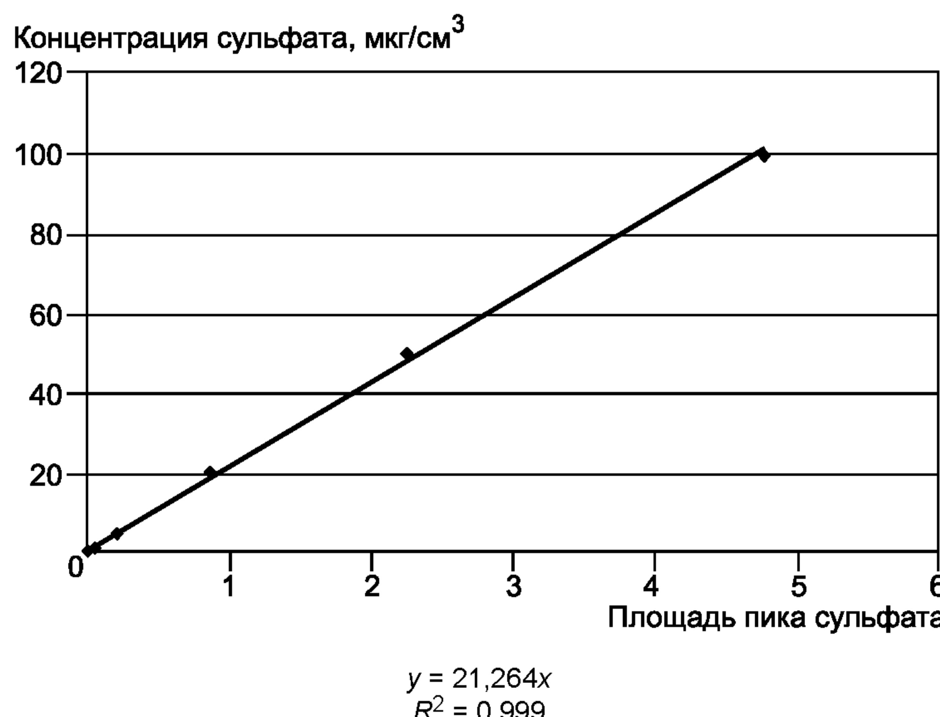
Рисунок 2 — Типичный калибровочный график сульфата
