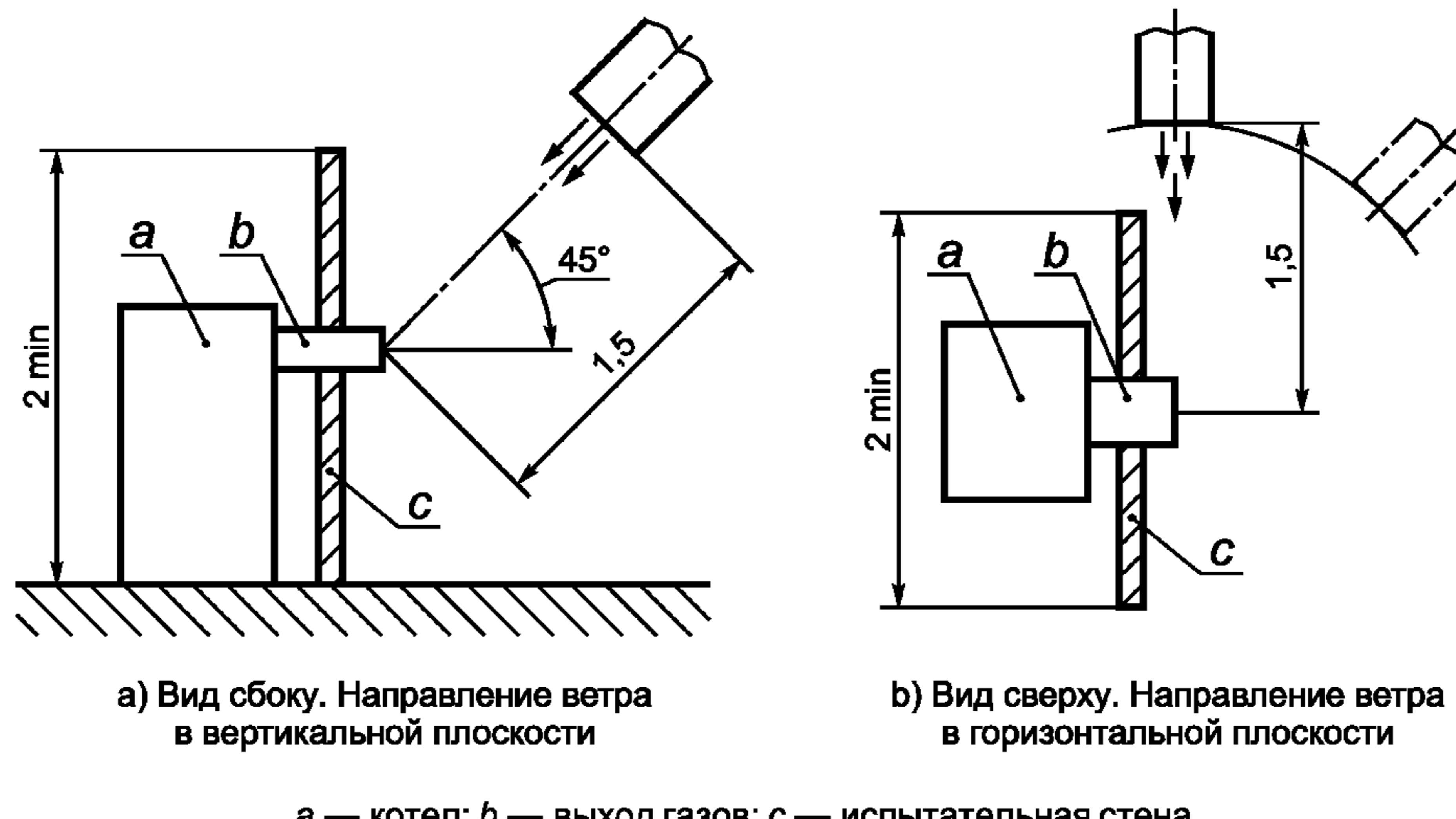
Рисунок В.1 — Расположение генератора ветра для испытания сниженных труб
