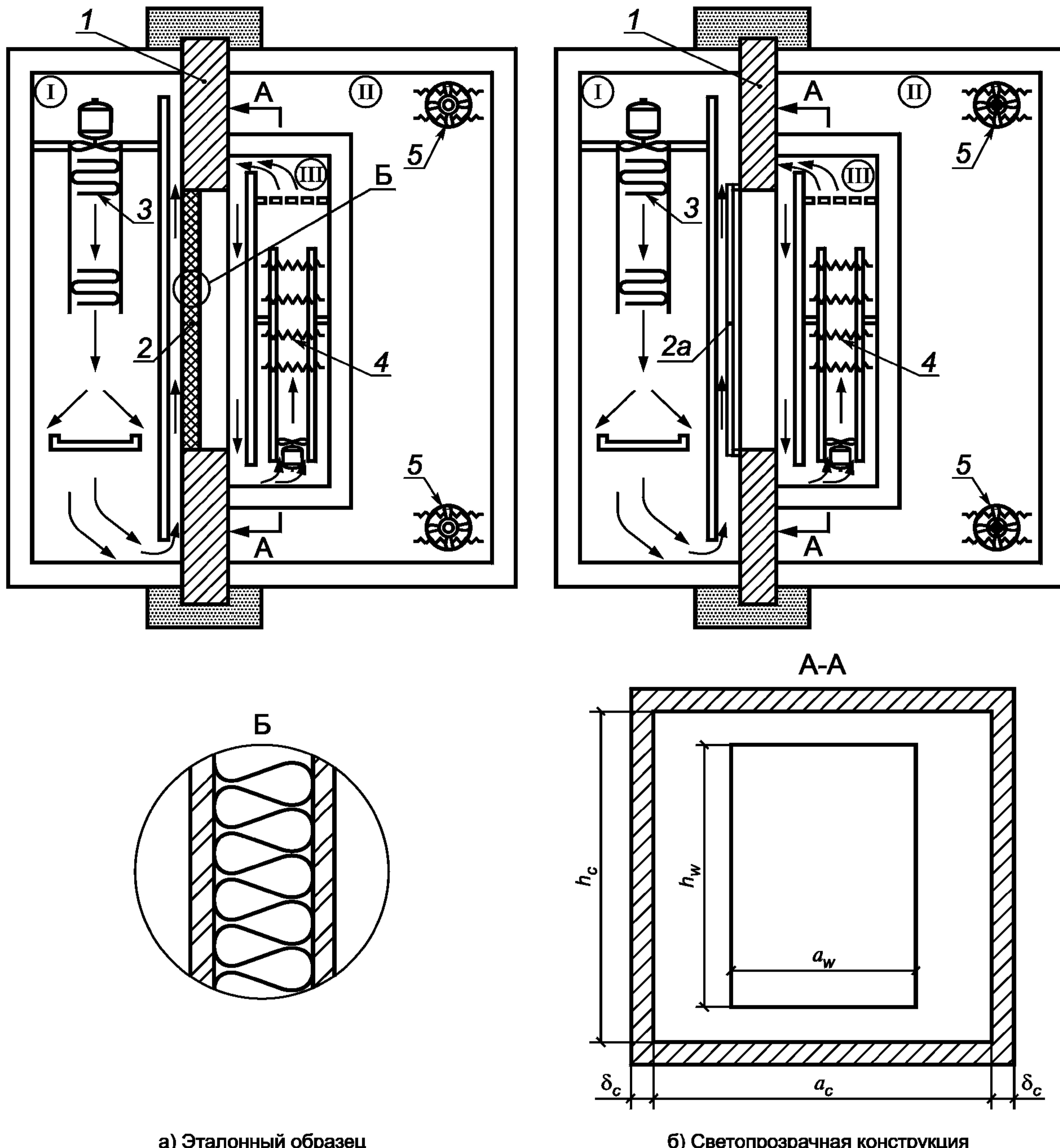
I — холодный отсек климатической камеры; II — теплый отсек климатической камеры; III — приставная камера (калориметр); 1 — ограждающая конструкция с проемом; 2 — эталонный образец; 2а — испытуемая светопрозрачная конструкция; 3 — испаритель холодильного агрегата; 4 — нагреватель калориметра; 5 — нагреватель теплого отсека
