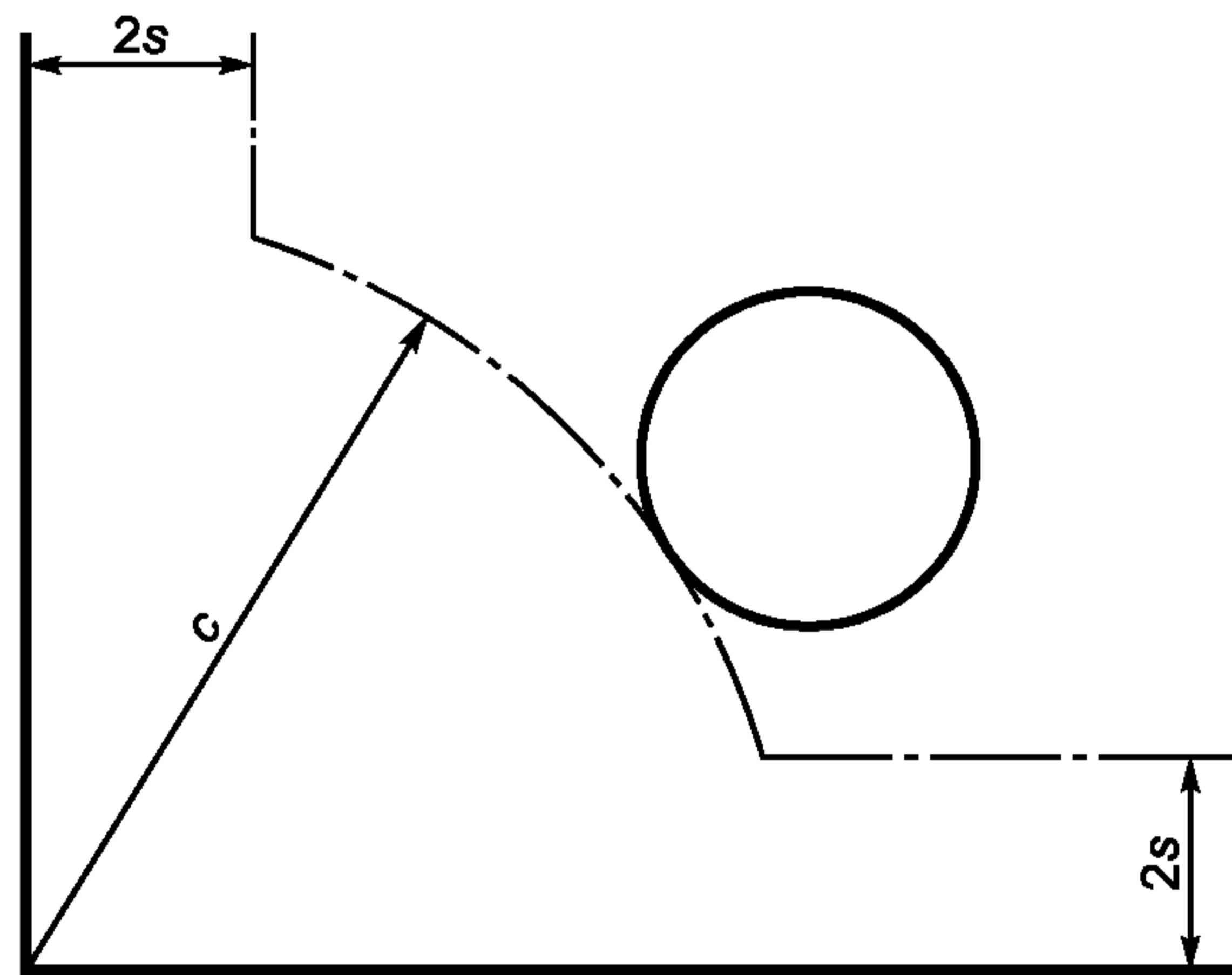
$c$  — расстояние от угла листа стекла до кромки отверстия с не менее  $6s$ , мм ( $s$  — номинальная толщина стекла, мм)
