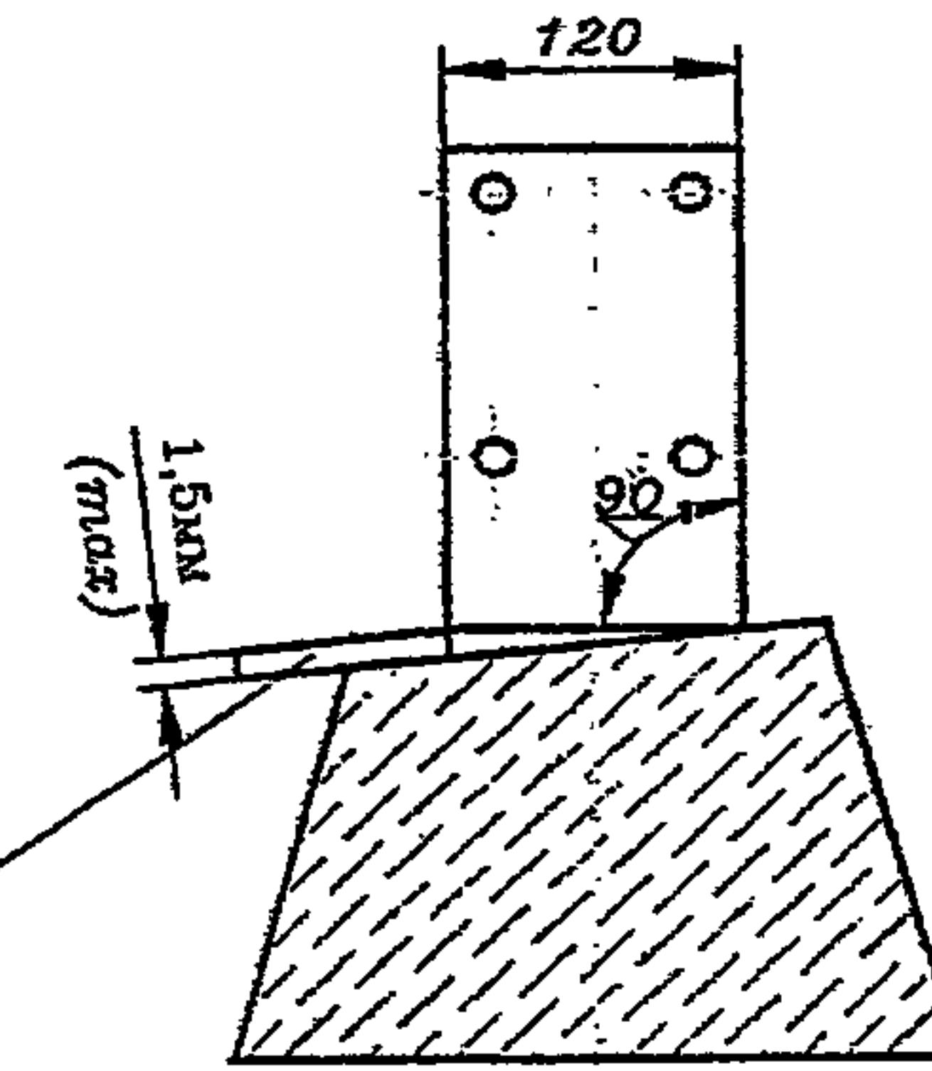
Рис. 7а Схема контроля пропеллерности подрельсовых площадок шпалы
