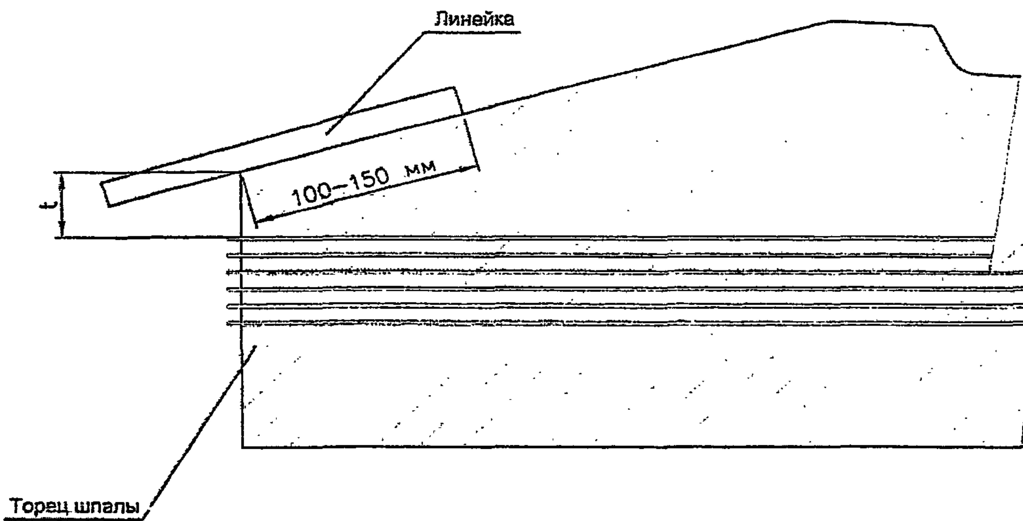
Рис. 11 Схема определения толщины  $t$  защитного слоя бетона
