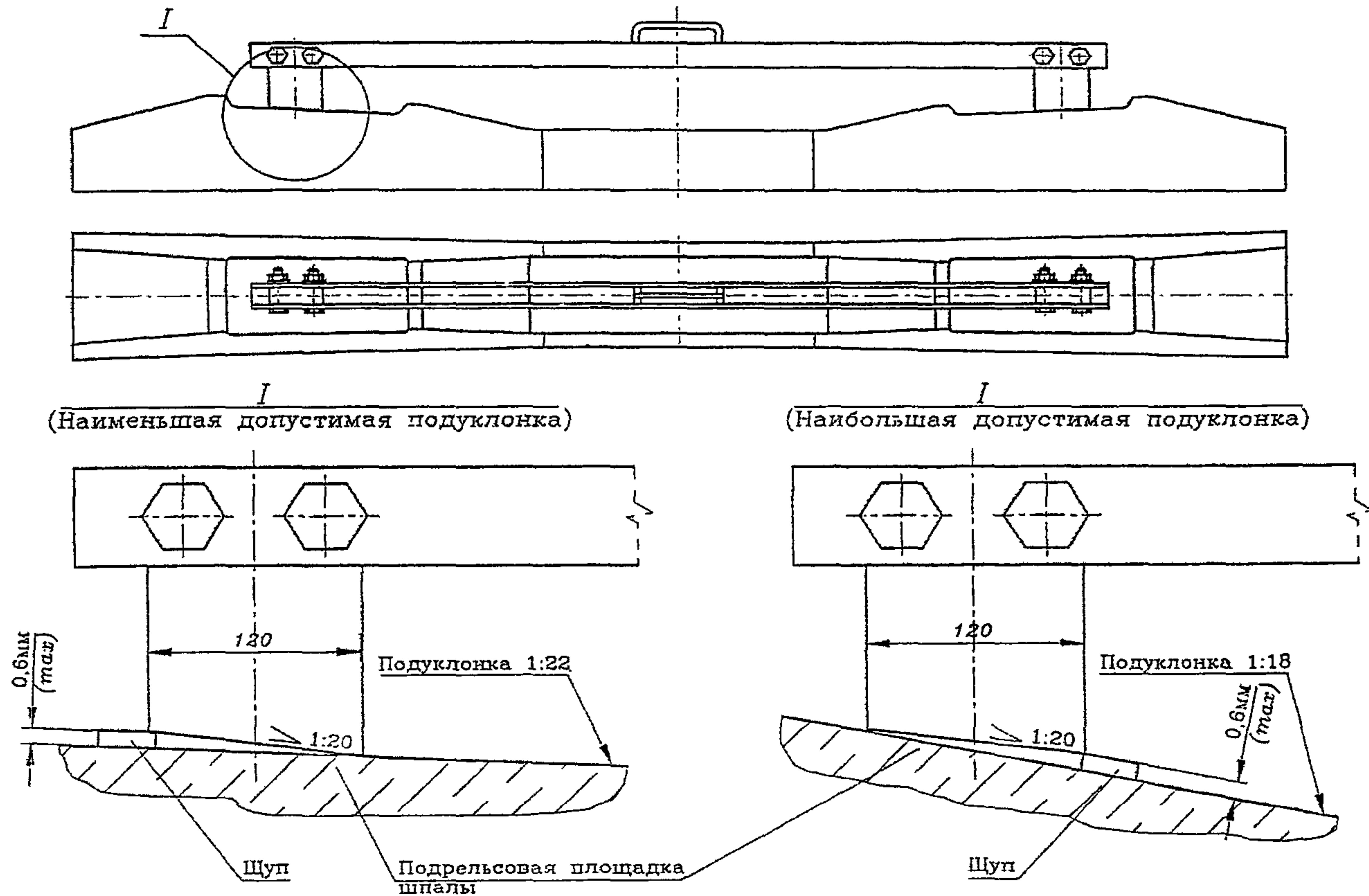
Рис. 5 Схема контроля подуклонки подрельсовых площадок шпалы
