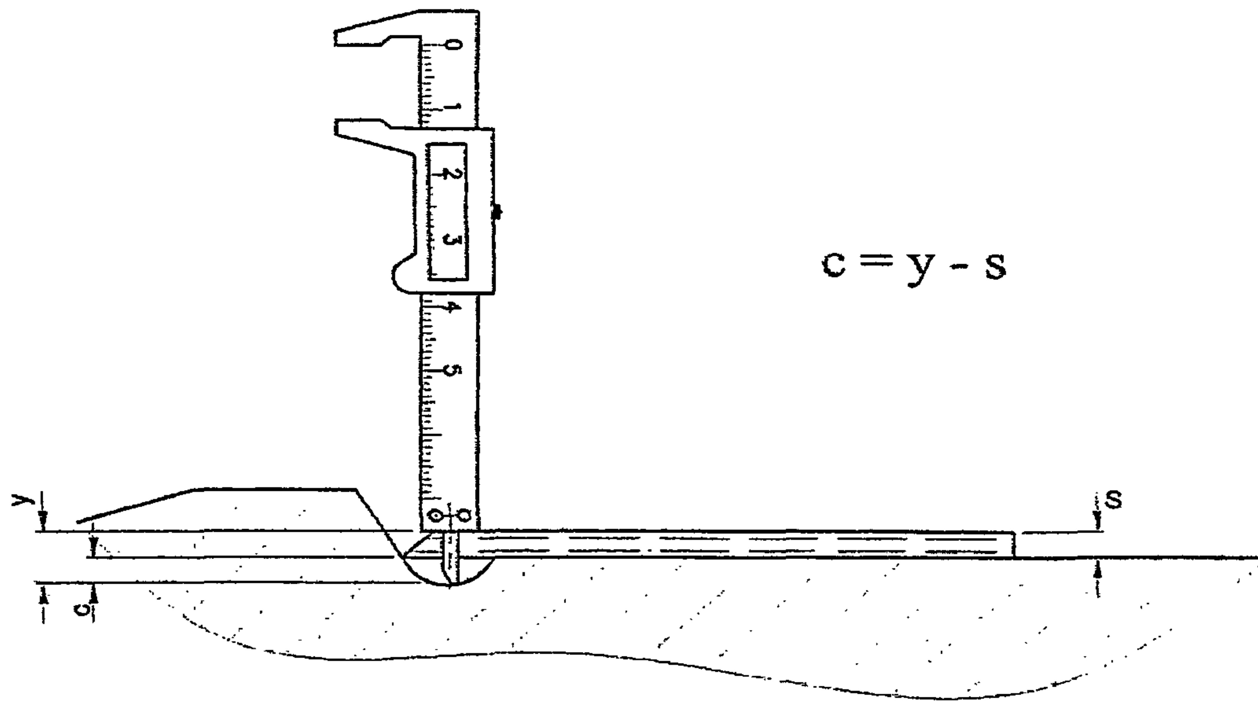
Рис. 8 Схема контроля глубины С выкружки подрельсовой площадки
