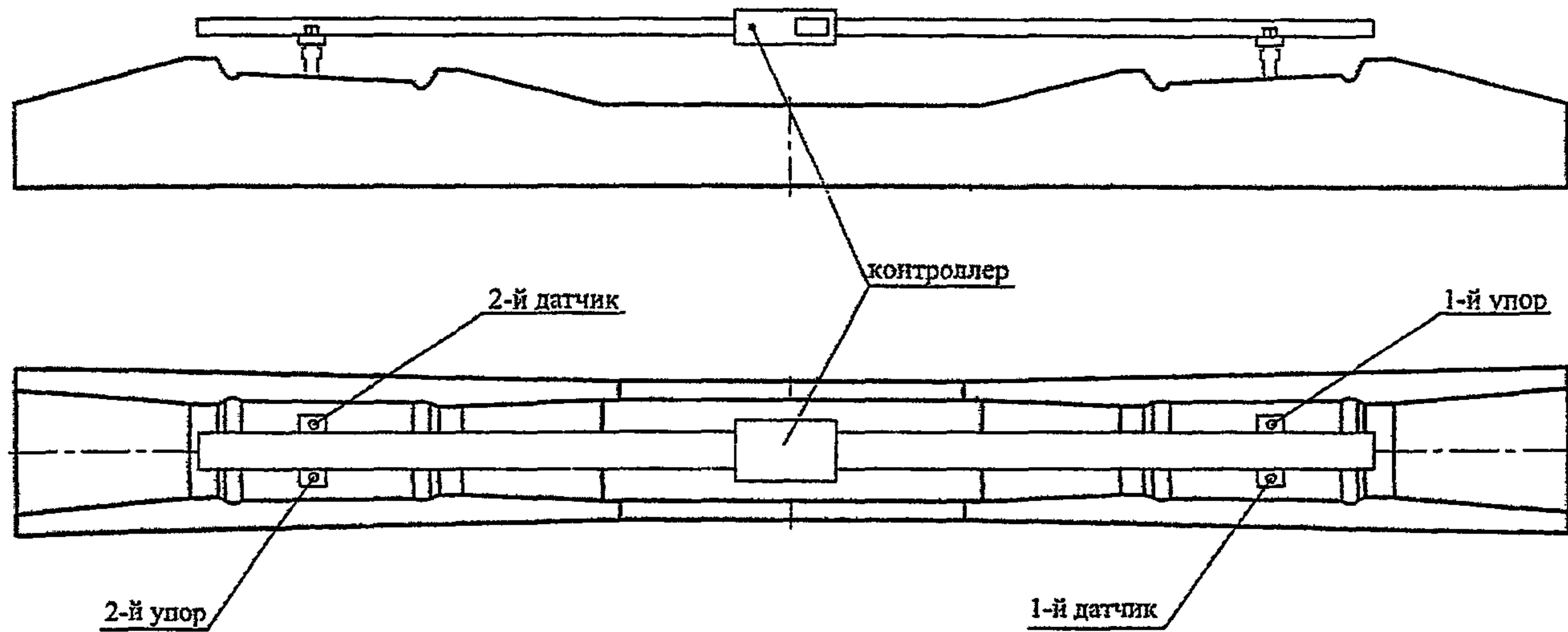
Рис. 76 Схема контроля пропеллерности подрельсовых площадок прибором ПКП-01Ш
