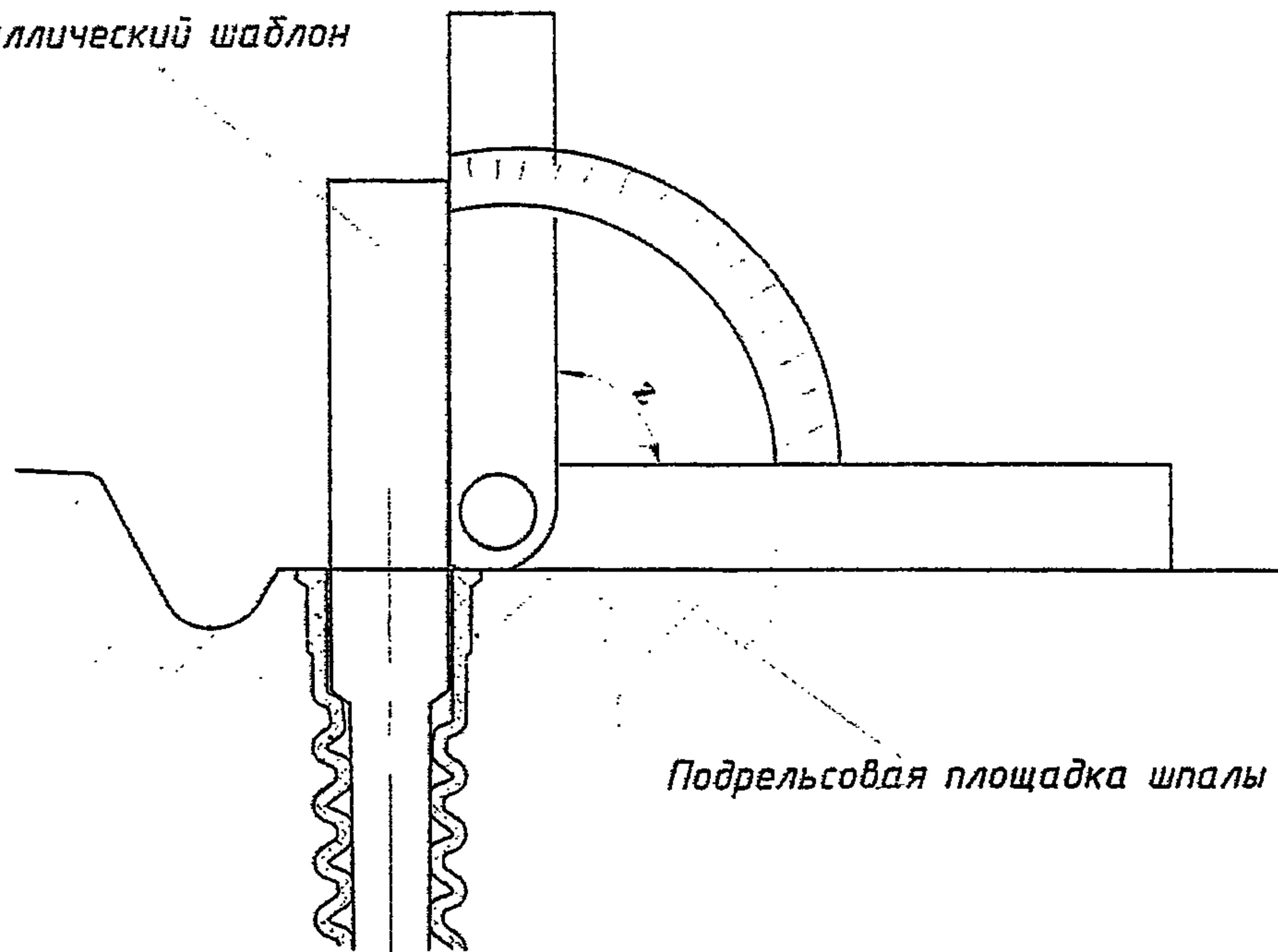
Рис. 9 Схема контроля угла наклона оси дюбеля относительно перпендикуляра к плоскости подрельсовой площадки
