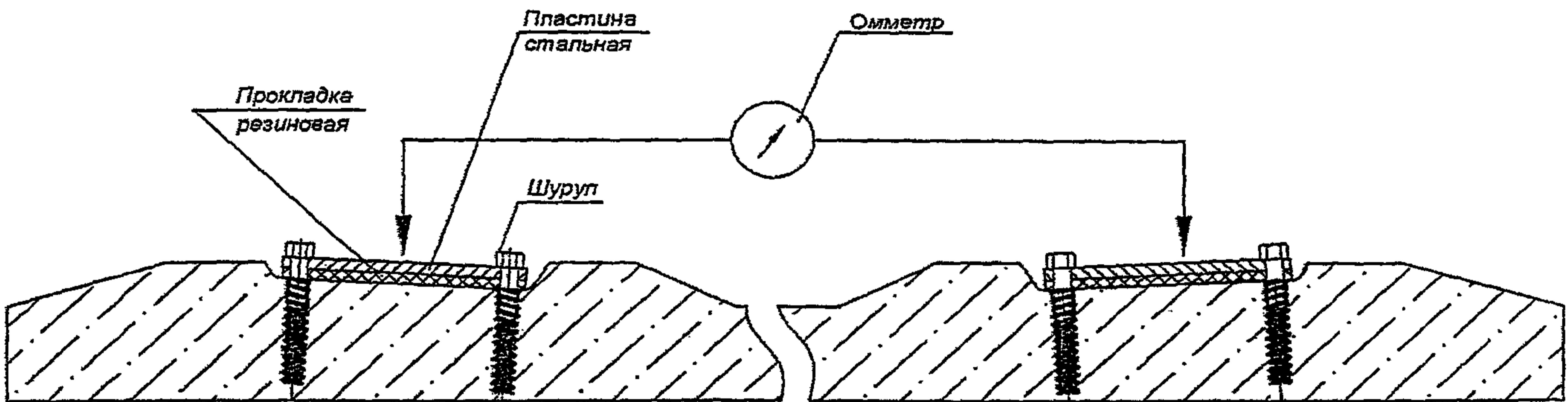
Рис. 12 Схема измерения электрического сопротивления шпалы:
