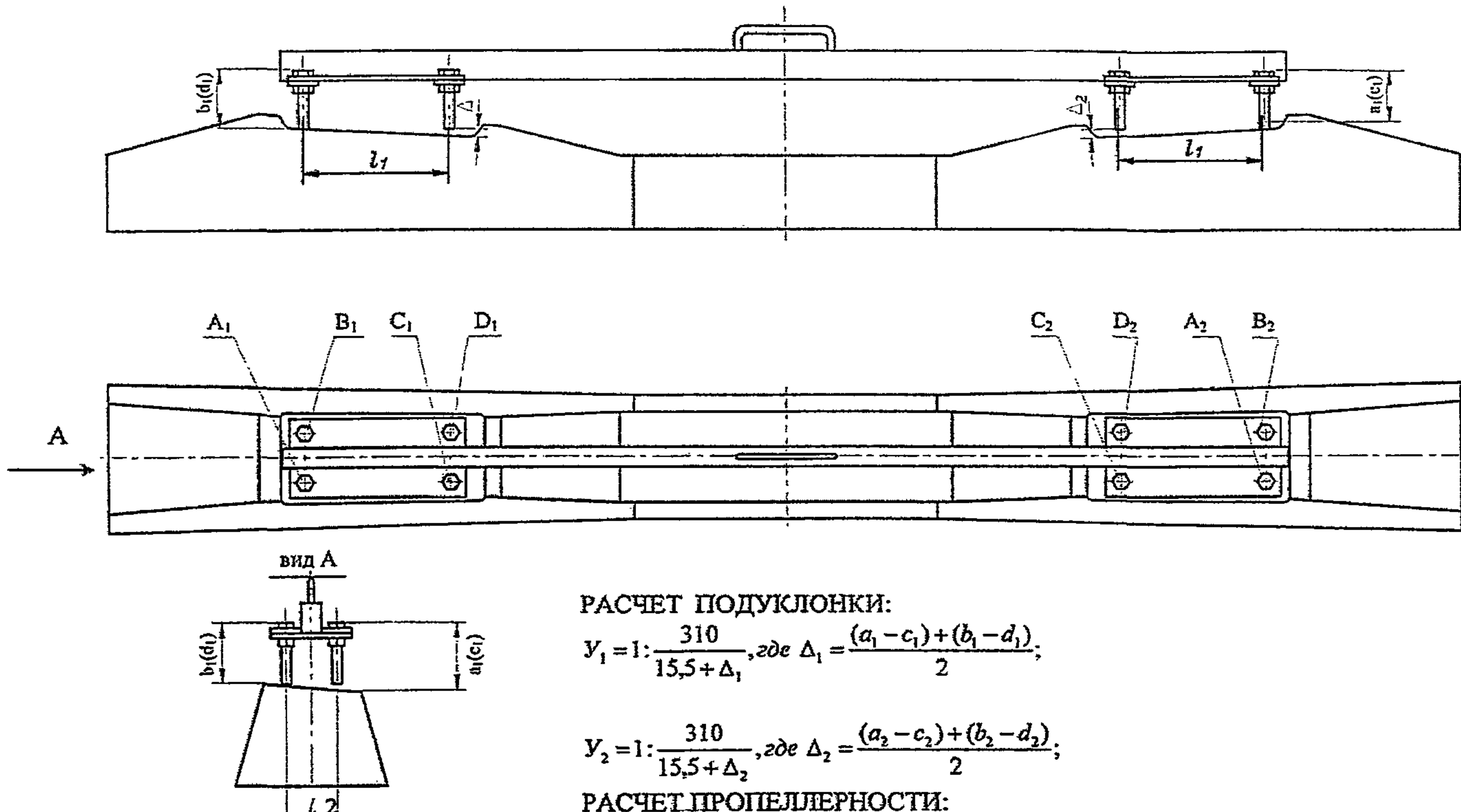
Рис. 6а Схема контроля подуклонки и пропеллерности подрельсовых площадок индикатором БП 094/1
