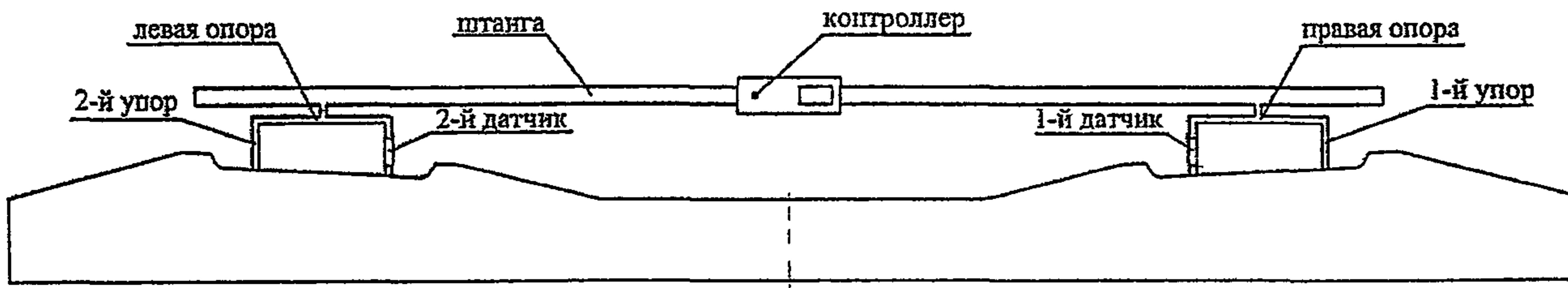
Рис. 6б Схема контроля подуклонки подрельсовых площадок прибором ПКУ-01Ш
