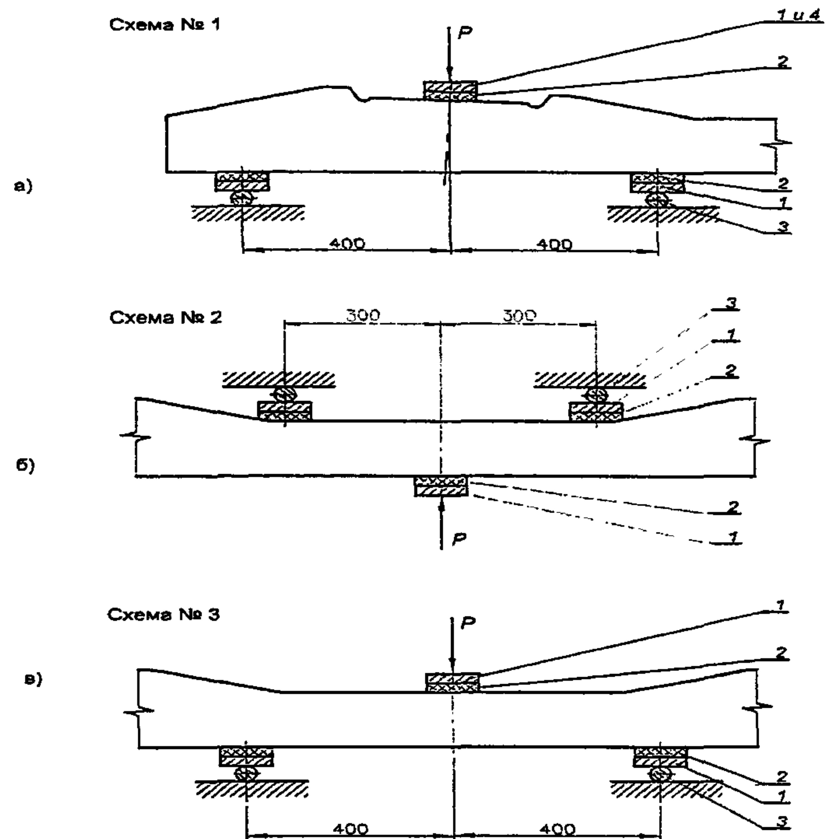
Рис. 10 Схемы испытаний шпал на трещиностойкость
