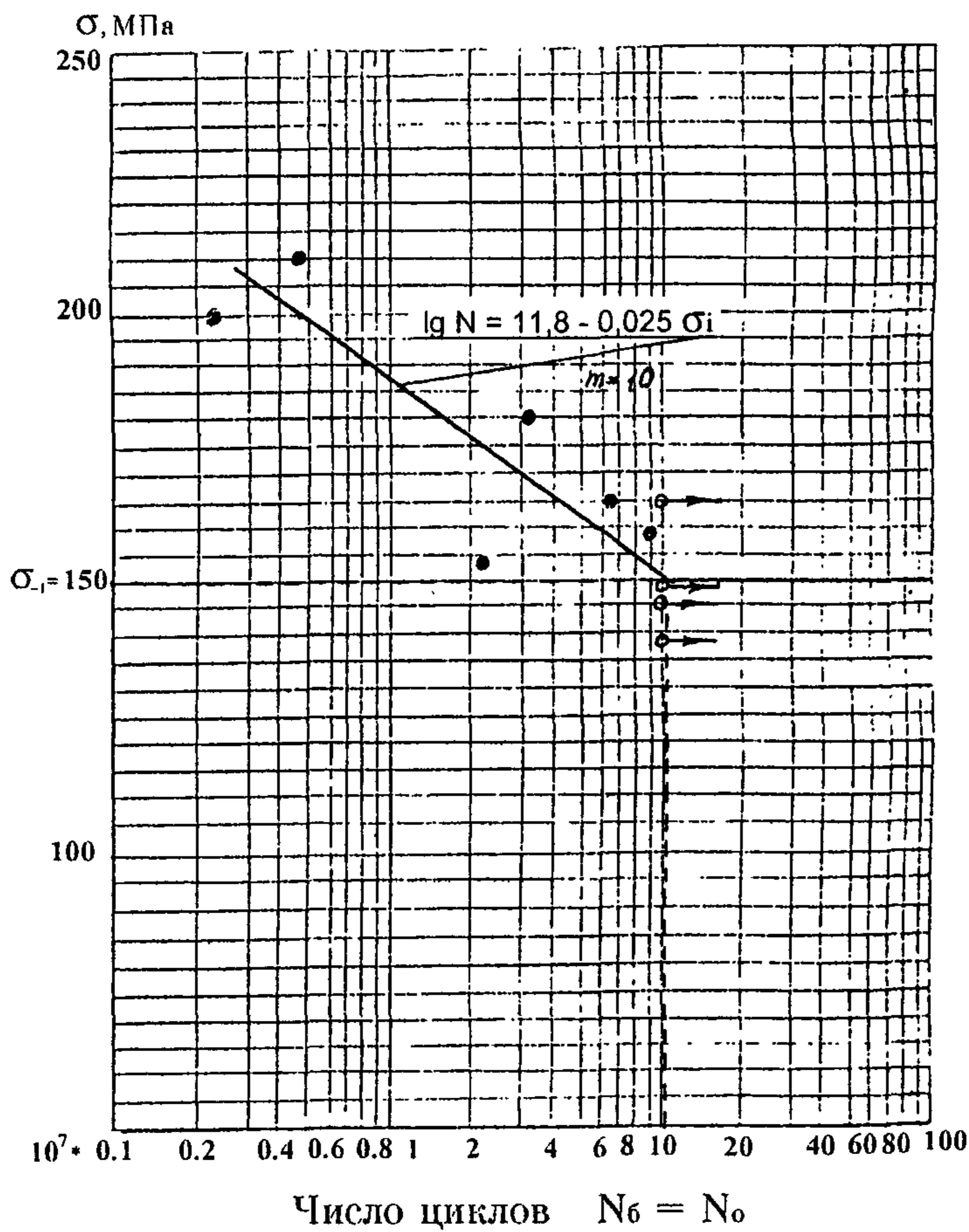
Рисунок Б.1 – Пример построения КУ по результатам испытаний на усталость оси КП
