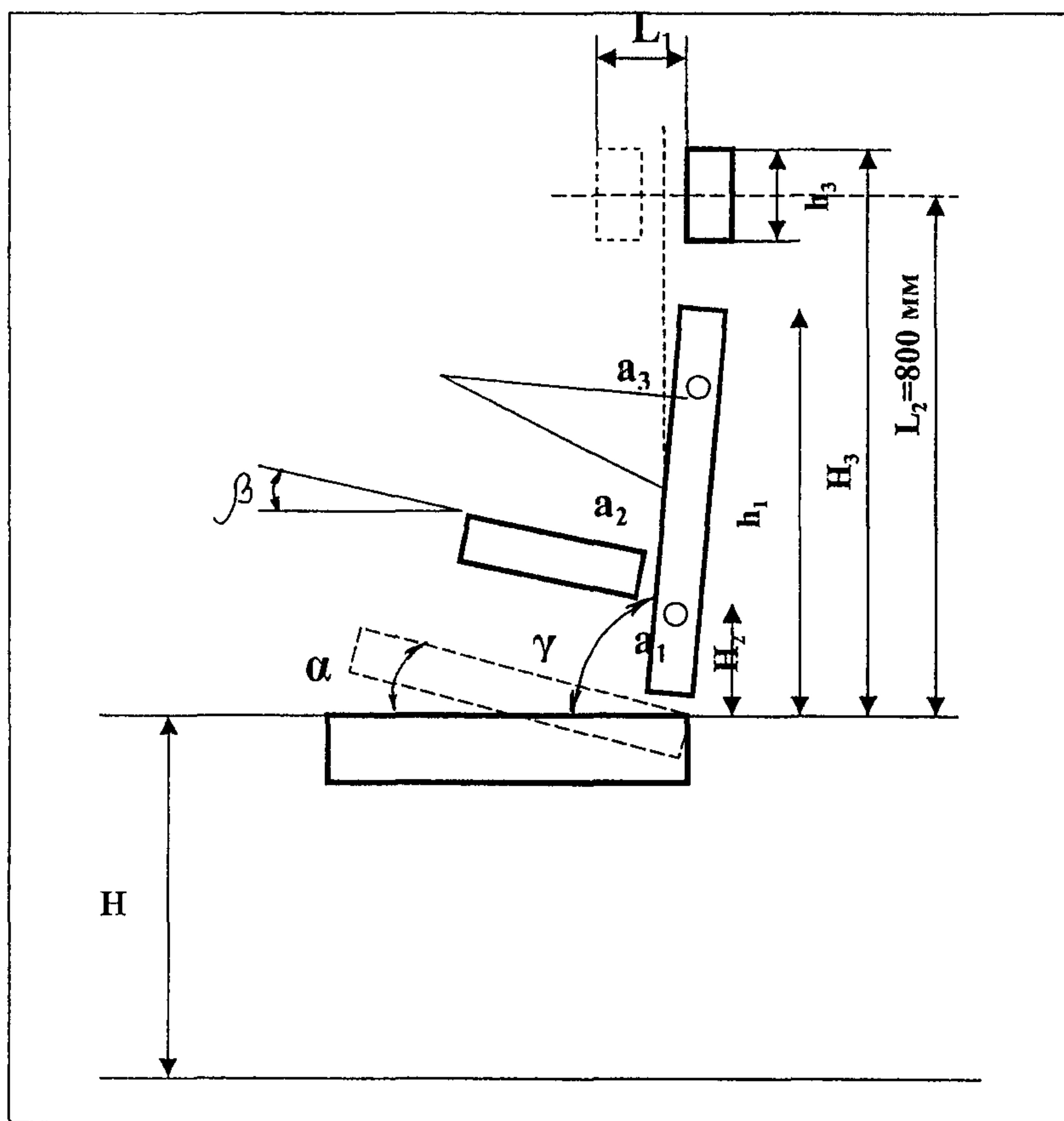
Рис.1. Конструктивные параметры кресла (вид сбоку)
