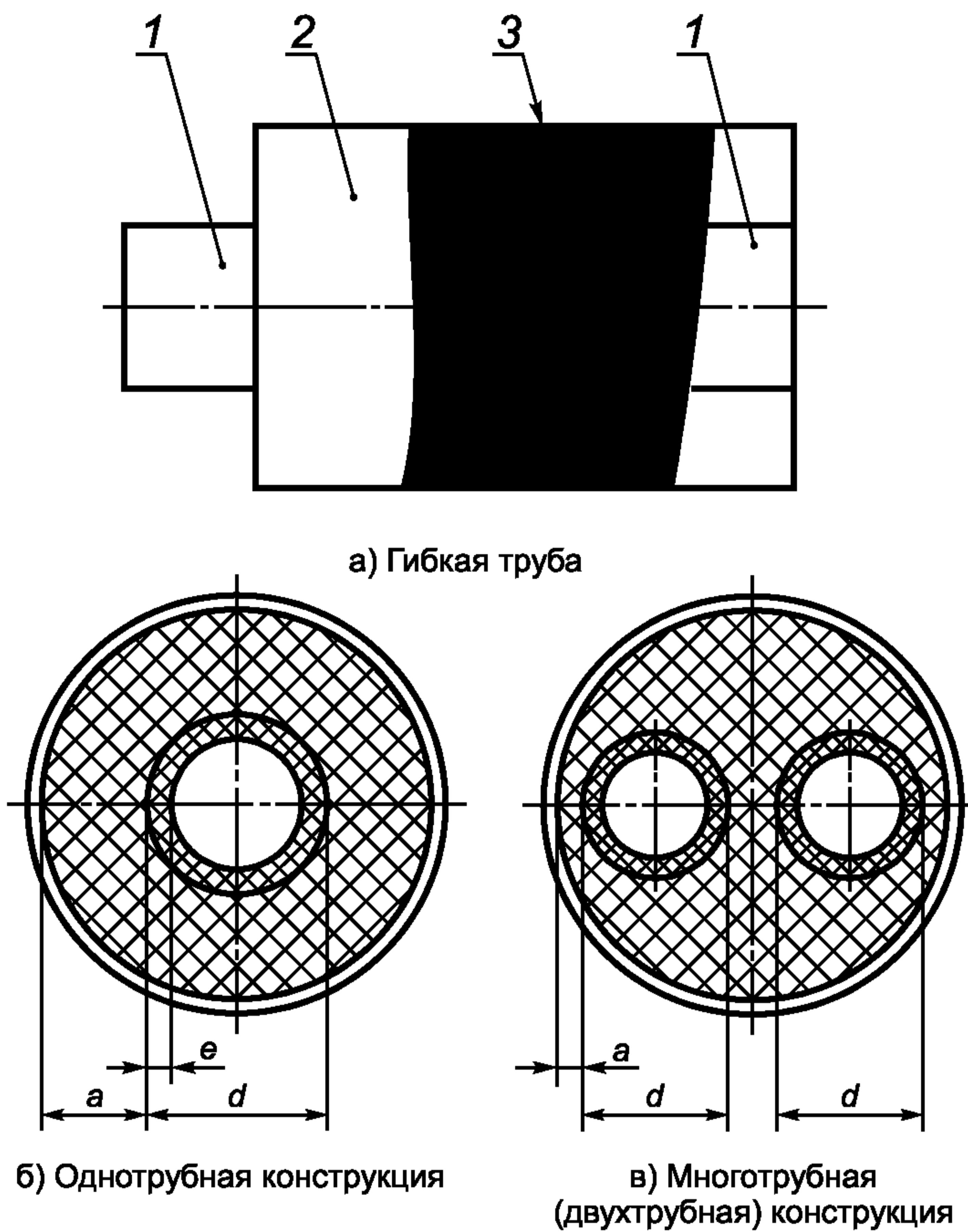
1 — напорная труба; 2 — изолирующий слой; 3 — защитная оболочка
