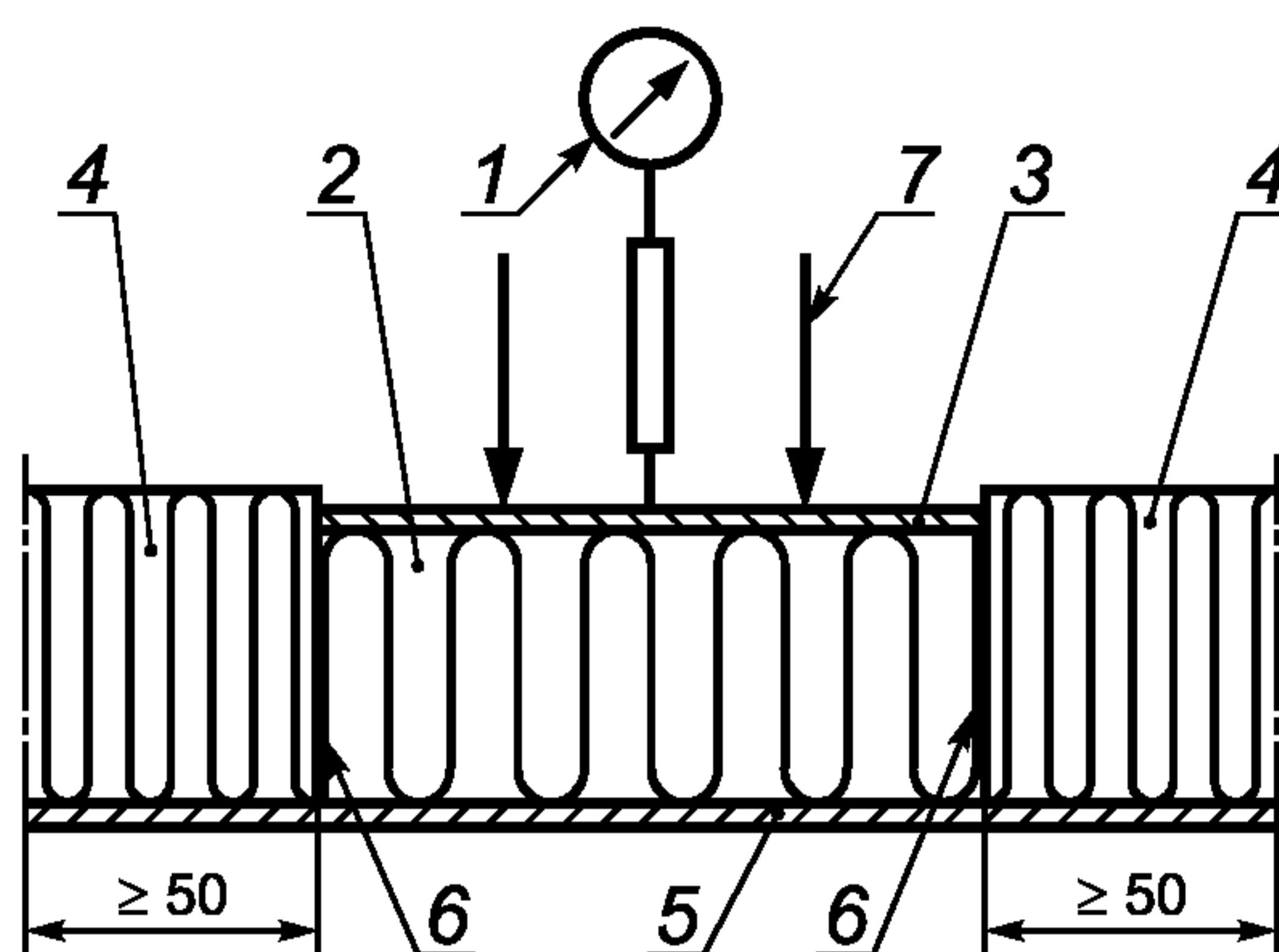
1 — средство измерений деформации образца; 2 — образец; 3 — опорная пластина для груза; 4 — боковая изоляция; 5 — нагреваемая пластина, термостатируемая с погрешностью до  $0,5^{\circ}\text{C}$ ; 6 — зазор; 7 — испытательная нагрузка
