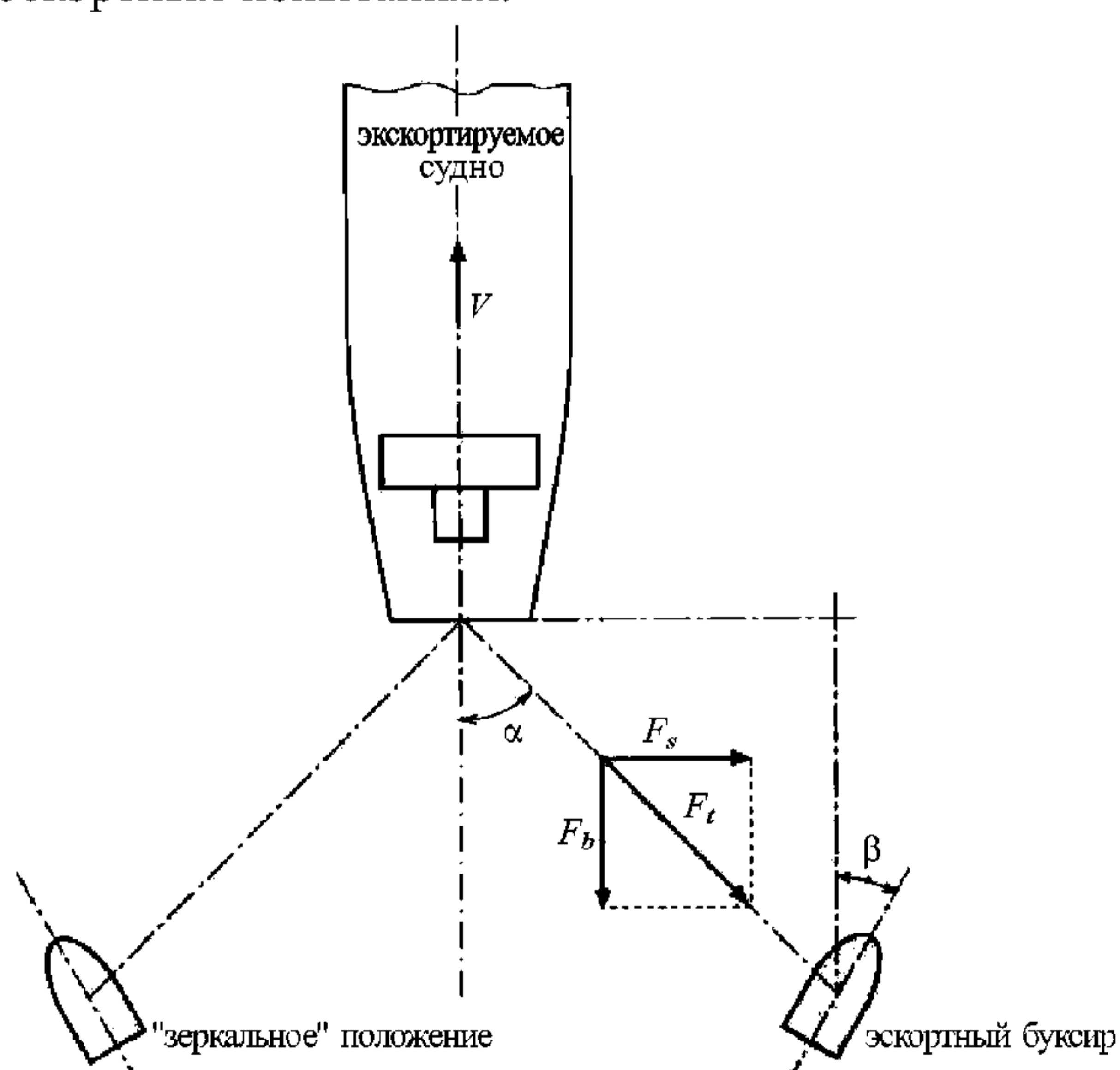
Рис. 2.1.2 Типовая схема эскортных операций:
