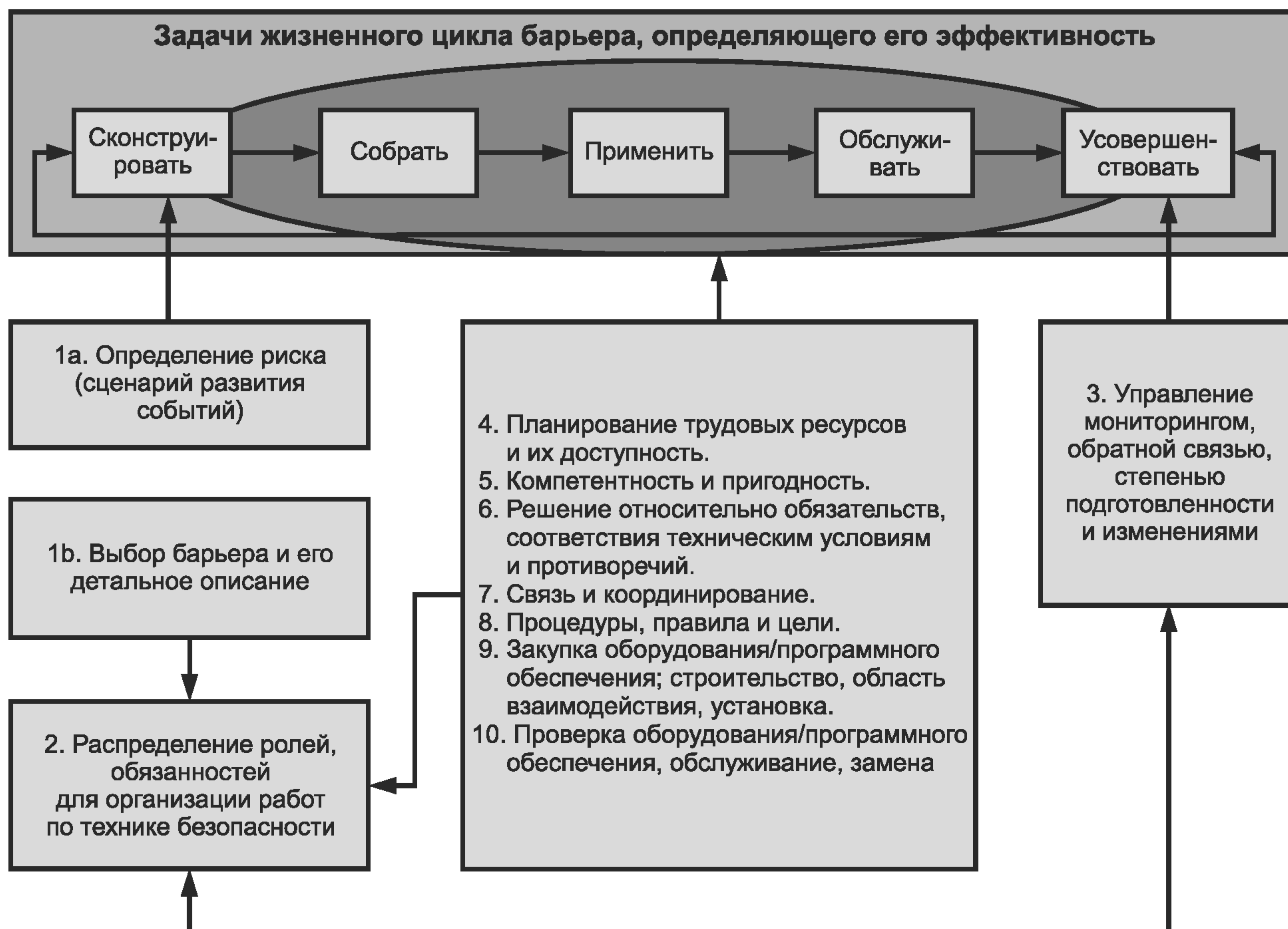
Рисунок 12 — Структурные элементы менеджмента безопасности организации относительно задачи управления жизненным циклом барьеров безопасности. Овал охватывает оценку определения эффективности защитных барьеров
