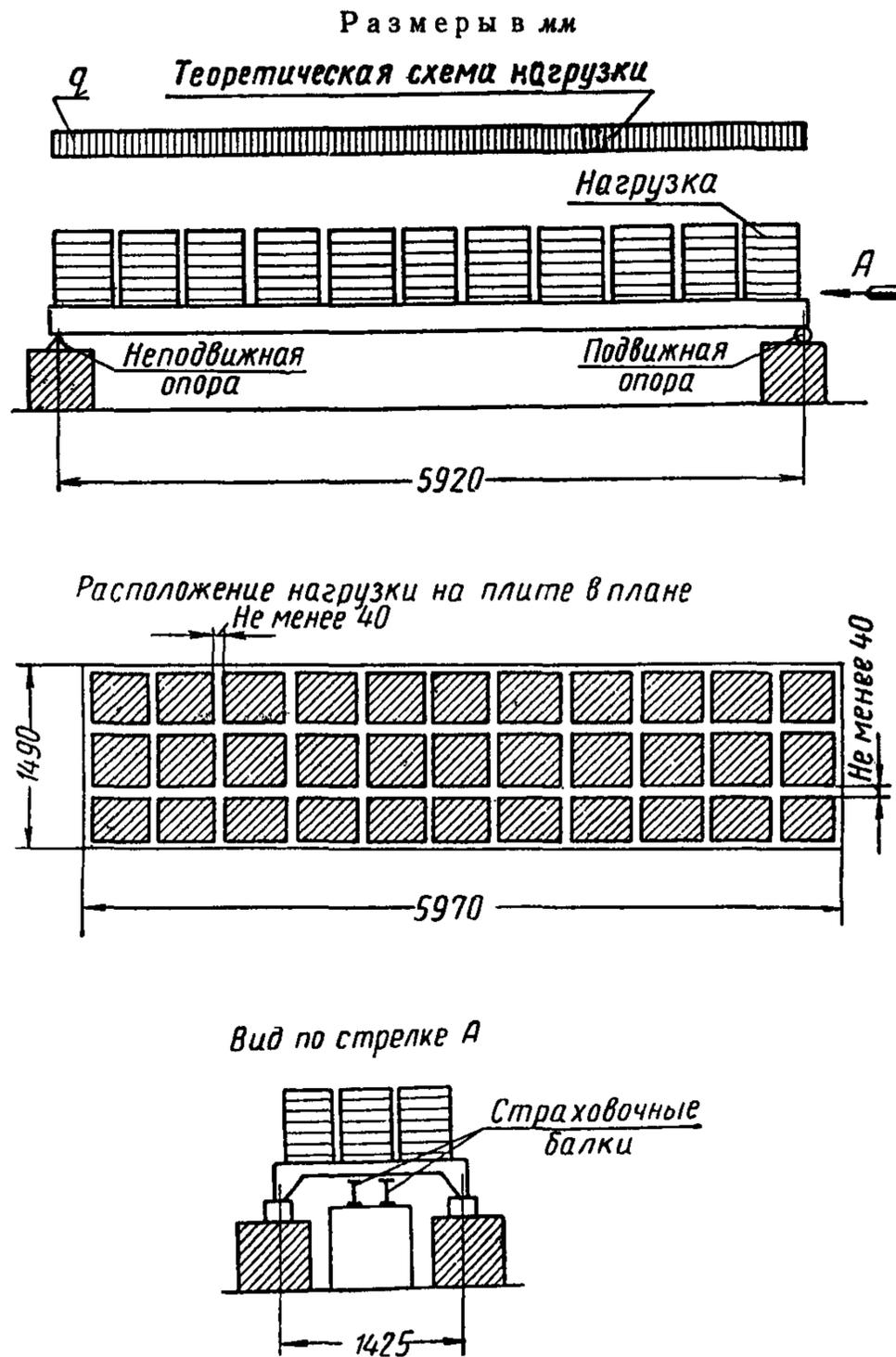
Две опоры на одном конце ребер должны быть шарнирно-неподвижными (ножевыми), а две другие опоры на другом конце — шарнирно-подвижными (на катках). В поперечном направлении все опоры могут быть неподвижными.
