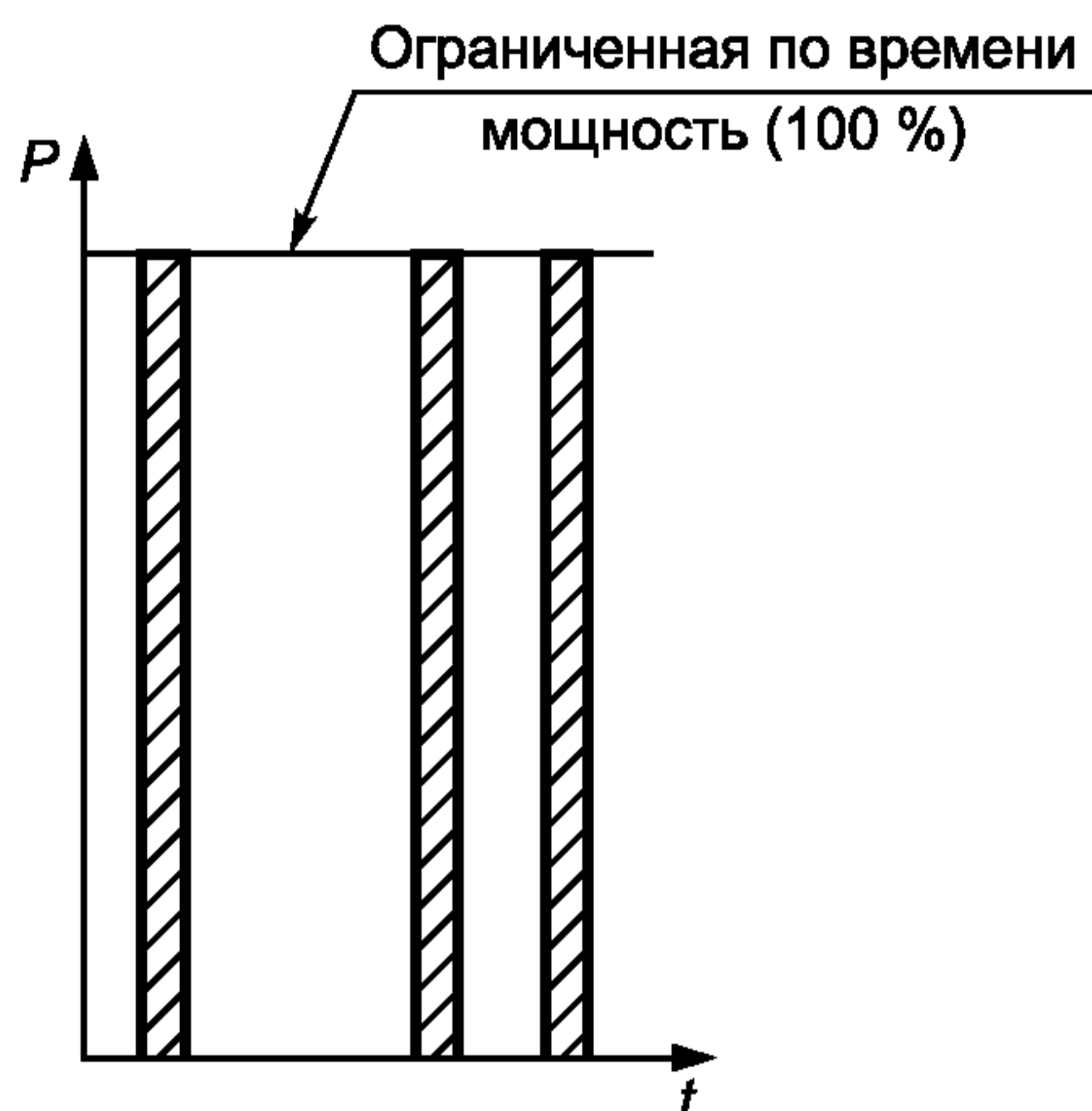
Рисунок 3 — График-иллюстрация ограниченной по времени мощности (LTP)
