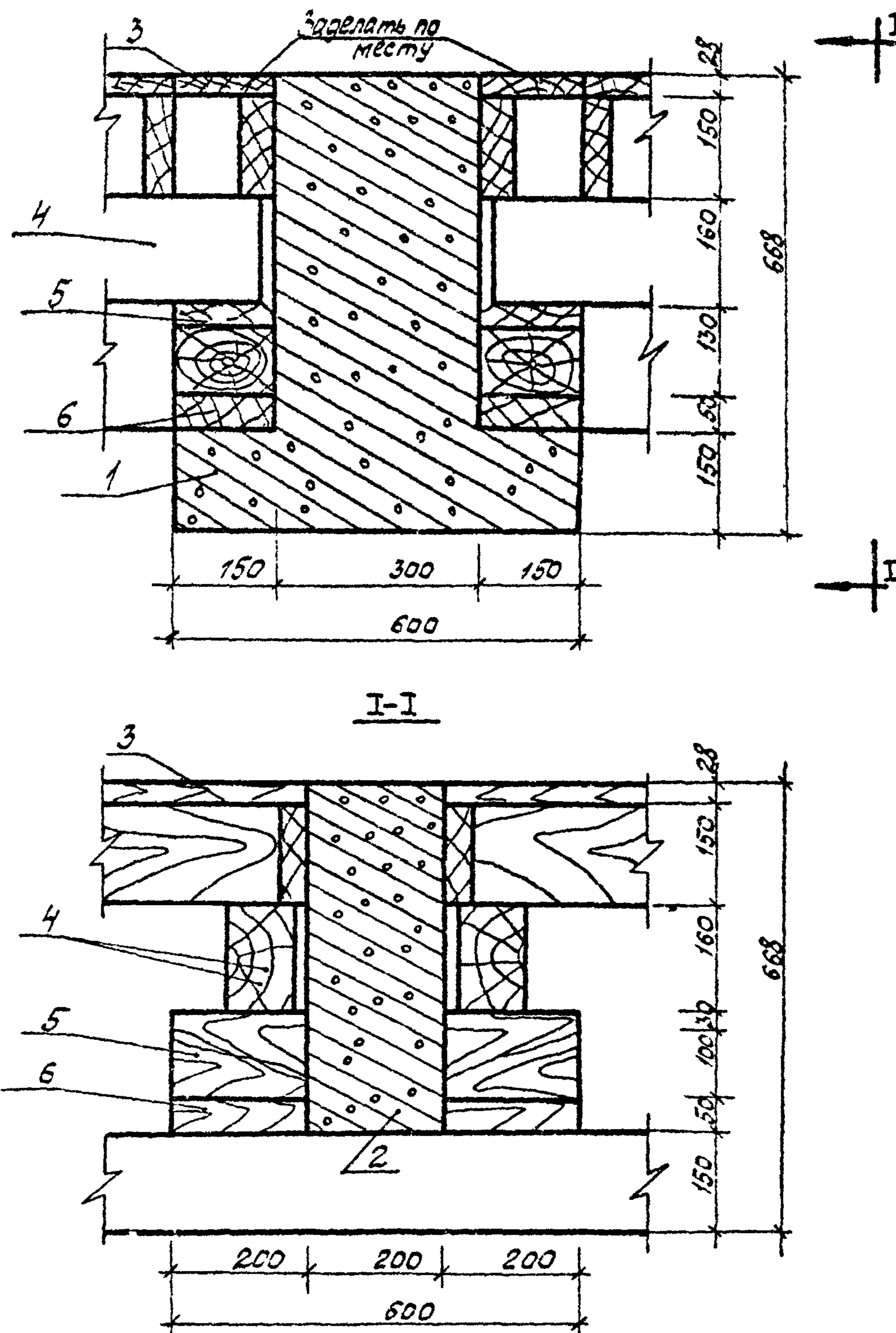
Рис.6 Крепление опалубки у главной балки
