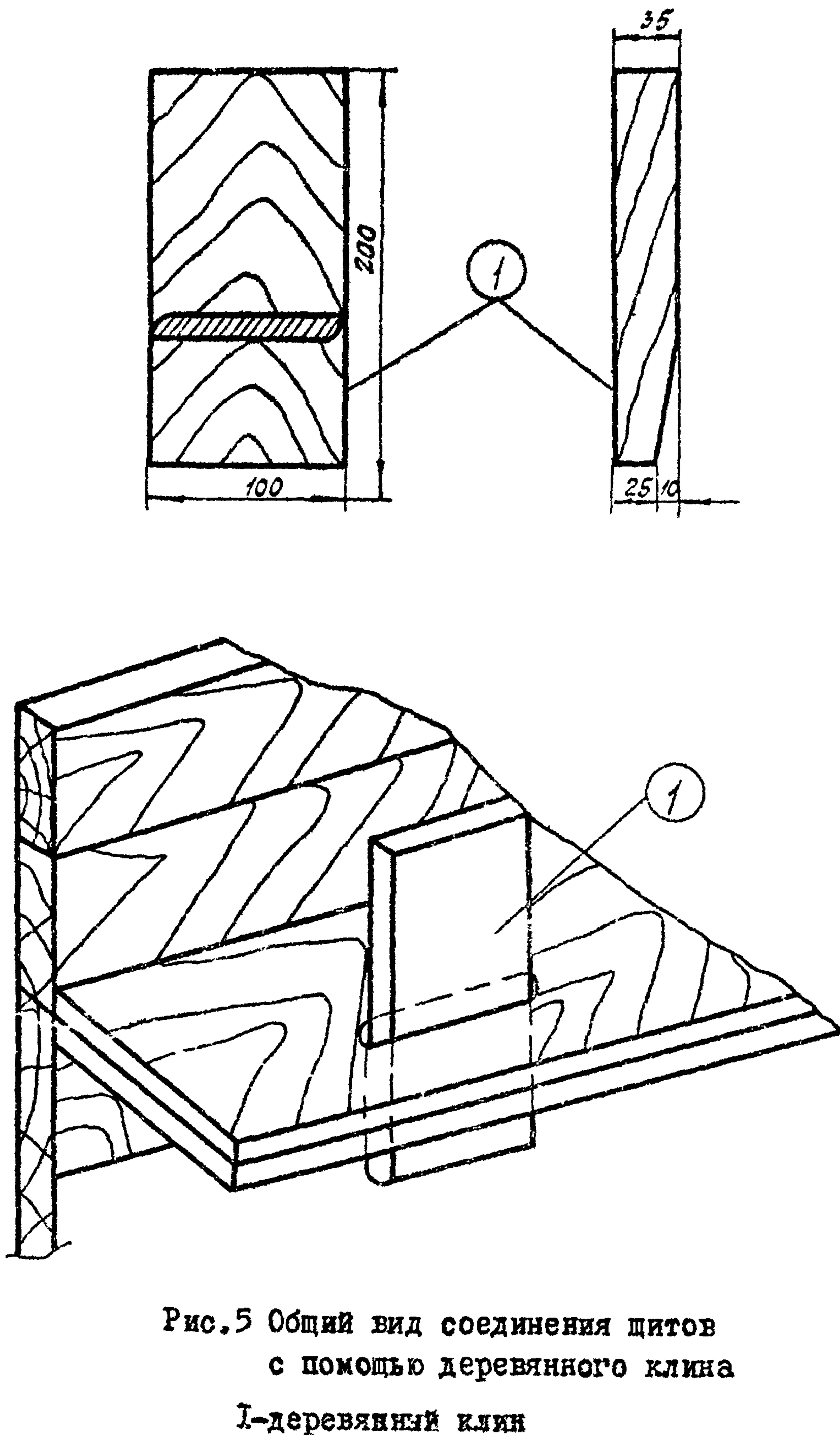
Рис.5 Общий вид соединения щитов
