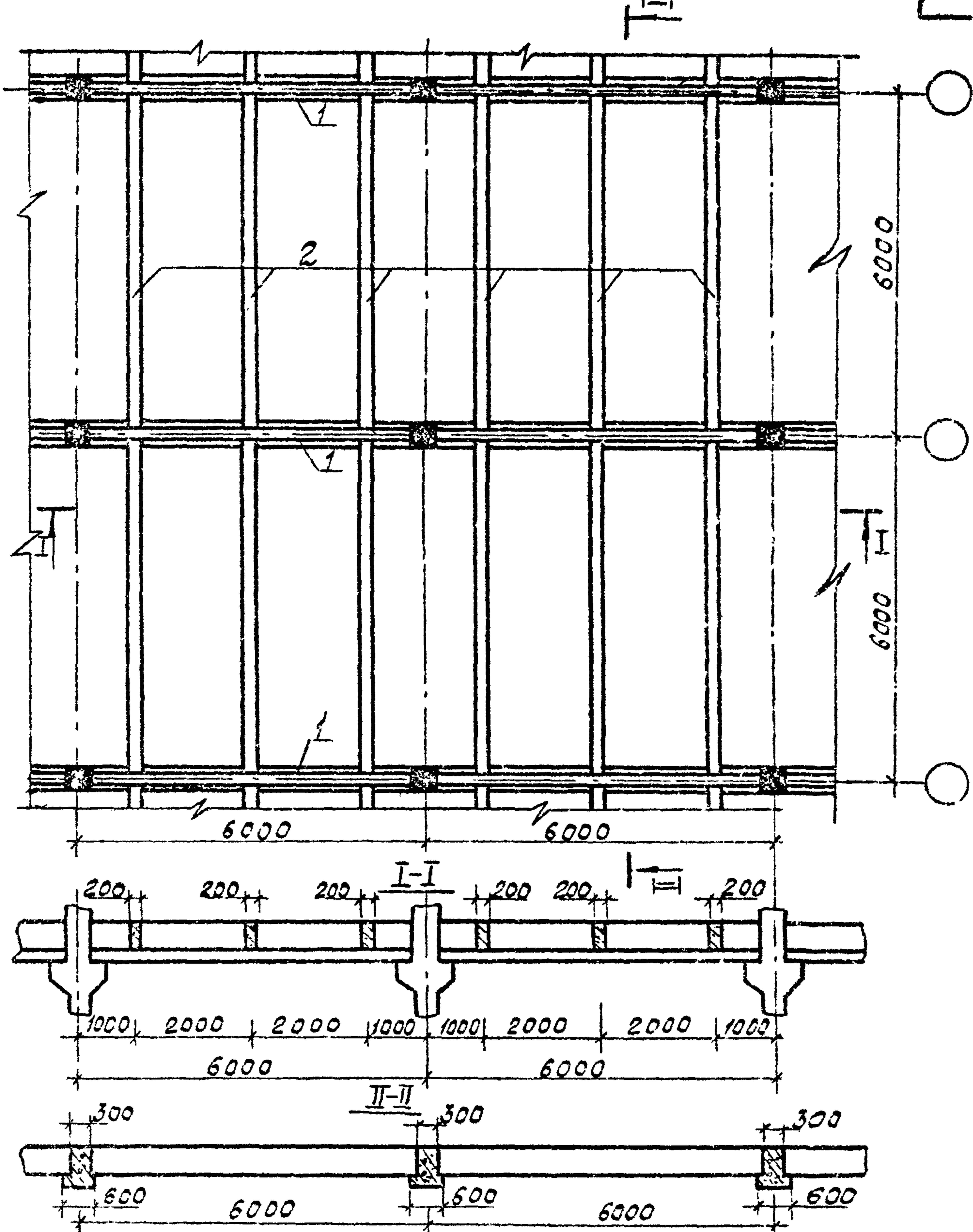
Рис.2 Монтажная схема сборных железобетонных
