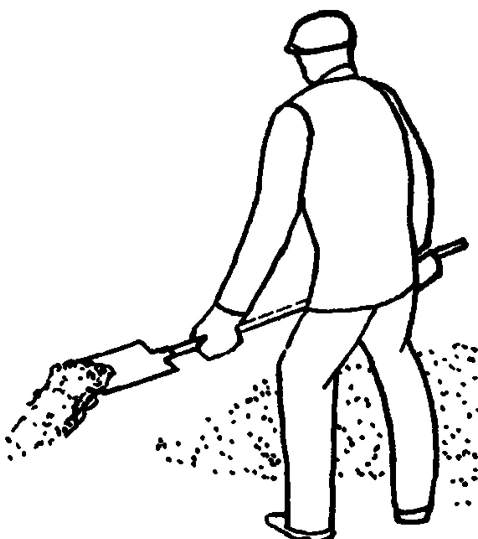
Кровельщики К<sub>2</sub> и К<sub>3</sub> рассыпают песок лопатами ровным слоем на мастику. Затем они отвезут тележки к месту их загрузки
