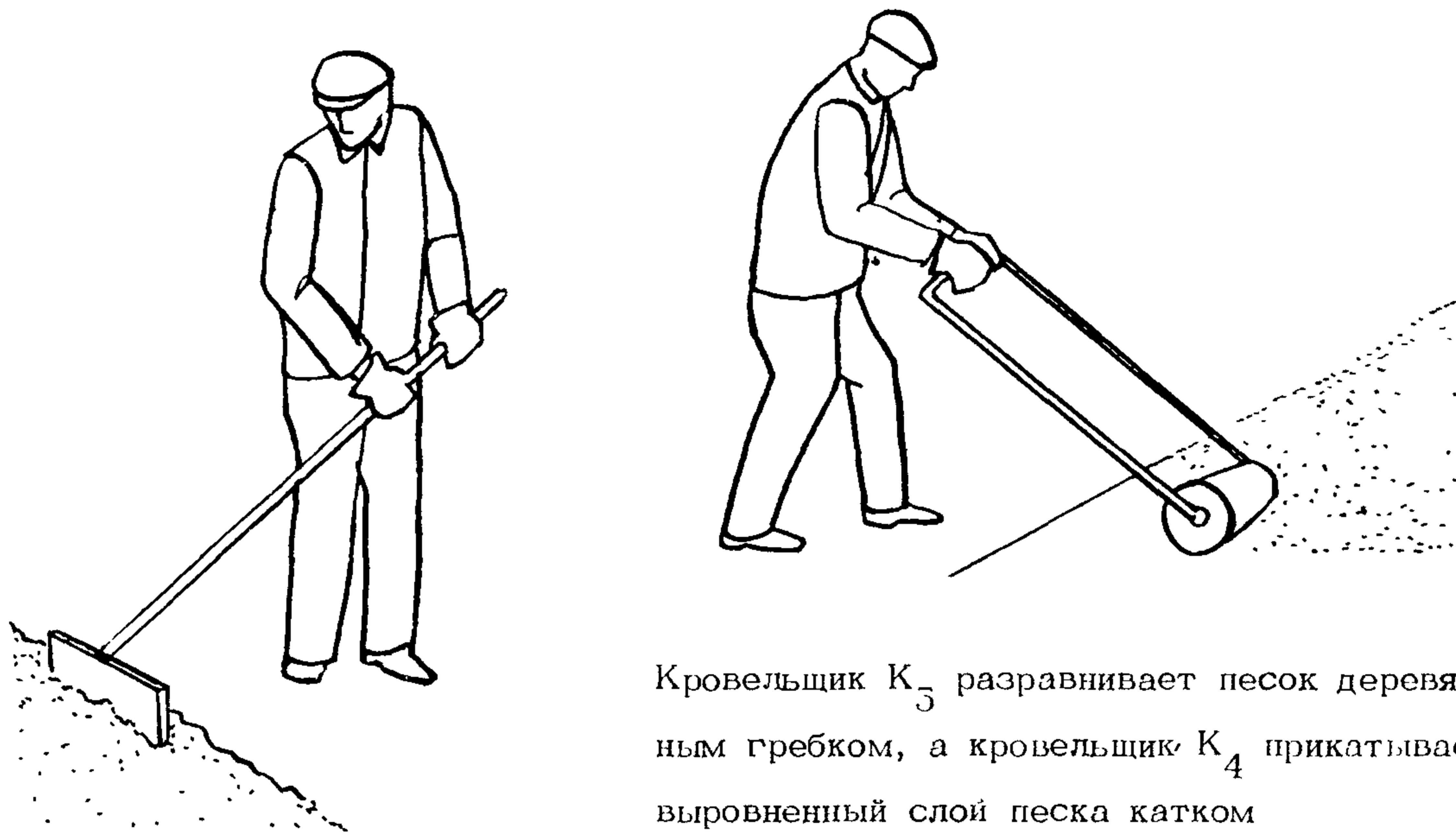
Кровельщик  $K_5$  разравнивает песок деревянным гребком, а кровельщик  $K_4$  прикатывает выровненный слой песка катком
