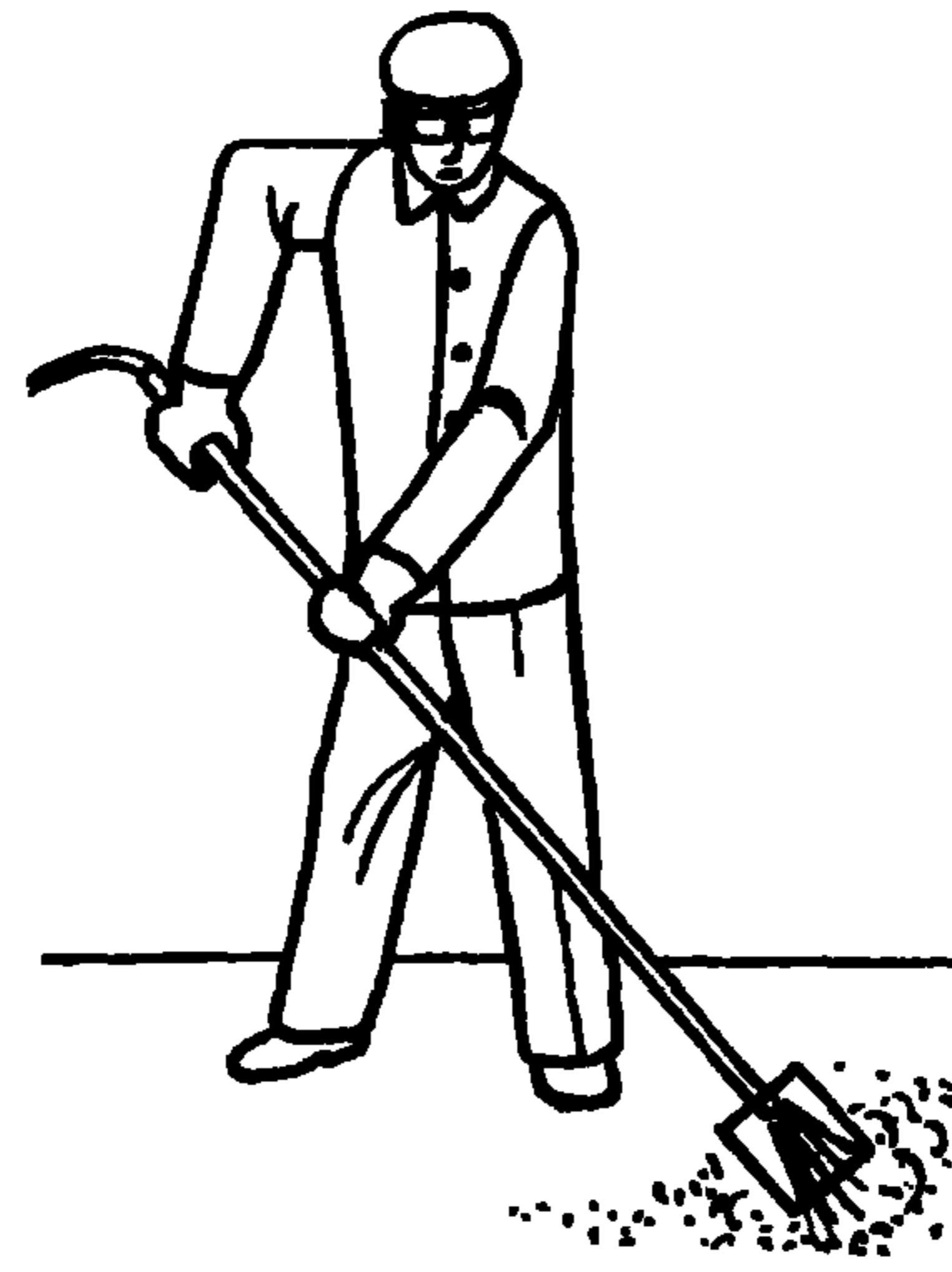
2 ОГРУНТОВКА ОСНОВАНИЯ; 5 мин; К<sub>1</sub>, К<sub>2</sub>; агрегат ГУ-2, компрессор, шланги, узелка
