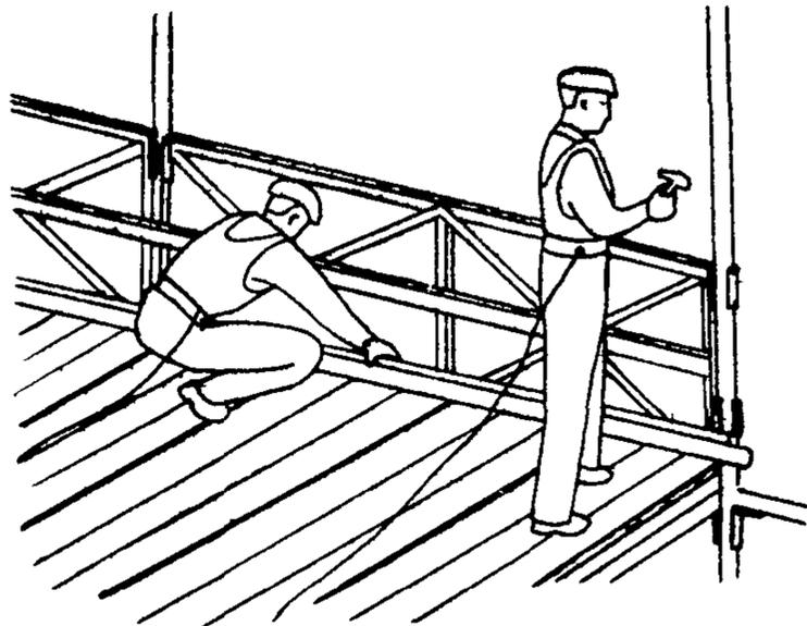
Монтажник  $M_1$  поднимается по лестнице на третий ярус и приступает к установке бортовых досок и перил. Затем туда же поднимается монтажник  $M_2$  и помогает монтажнику  $M_1$ . После установки перил в патрубки стоек их сразу закрепляют с обеих сторон шпильками и проверяют прочность крепления
