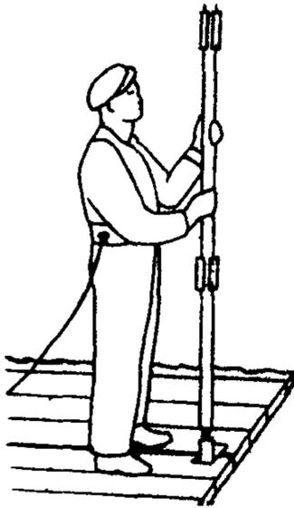
Монтажник  $M_3$  снизу подает принесенную стойку, а монтажник  $M_1$ , находясь на втором ярусе, принимает ее и вставляет в двухметровую стойку внутреннего ряда. Затем он наращивает стойку наружного ряда
