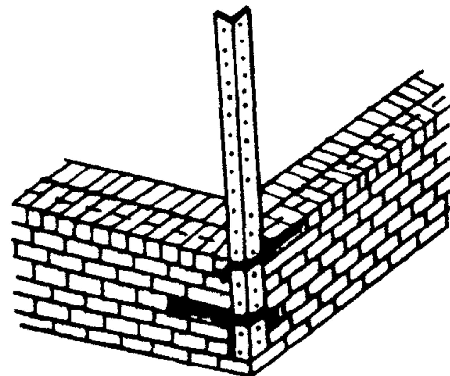
4, 5 ВЫВЕРКА ПОРЯДОВКИ, ЗАКРЕПЛЕНИЕ НА НЕЙ ОТВЕСА И НАТЯГИВАНИЕ ПРИЧАЛЬНОГО ШНУРА; 1,5 мин; К<sub>1</sub>, К<sub>2</sub>; отвес, причальный шнур
