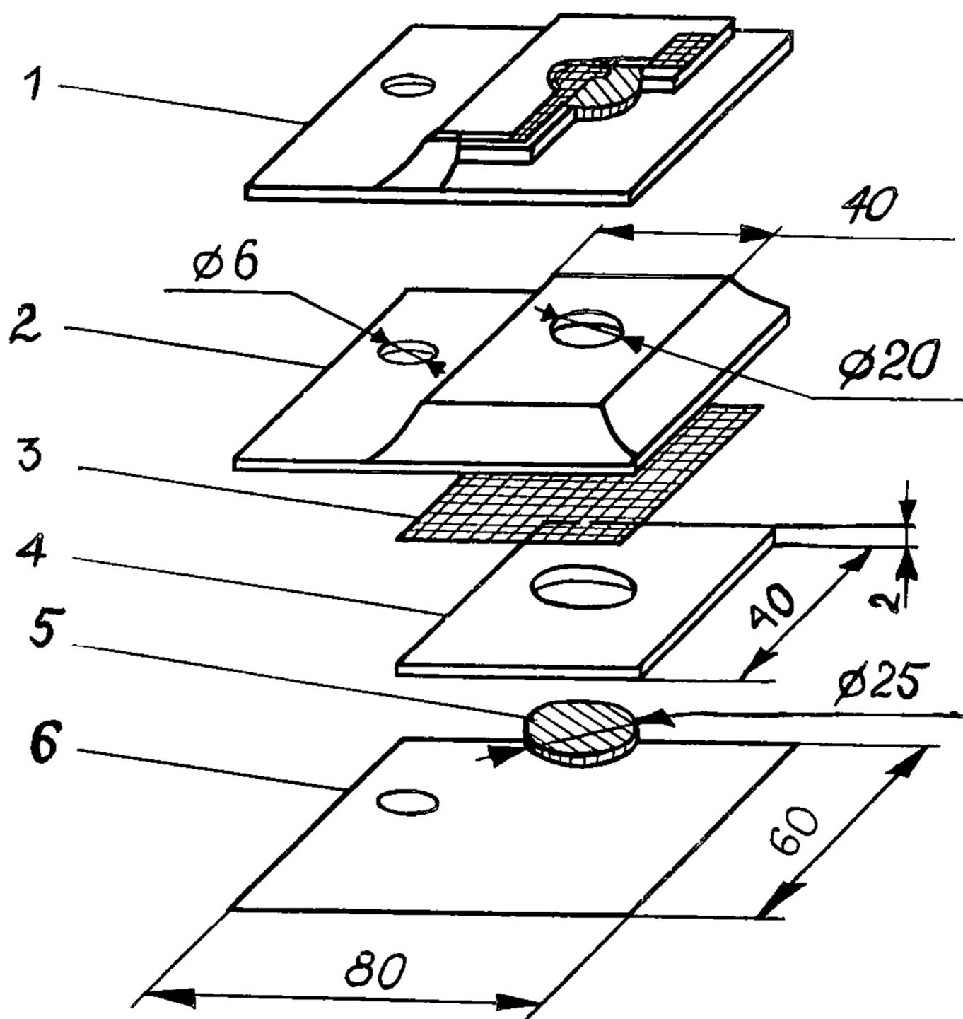
**Рис. 1. Пассивный дозиметр ПД-1**
