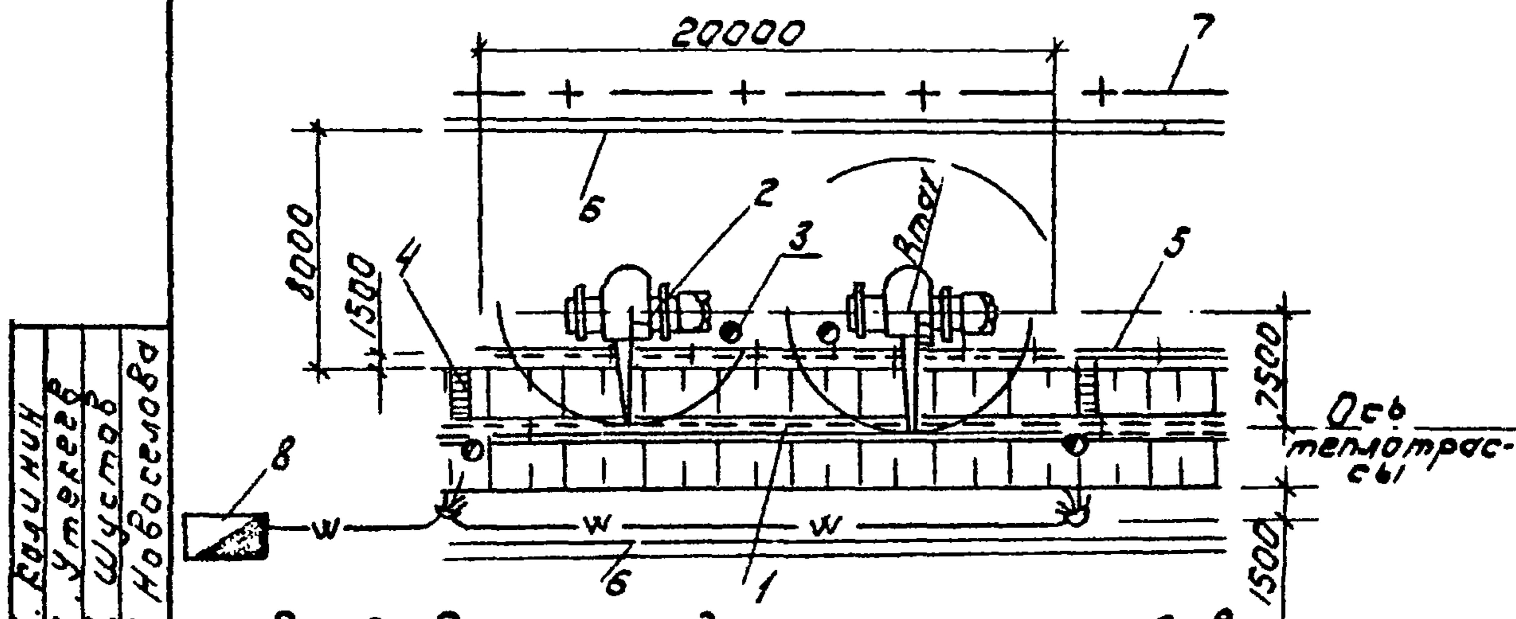
Рис. 3. План укладки стальных труб в траншее
