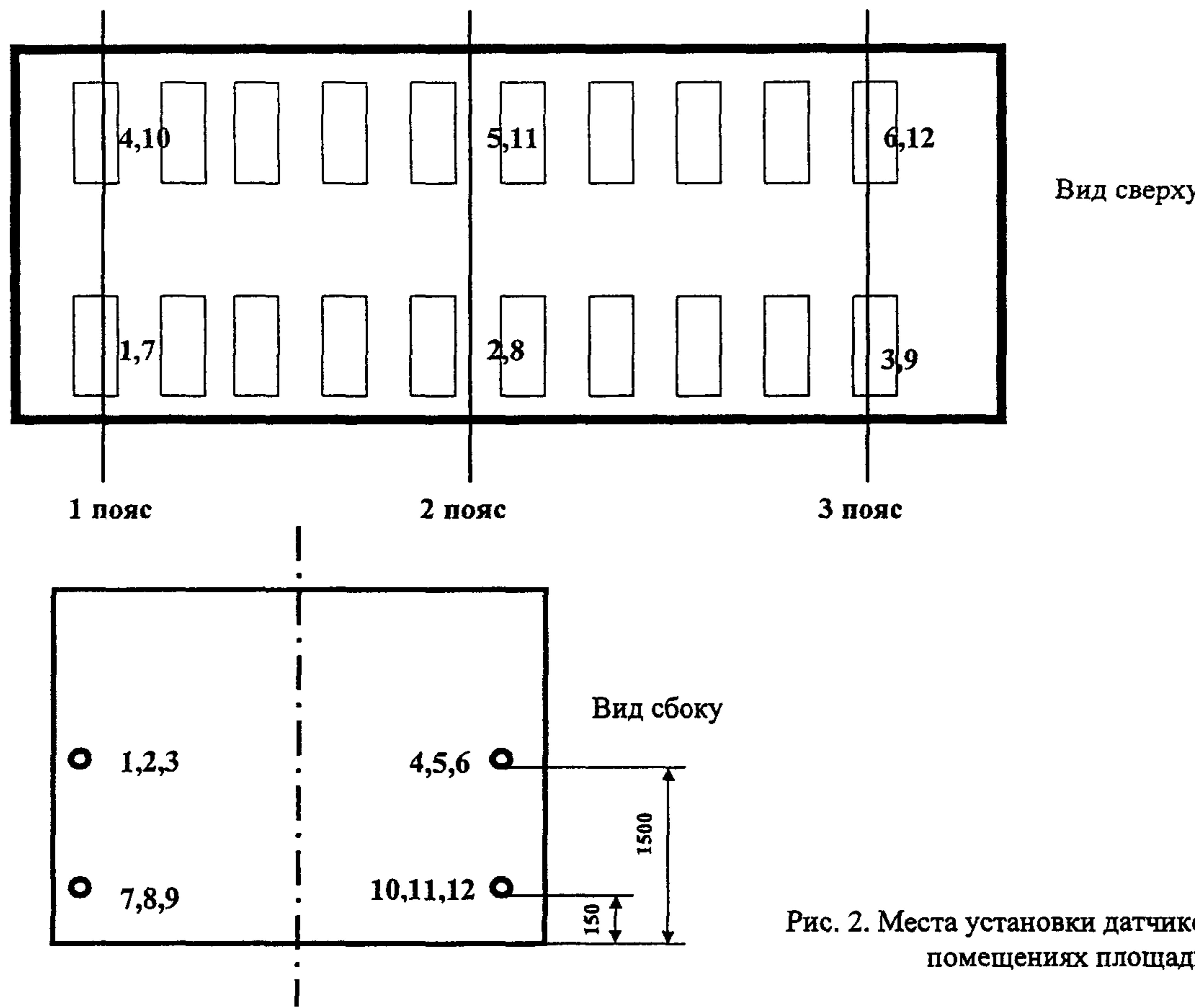
Рис. 2. Места установки датчиков температуры воздуха в помещениях площадью более  $12 \text{ м}^2$
