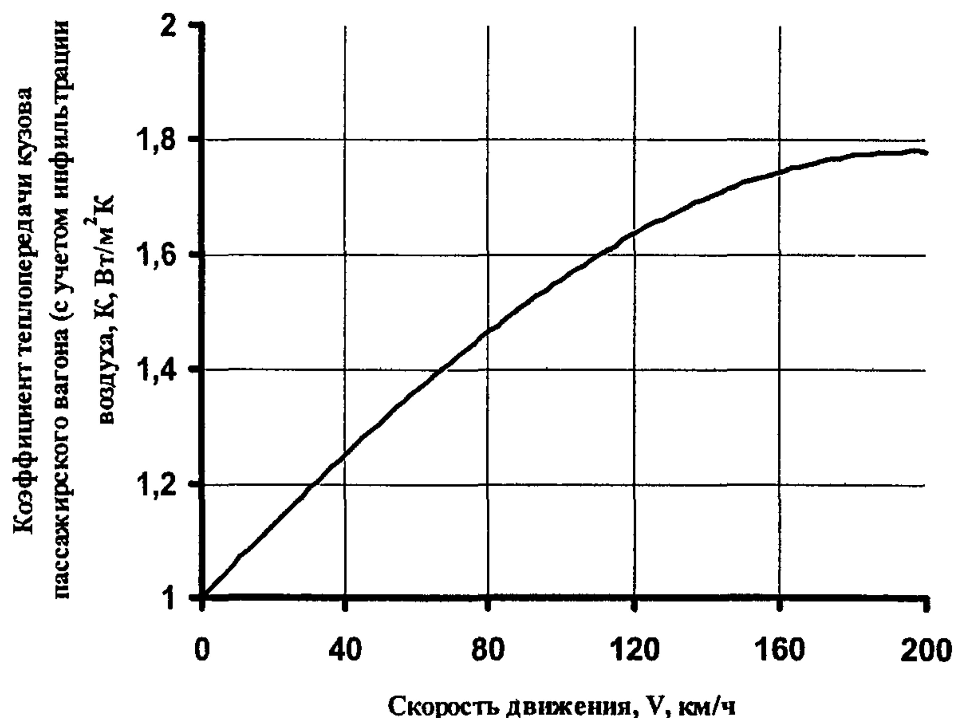
Рис.П.В-1 – Зависимость коэффициента теплопередачи кузова пассажирского вагона (с учетом инфильтрации воздуха) от скорости движения
