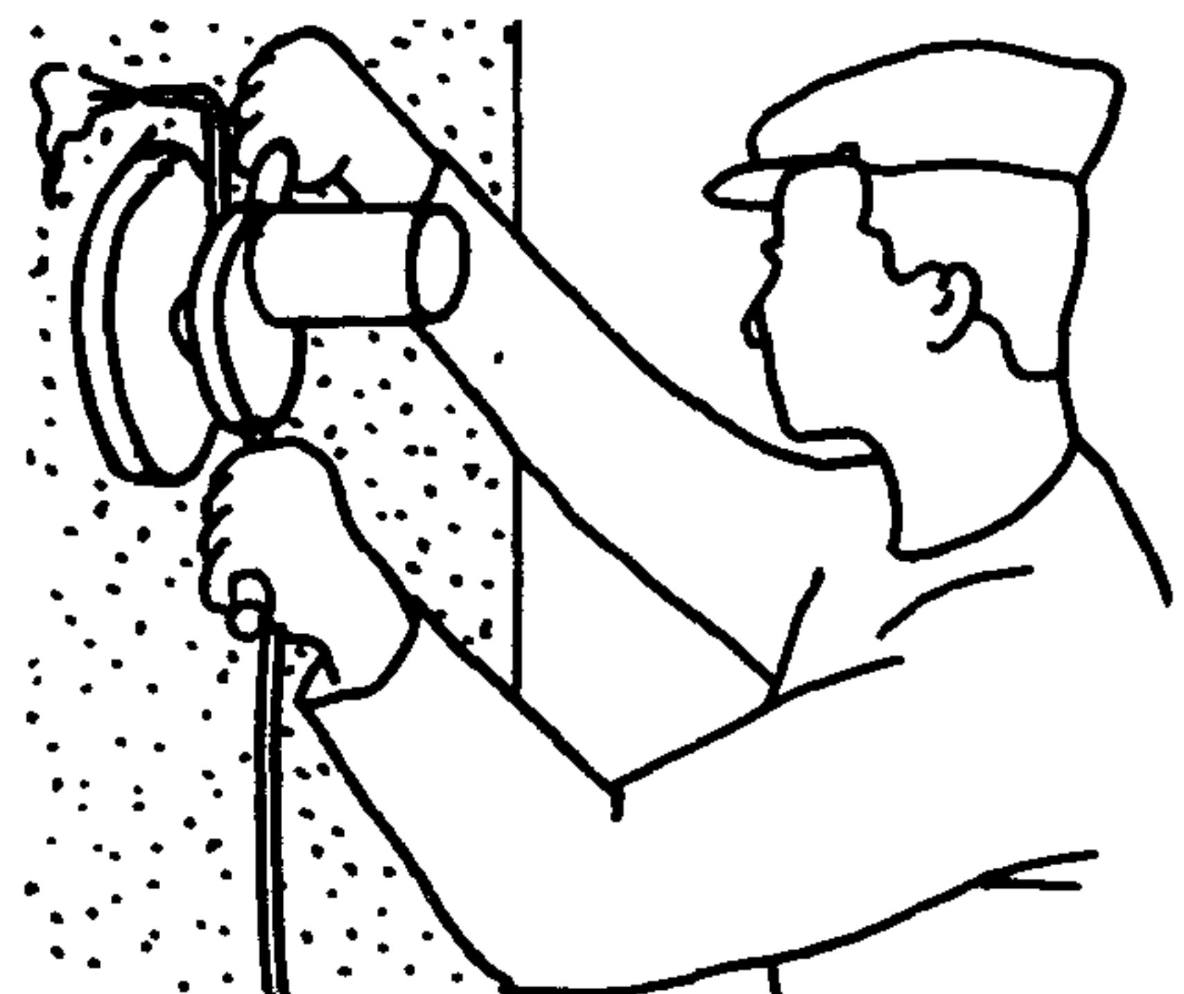
смачивают водой. Подачу воды регулируют клапаном, укрепленным на корпусе затирочной машины. Места недоступные для механизированной затирки затирают вручную круговыми движениями пенопластовой терки. При ручной затирке поверхность увлажняют кистью
