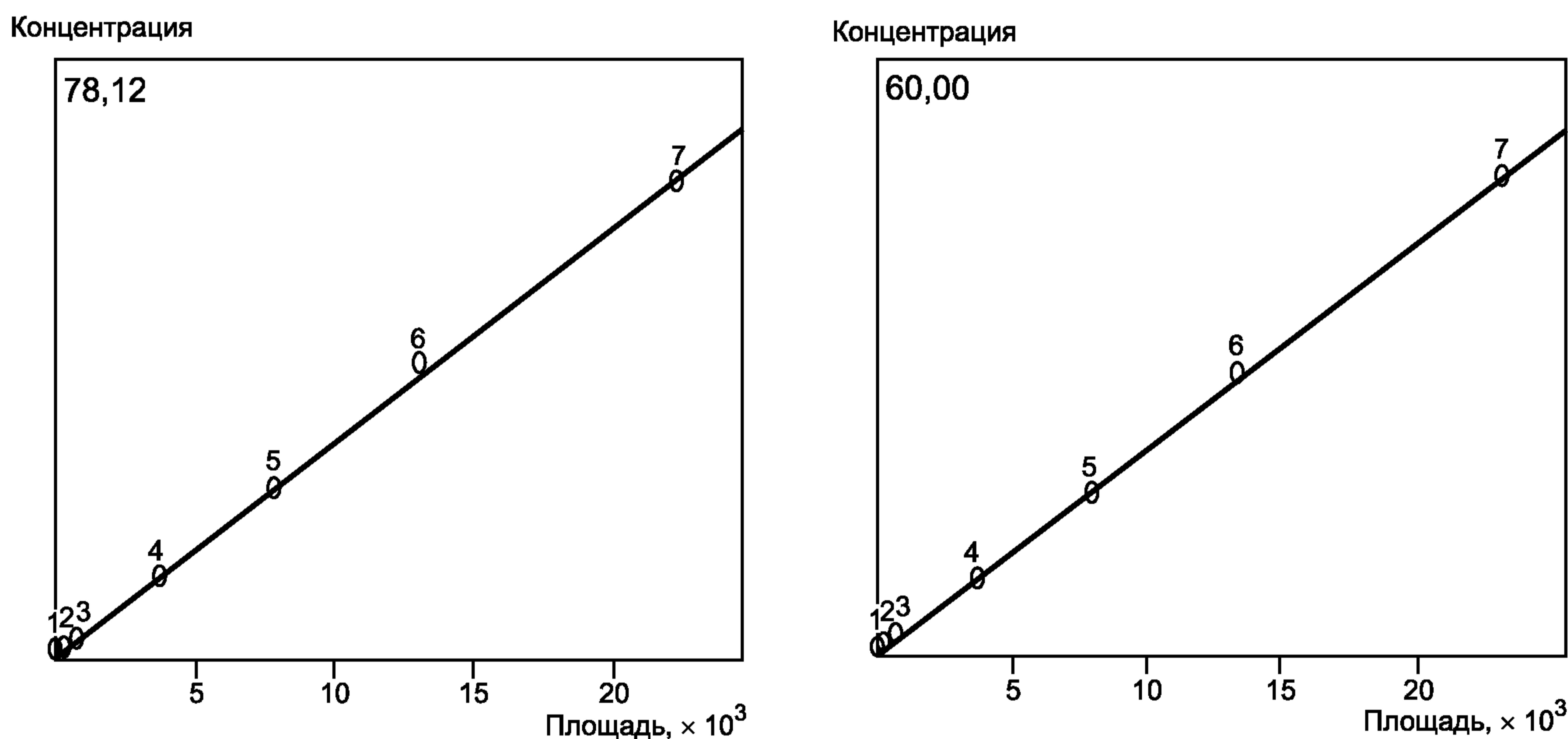
Рисунок 2 — Типичный калибровочный график хлорида
