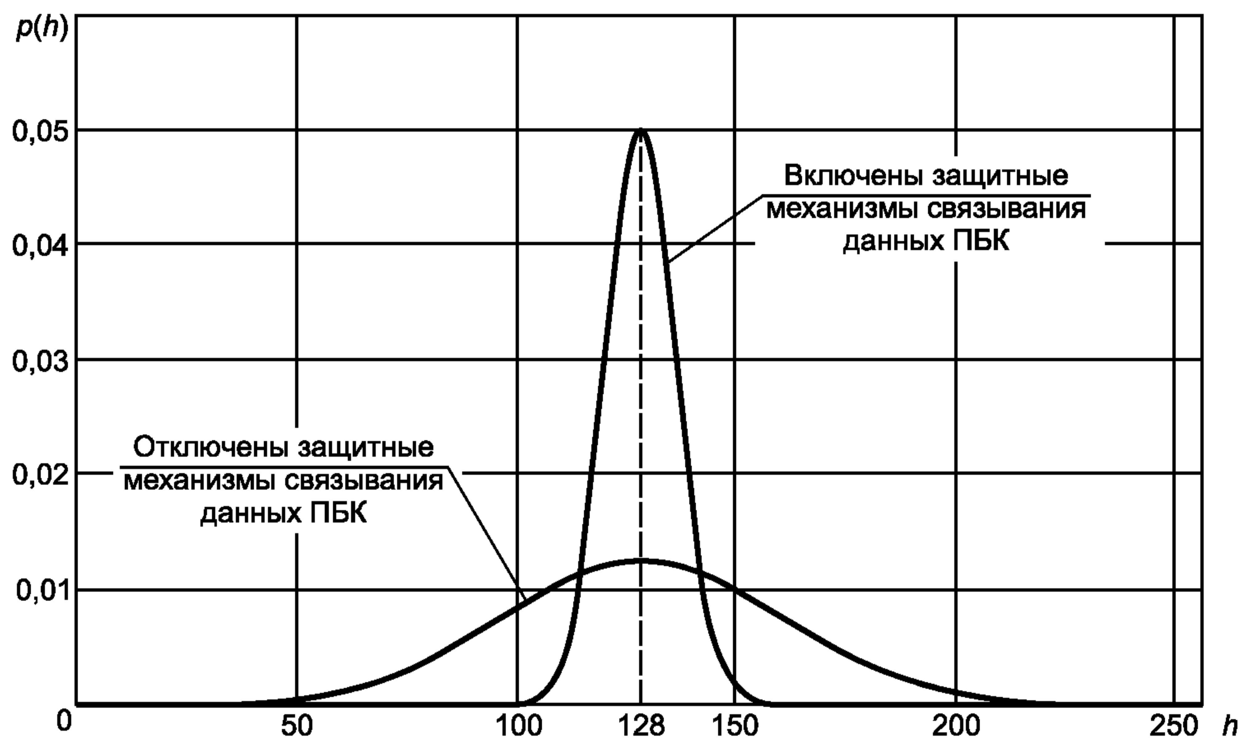
Рисунок В.1 — Две описывающие функции распределения значений критерия Хэмминга при тестировании ПБК с примитивной структурой и защищенным ПБК с 256 выходами
