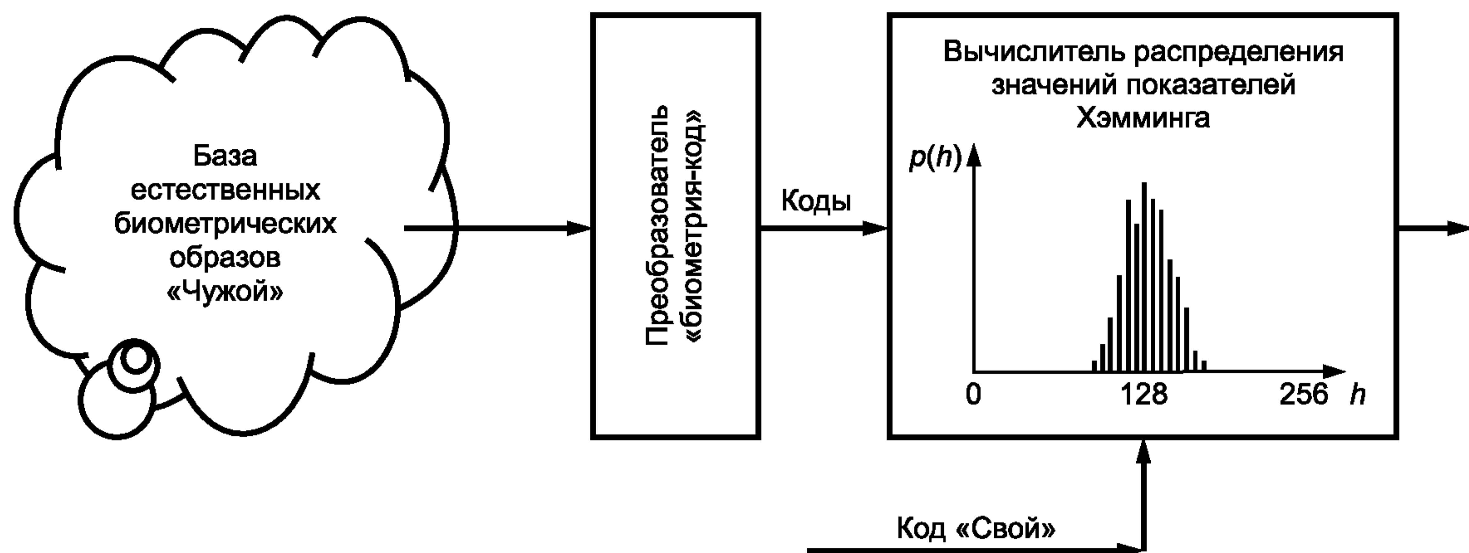
Рисунок 1 — Блок-схема тестирования с использованием базы естественных биометрических образов «Чужой»
